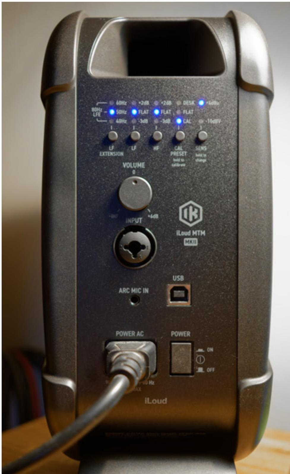
Die in erster Linie für eher ökonomisch und räumlich übersichtlich gehaltene Arbeitsplätze designten iLoud MTM MK II basieren auf einem mit drei Lautsprechermembranen ausgestatteten Zweiwege-System. Für die Klangwiedergabe kommen zwei mittels 70 Watt Class-D-Verstärker angetriebene 3,5“-Tieftöner sowie ein 1“-Silk-Dome-Tweeter mit 30 Watt Versorgung zum Einsatz.
