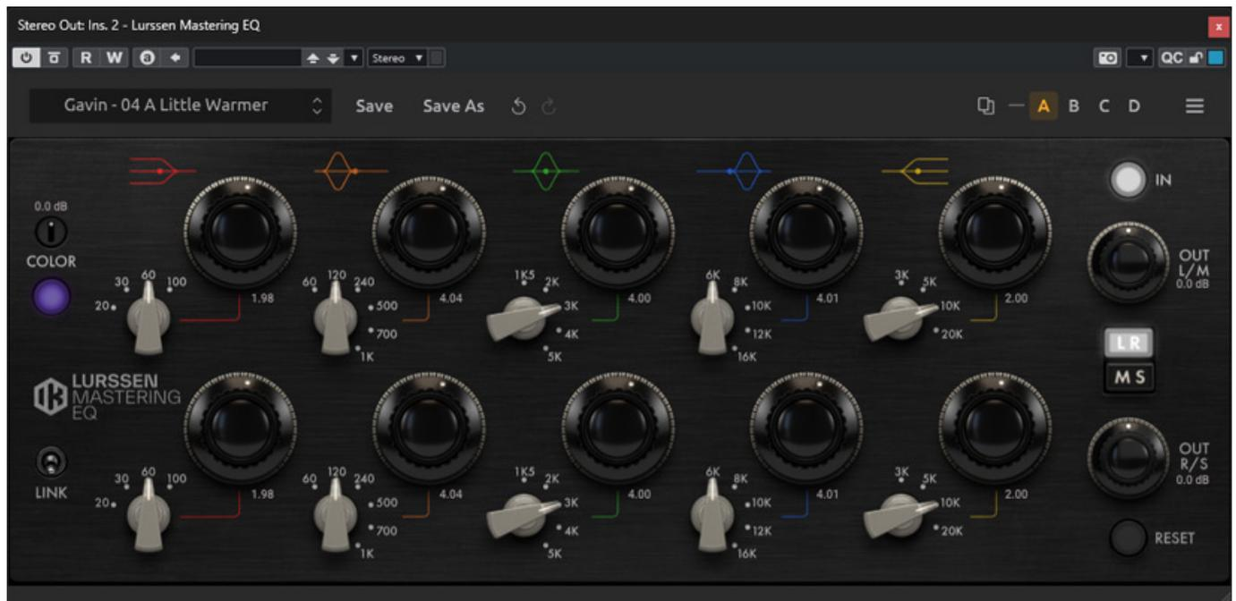
Der Lurssen Mastering EQ bietet die gleichen Filterfrequenzen wie das Original. Der EQ hat ein High- und Low-Shelf-Filter mit jeweils vier anwählbaren Filterfrequenzen sowie drei Bandfilter mit fünf schaltbaren Frequenzen. Der einstellbare Verstärkungsbereich liegt zwischen -34 und +34 dB. Das ist für ein Equalizer schon ein sehr großer Einstellbereich.
