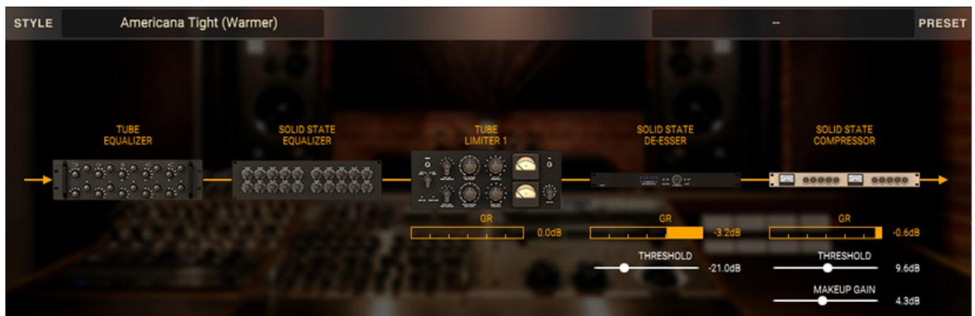
In der Darstellung des Signalpfads mit den einzelnen Prozessoren wie Equalizer, Limiter, De-Esser und Kompressor befinden sich Pegelanzeigen und ggf. auch Parameter die verändert werden können, wie Schwellwerte für De-Esser oder Kompressor und Makeup-Gain.
