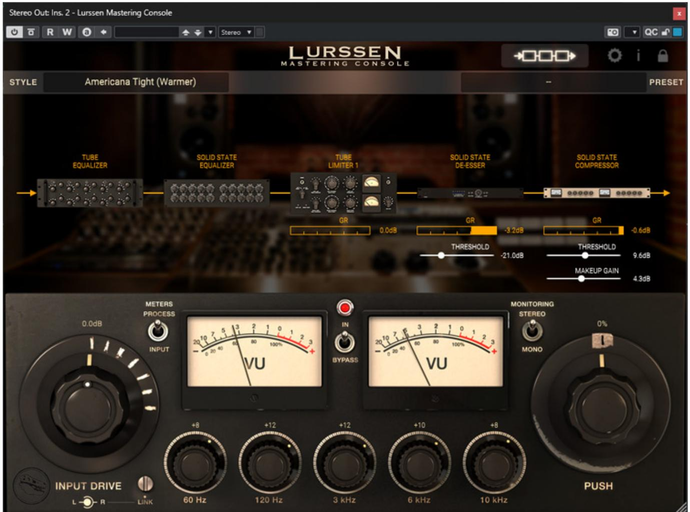
Wenn man auf den Reiter Signalpfad wechselt wird das Konzept der Lurssen Mastering Console deutlich. Im Gegensatz zu der Mastering Console von T-RackS werden hier vorgegebene Prozessor-Anordnungen über Presets geladen, die zum Teil auch schon entsprechend voreingestellt sind.
