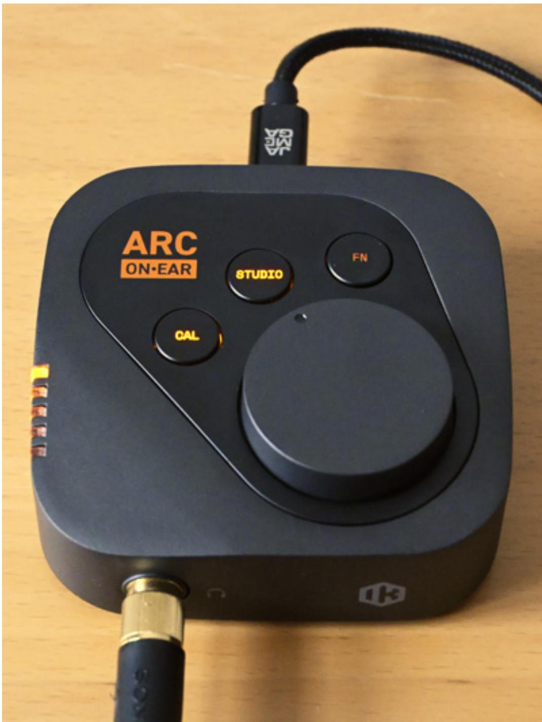
Auf der Oberseite des ARC ON-EAR befindet sich ein großer Regler für den Kopfhörerausgangspegel, Taster für die Aktivierung von Kopfhörer-Kalibrierung und Studiosimulation sowie ein Funktionstaster dessen Funktion sich über die Software definieren lässt. Die Regelung des Ausgangspegels erfolgt im analogen Pfad, so dass es keine Reduzierung der Auflösung gibt.
