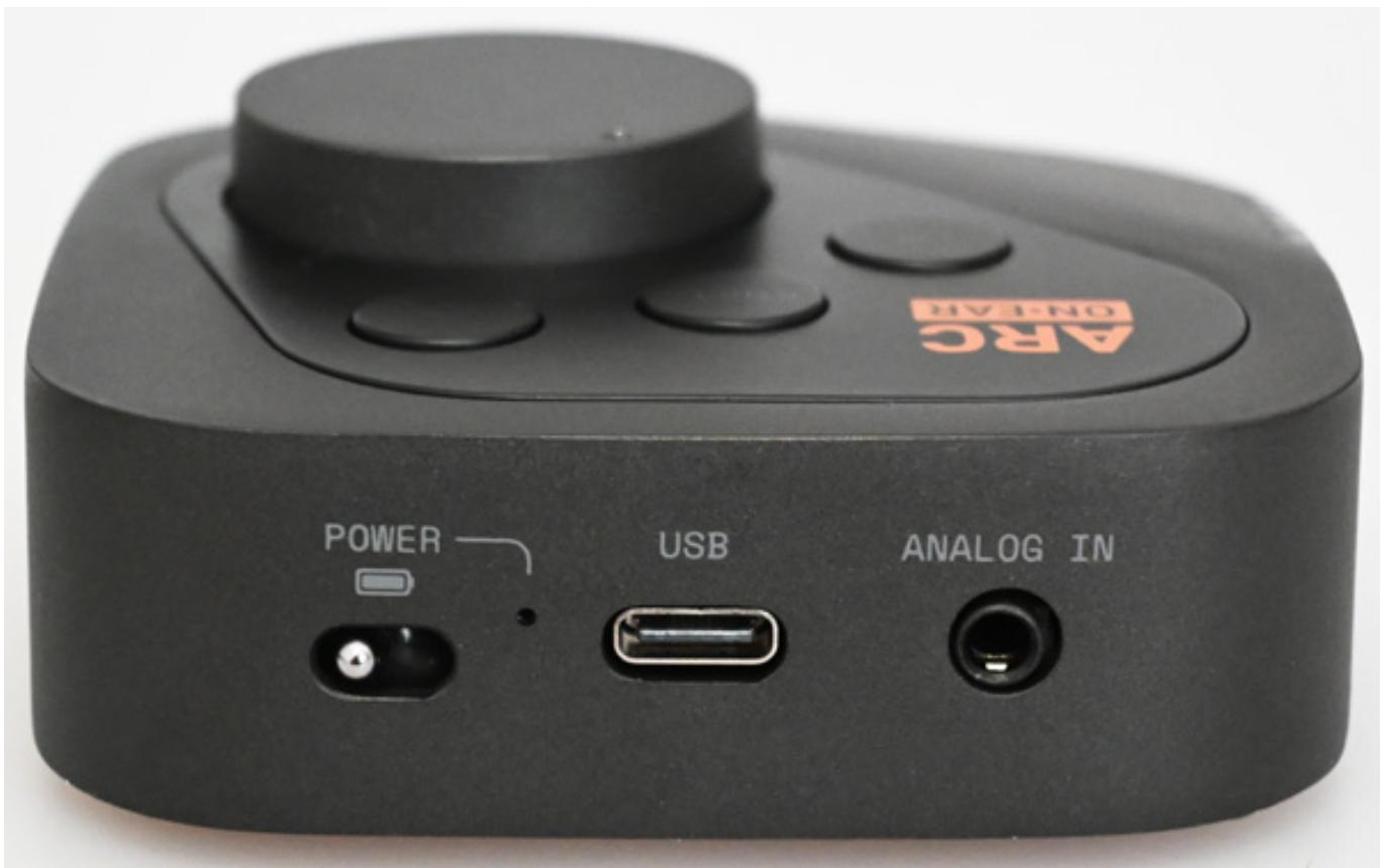
Mit einer Größe von 79 x 77 x 35 mm ist die Hardware extrem kompakt (Gewicht ca. 171 g). Auf der Rückseite befindet sich ein Ein-/Ausschalter, der gut gegen versehentliches Umschalten geschützt ist, eine USB-Buchse sowie eine 3,5-mm-Klinkenbuchse für analoges Audio. Der Kopfhörerverstärker verfügt auch über einen internen Akku, der sich über die USB-Buchse laden lässt. Die Betriebszeit beträgt ca. vier Stunden und hängt natürlich auch von der individuellen Nutzung ab.
