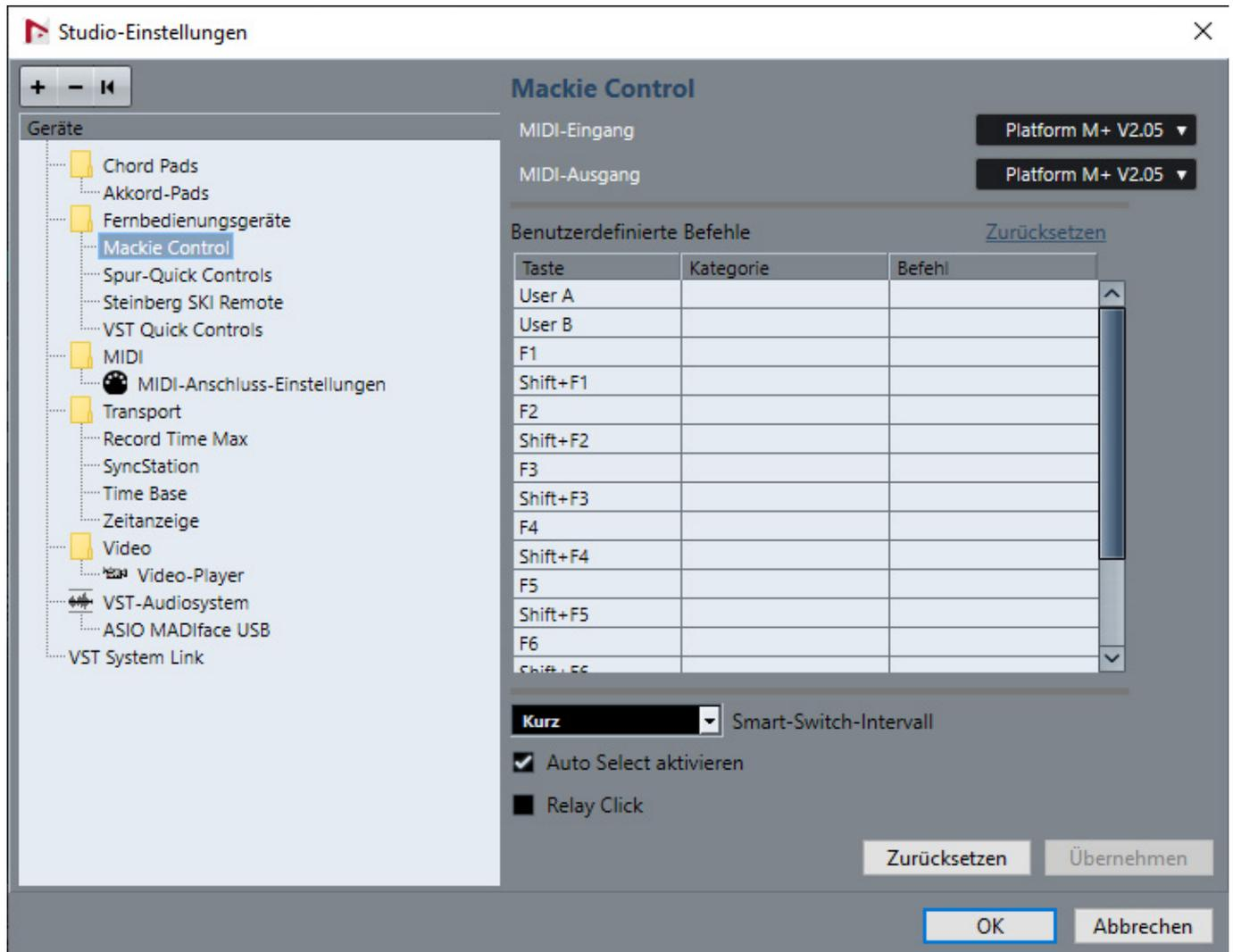
Bei Nuendo oder Cubase ist auch das Protokoll MCP anzuwählen. Die Aktivierung in der DAW-Software erfolgt über das Menü "Studio-Einstellungen" und den Unterpunkt "Fernbedienungsgeräte" in der Geräteliste. Über das kleine Symbol "+" legt man zunächst einen neuen Controller an und zwar mit dem Protokoll "Mackie Control". Bei dem nun anwählbaren Einstelldialog muss man beim MIDI-Ein- und Ausgang jeweils den M+ Controller auswählen und das war es auch schon.
