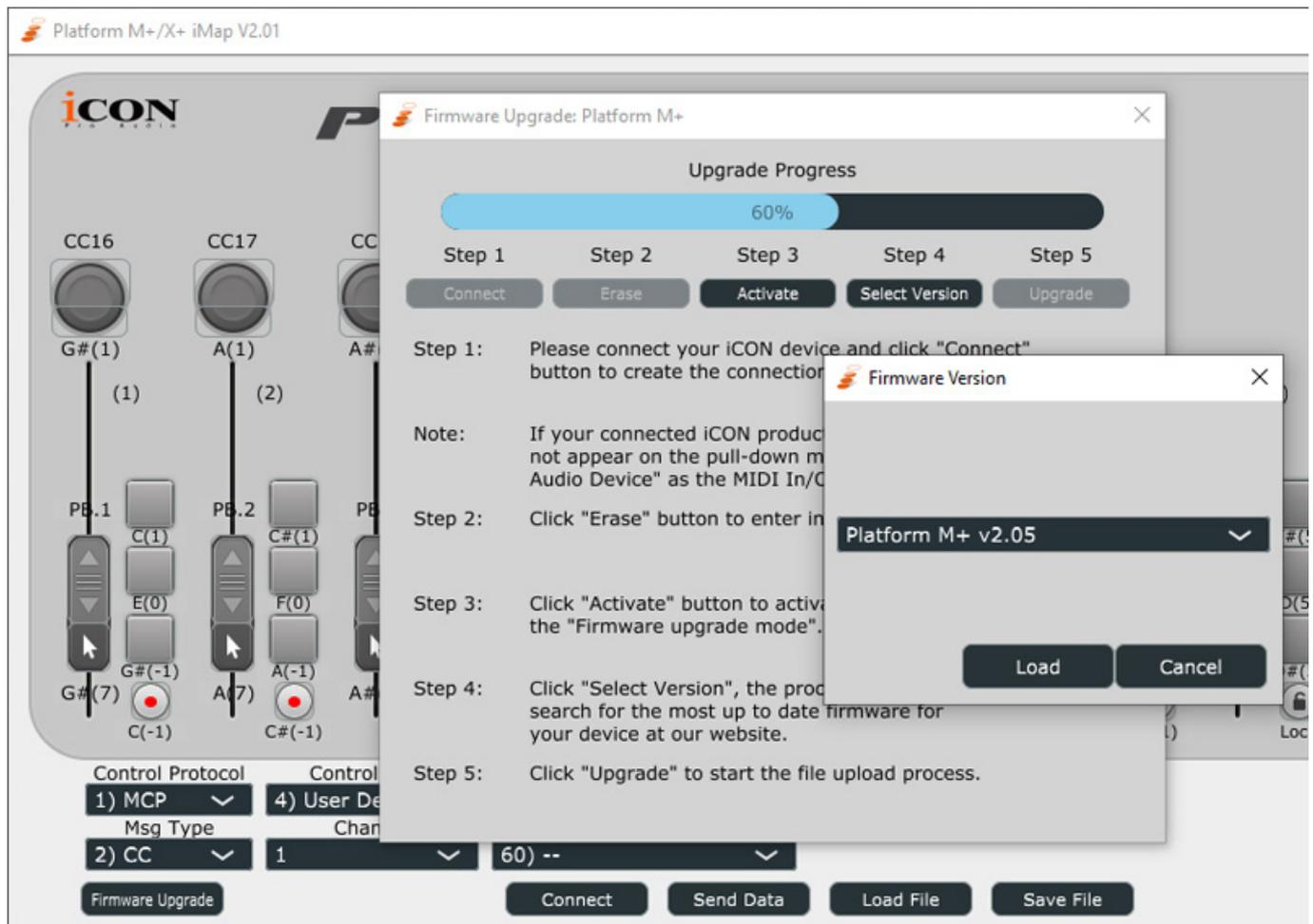
Über die Editoren kann der Anwender auch ein Update der Controller-Firmware durchführen. Dies erfolgt komfortabel in dem man auf "Firmware Upgrade" klickt. Dann sucht die iMap-Software über das Internet nach einer neueren Firmware und bietet diese dann ggf. zum Download an. Mit wenigen Mausklicks lässt sich diese dann in den Controller installieren (s. Abb. oben).
