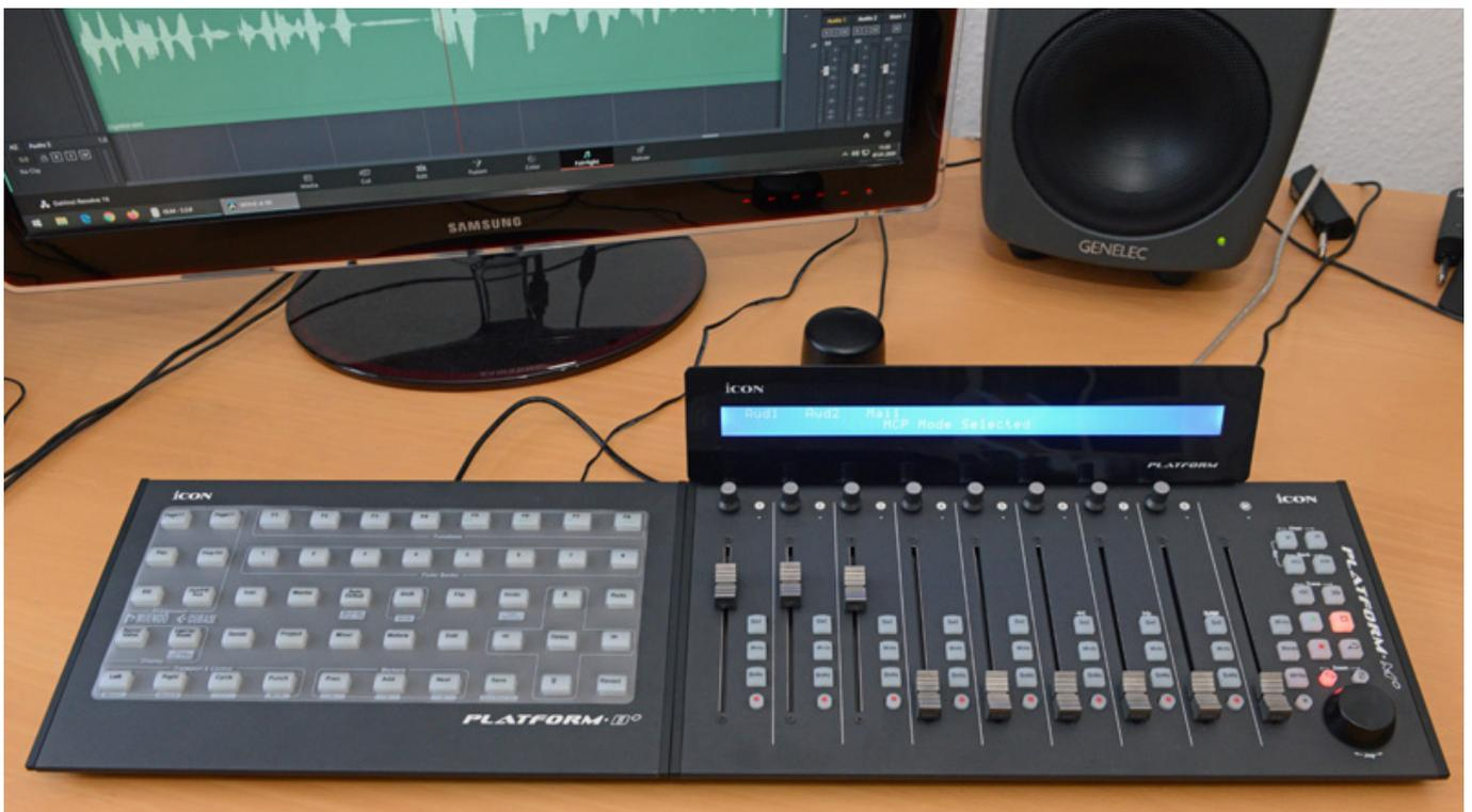
Wichtig ist, dass man beim Betrieb mit mehreren Controllern die Platform B+ und ein Platform X+ Controller als erstes einschaltet und dann den Master Controller Platform M+, der die Peripherie Controller dann auch sicher erkennt und die Detektion der anderen angeschlossenen Platform-Controller ggf. auch im D2-Display anzeigt.
