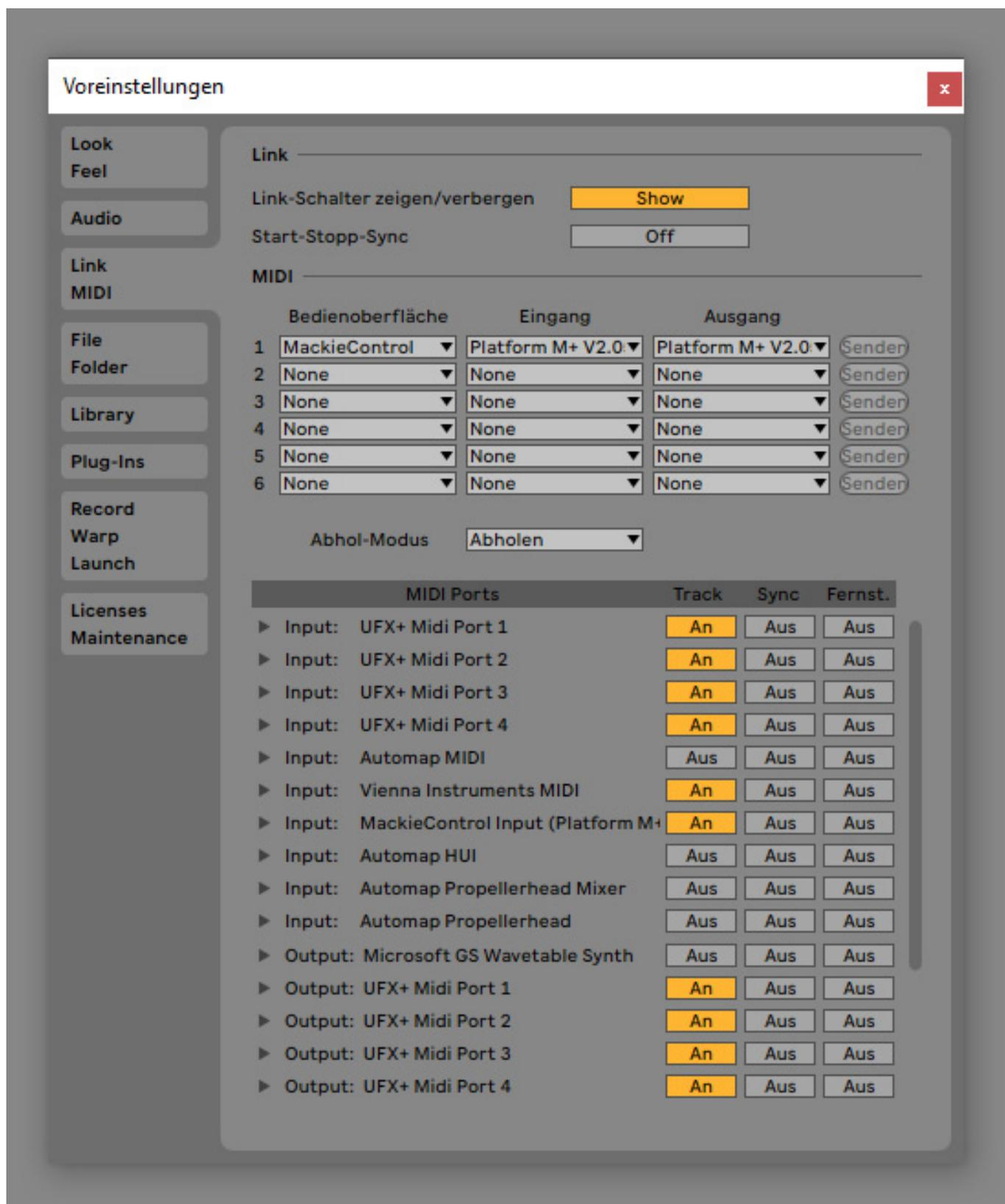
Bei Ableton Live (s. Abb. oben) muss man lediglich unter den "Voreinstellungen" im Reiter "Link MIDI" das Protokoll "MackieControl" unter "Bedienoberfläche" auswählen, sowie den M+ Controller beim Ein- und Ausgang. Am M+ Controller
