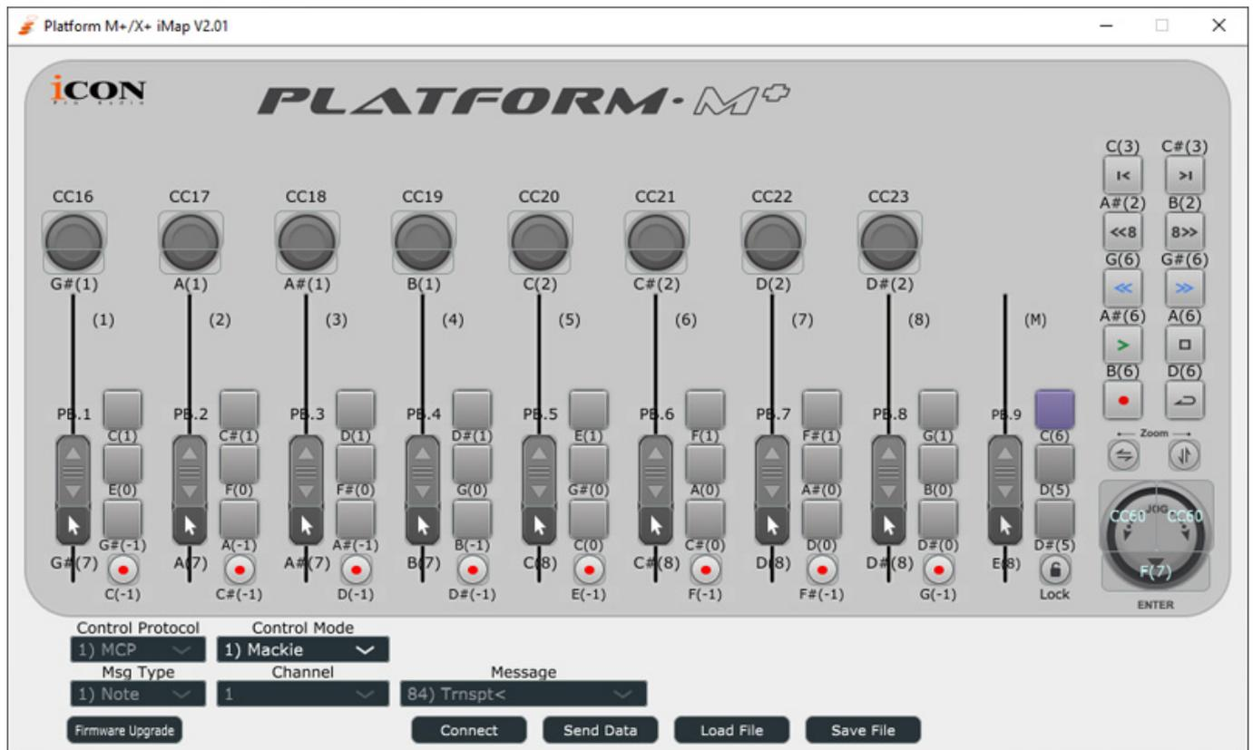
Es gibt über das M+ auch noch die Möglichkeit ein User-Preset zu nutzen. Die individuelle Zuordnung der einzelnen Tasten und Funktionen erfolgt über die iMAP Editor-Software von iCON für den Platform M+ (s. Abb. oben). Die Daten der Anwender-Einstellung bleiben nach dem Übertragen im Platform M+ gespeichert. iMap-Presets lassen sich auch auf der DAW speichern und über die Software wieder in den Controller laden.
