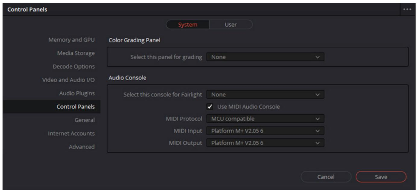
Auch beim weit verbreiteten Videoschnittprogramm Black Magic Davinci Resolve lässt sich der Platform M+ als Controller über die Protokolleinstellung MCP am Platform M+ einsetzen. Im Bereich System-Einstellungen befindet sich hier unter dem Reiter "Control Panels" eine entsprechende Einstellmöglichkeit. Unter "Audio Console" wird bei "MIDI Protocol" MCU ausgewählt und beim MIDI Ein- und Ausgang jeweils der Platform M+ Controller (s. Abb. oben).
