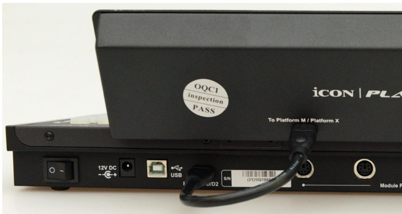
Das Verbindungskabel wird auf der Platform M+ Seite in die mit "D2" bezeichnete Buchse neben der USB-Buchse eingesteckt (s. Abb. oben) und von dort auch mit
