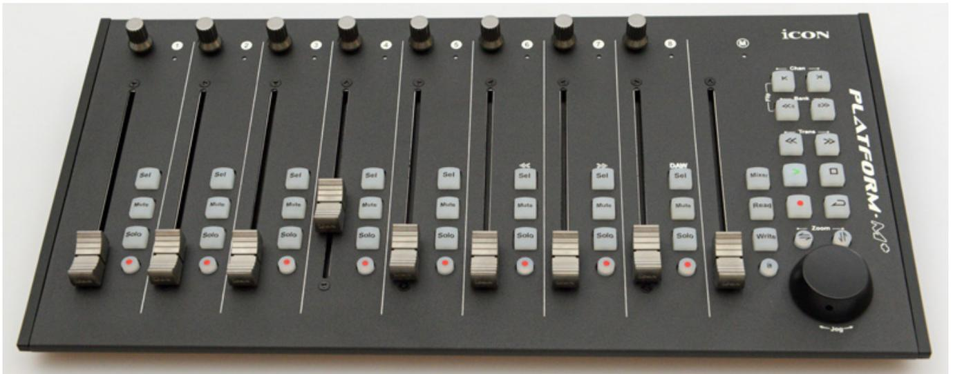
Das Modul bietet acht Kanalzug- und einen Master-Motorfader mit 100 mm Weg, die berührungsempfindlich sind, sowie einer Master-Sektion mit Jog-Wheel und diversen Tasten. Jeder Kanalzug verfügt noch über Drehgeber mit Drucktastenfunktion sowie weitere kanalbezogene Tasten. Dazu später mehr. Die Wegeauflösung bei den Fadern beträgt 10 Bit, also 1.024 Stufen.
