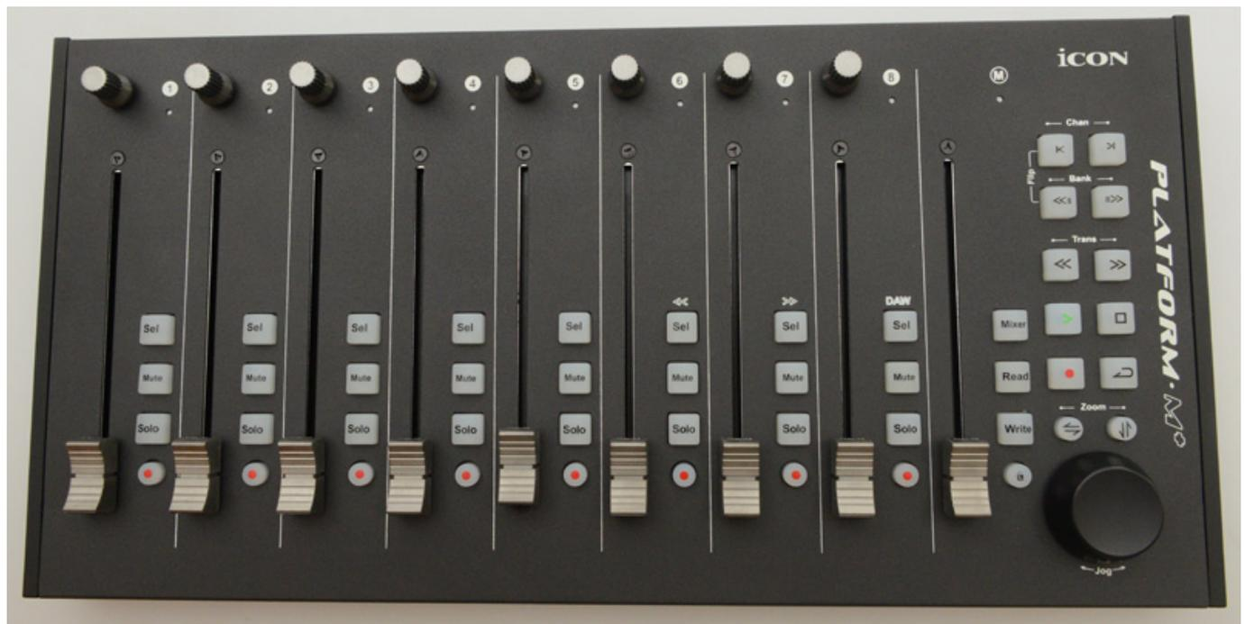
Nun etwas detaillierter zur Bedienung am Platform M+. Das Gesagte gilt selbstverständlich auch für die optionale Erweiterung X+. Die Drehgeber haben in der Regel Panorama-Funktion. Pro Kanal gibt es die über Tasten neben dem Fader die Möglichkeit der Kanalselektion, Stummschaltung, Solo-Abhörfunktion sowie Aufnahmebereitschaft.
