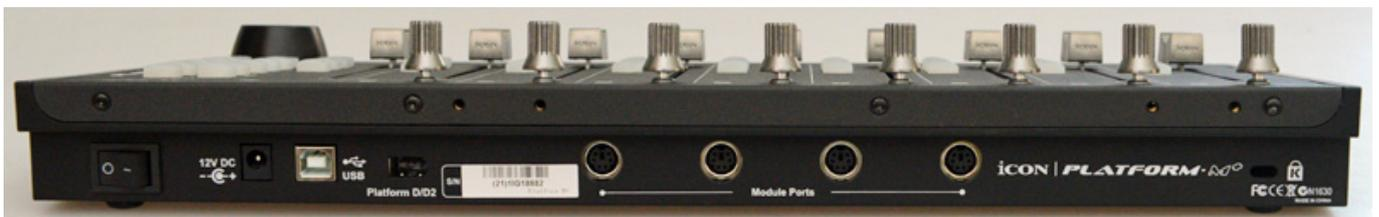
Werfen wir einen Blick auf die Rückseite des iCON Platform M+. Das Gerät lässt sich über einen Schalter Ein- und Ausschalten und es verfügt einen USB-Anschluss für die Verbindung zum Host-Rechner. Weiter lassen sich bis zu vier weitere Module über Mini-DIN-Buchsen anschließen. So lässt sich das System mit dem Modul "Platform X+" um acht Kanalzüge erweitern und ist ein Extender zum Platform M+. Daher verfügt das Platform X+ auch über keine Master-Sektion.
