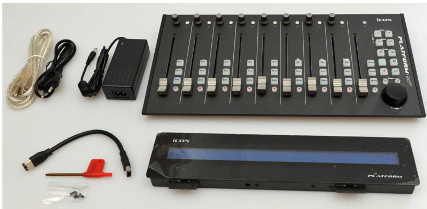
Geliefert wird das Platform M+ mit einem Netzteil und USB-Kabel. Eine ideale Ergänzung zum iCON "Platform M+" stellt das optionale Display "Platform D2" dar. Dieses Modul wird über vier Schrauben an dem Platform M+ befestigt. Ein entsprechender Schraubendreher und ein Verbindungskabel zum Platform M+ liegen dem Platform D2 bei.
