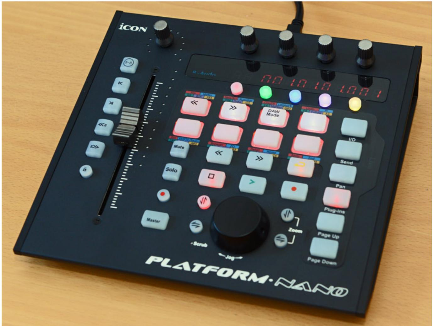
Der Motorfader des Controllers hat einen Weg von 100 mm und wird mit einer Auflösung von zehn Bit angesteuert und verfügt über eine Fader-Touch-Detektion, wie man das von Mischpulten her kennt. Über dem Fader ist ein zentraler Drehgeber (mit Rasterung) mit Drucktastenfunktion und über dem Display befinden sich weitere vier Drehgeber (auch gerastert) mit Drucktastenfunktion.
