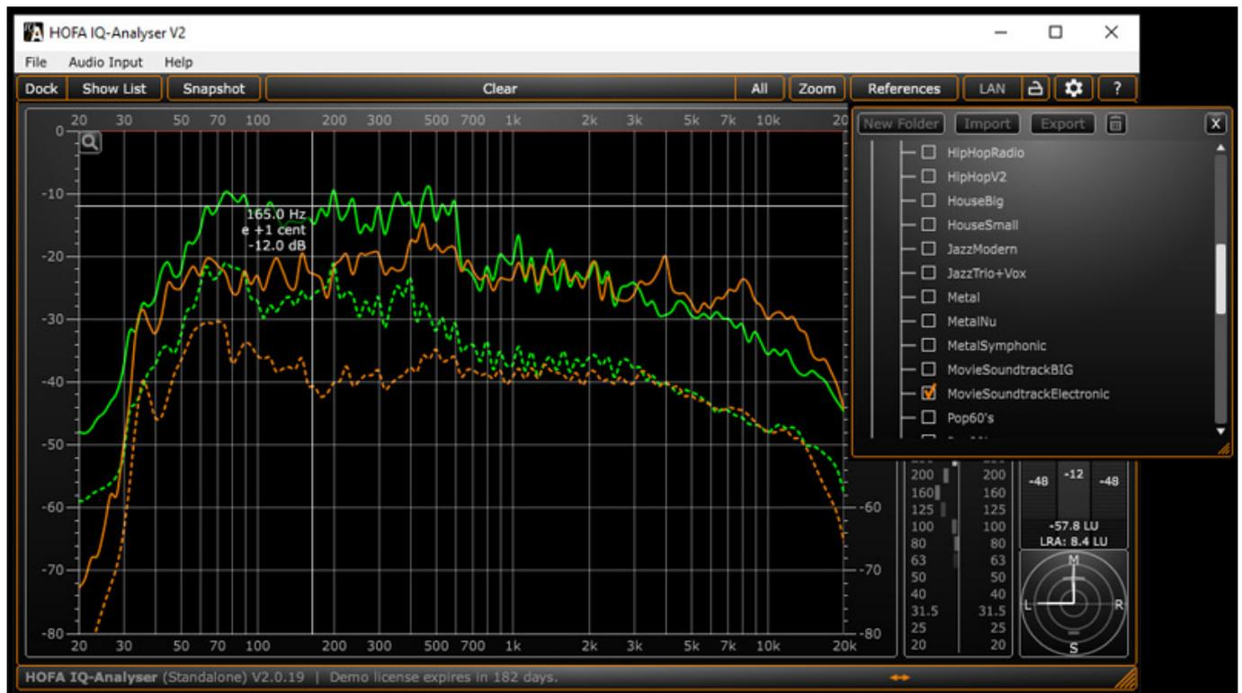
Um Vergleiche mit anderen Musikstücken, bzw. Audiodateien zu ermöglichen gibt es die Möglichkeit über den Dialog "References" Referenzmessungen von abgelegten Messungen oder auch von eigenen archivierten Messungen einzublenden. Dazu gleich mehr im folgenden Abschnitt.
