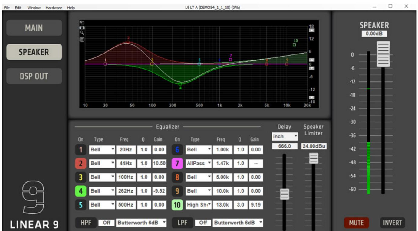
Der DSP rechnet mit einer Abtastrate von 96 kHz. Lediglich die Systemlatenz ist mit knapp unter drei Millisekunden vergleichsweise hoch. Da man bei kleineren Beschallungen das PA-System oftmals auf das lauteste Backline-Instrument (z. B. die Snare Drum) verzögert, sollte die System-Latenz in der Praxis aber nicht weiter ins Gewicht fallen. Tipp: Wer sich mit der Software vor dem Kauf vertraut machen möchte, der kann diese kostenlos von der HK Audio-Website laden und in einem Demo Modus starten.
