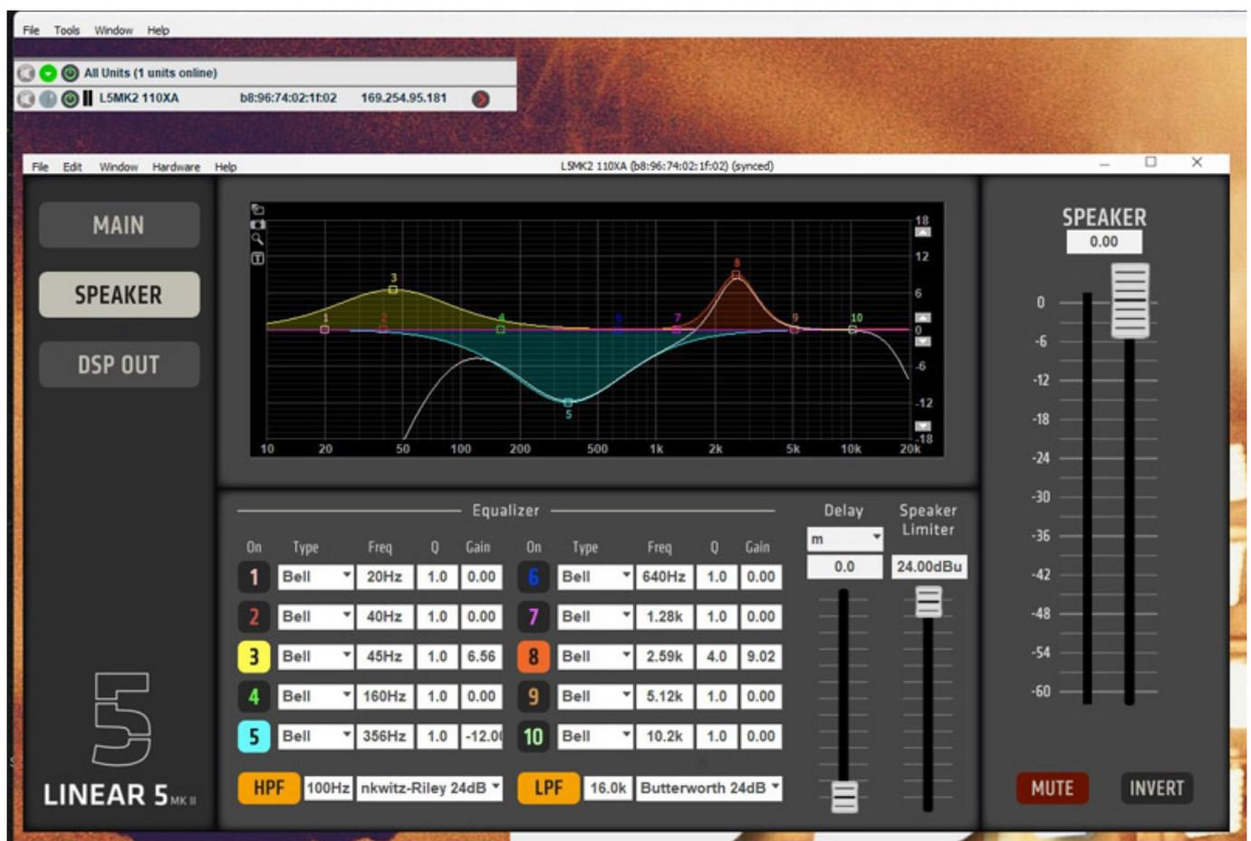
Einen Sonderfall stellt das direkt am Aktivmodul abrufbare „Remote“-Preset dar. Hier kann der Anwender eigene Einstellungen mit Hilfe der DSP Control Software hinterlegen.
