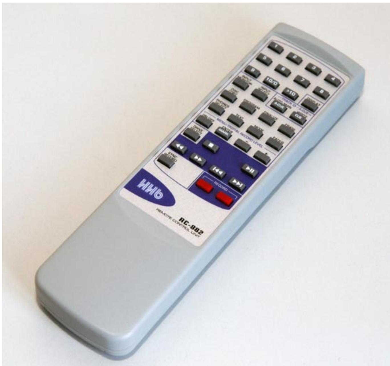
Mit zum Lieferumfang gehört die Infrarot-Fernbedienung RC-882, bei der neben den Laufwerkssteuerungsfunktionen noch Ziffertasten für Trackwahl, und Tasten für alle Funktionen die auch über die Frontplatte ausgeführt werden können, bereitstehen.
