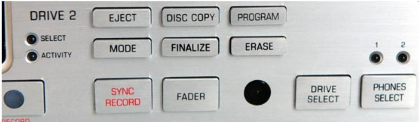
Eine besondere Möglichkeit ist noch der Einsatz der Fader-Funktion. Bei Nutzung der Play/Pause-Taste wird die Aufnahme direkt angehalten, bzw. gestartet - also mit hartem Schnitt. Bei Benutzung der Taste Fader erfolgt hier ein Fade In/Out. Die Fade-Zeit lässt sich im Menü von einer bis zu zehn Sekunden einstellen und zwar individuell für Fade-In und Fade-Out.
