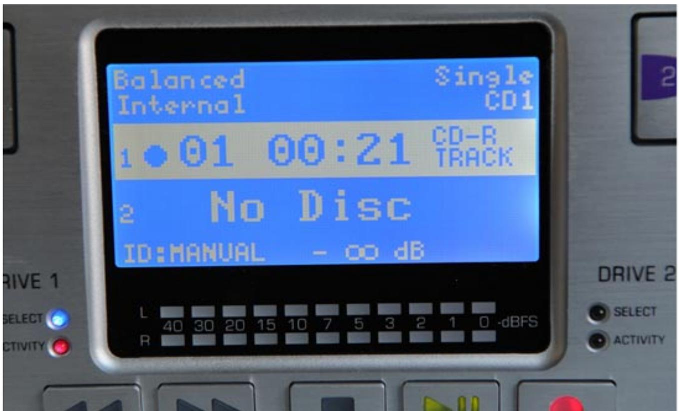
Unter dem hintergrundbeleuchtetem LC-Display befindet sich eine Bargrafanzeige für beide Kanäle für Ausgangspegel bei Play-, bzw. Input-Pegel bei Record-Betrieb.
