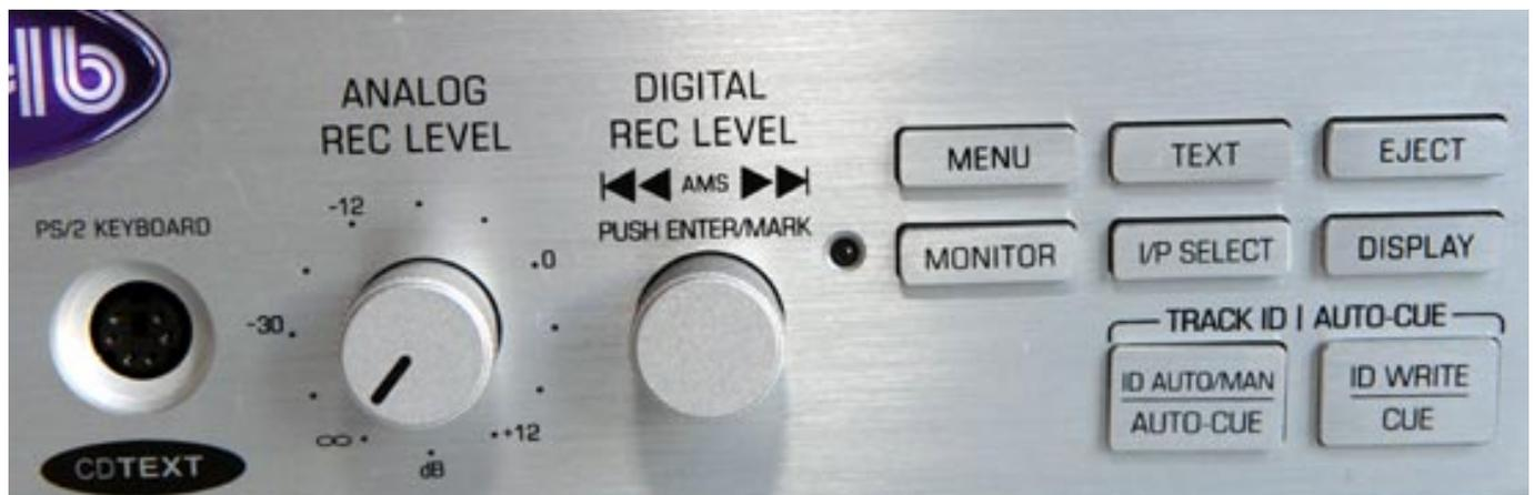
Track IDs/Cues lassen sich sowohl automatisch als auch manuell schreiben. Über das sogenannte Sync-Recording besteht auch die Möglichkeit die Aufnahme über eine ID im SPDIF-Datenstrom oder über einen Audioschwellwert zu starten (Auswahl über das Menü). Auch die Aufnahme nur eines Tracks ist über eine ID-Triggerung möglich. Als Medium lassen sich übrigens sowohl CD-R als auch CD-RWs nutzen. Über den Taster Finalize lässt sich die CD dann abschließen.
