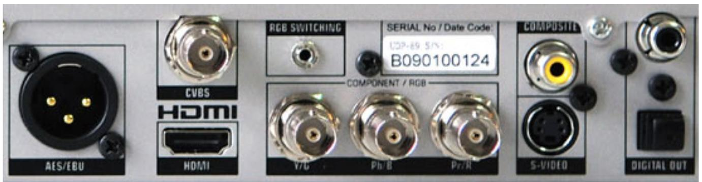
Das Videoausgangssignal steht auf drei BNC-Koax-Ausgängen als Component-Video-Signal bereit. Über eine Buchse (RGB-Switching) lässt sich auch ein Scart-Kabel anschließen, wobei dann die drei Ausgänge auf RGB-Format umschaltet. Ein Anschlußschema befindet sich in der Bedienungsanleitung, die auch in anderen Belangen kaum Fragen offen lässt. Weiter steht das Videosignal noch als Composite
