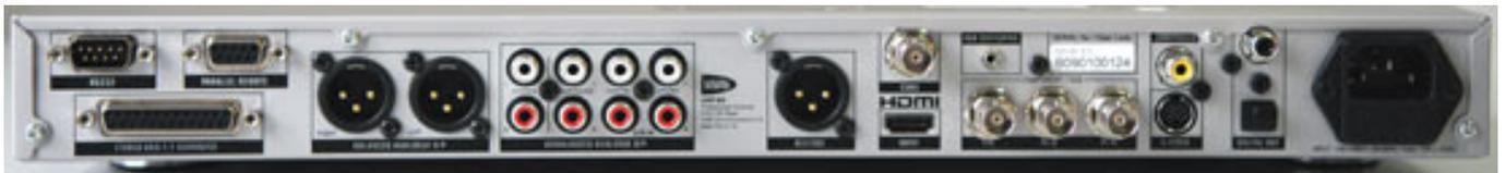
Auf der linken Seite befinden sich drei Sub-D-Buchsen: eine serielle Schnittstelle (RS-232, eigenes Protokoll), ein Parallel Remote mit Eingängen (aktiv wenn Input auf Ground-Pegel) für Laufwerkssteuerung und Next/Previous sowie Ausgänge für Play, Pause und No Disc (alles Open Collector) sowie 25-polige Buchse auf denen beide Stereo und sechs Surround-Ausgänge analog, elektronisch symmetriert aufliegen.
