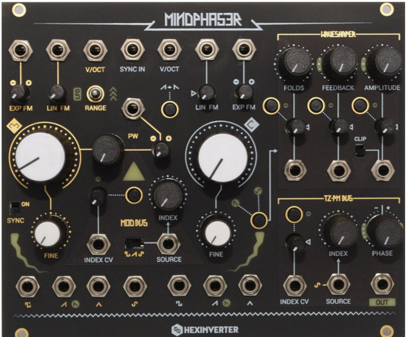
Der Name Complex Oscillator ist Programm wie man schnell beim ersten Blick auf die Modul-Frontplatte erkennt: jede Menge Regler und CV und Audio-In- und Outputs. Im Prinzip gibt es vier Sektionen und zwar: Träger-Oszillator, Modulations-Oszillator, Wavefolder und True-Zero Phase Modulation Bus.
