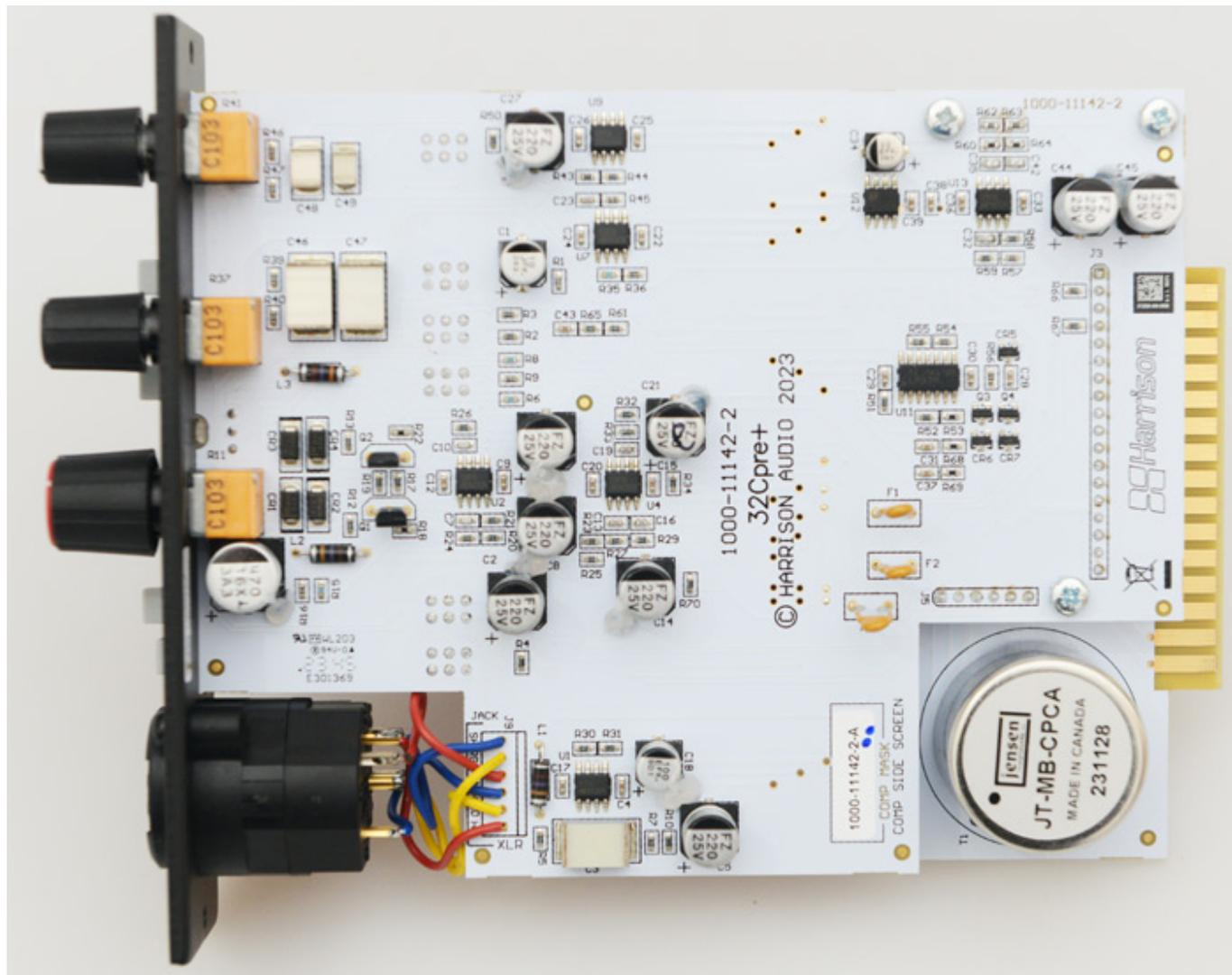
Im Signalweg befindet sich – entsprechend dem Harrison-Klassiker – ein Jensen-Übertrager, hier ein JT-MB-CPCA mit erstklassigen Leistungsdaten. Die Eingangsverstärkung des Moduls liegt laut Hersteller zwischen +20 und +70 dB. Damit ist also auch genug Dampf für den Betrieb von Vintage-Bändchen-Mikros vorhanden. Eine mehrfarbige LED visualisiert sehr zuverlässig den Eingangspegel.
