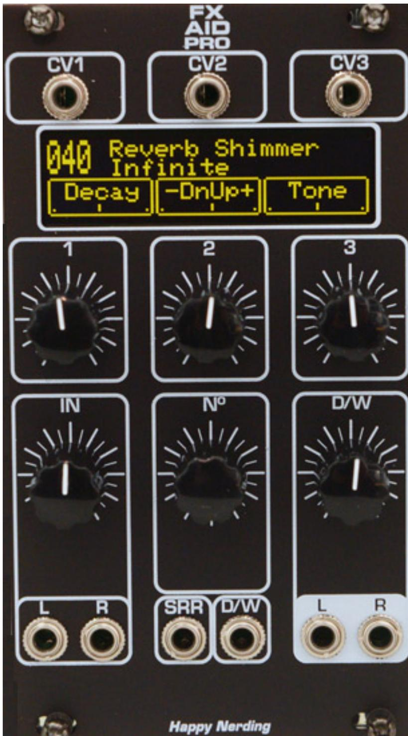
Es gibt oben drei CV-Eingänge, die auf die im Display angezeigten drei Parameter wirken. Unten befinden sich die beiden Ein- und Ausgänge und Steuereingänge für Abtastrate (SRR) und Original/Effektverhältnis (D/W). Alle Buchsen sind natürlich als 3,5-mm-Klinkenstecker ausgeführt.
