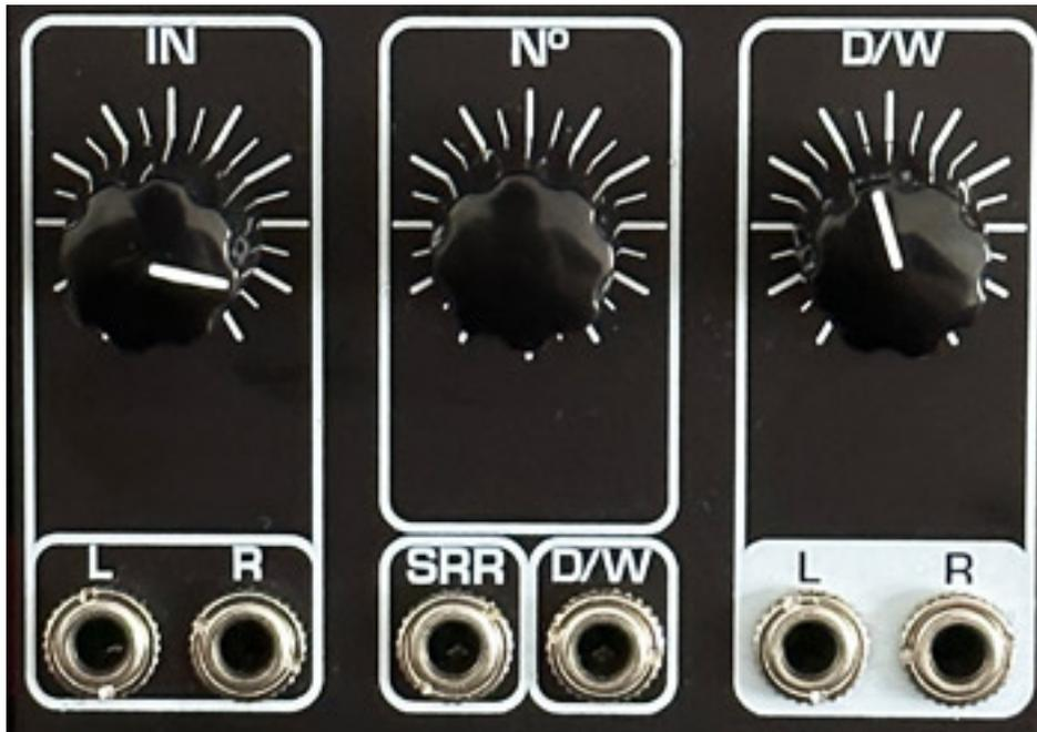
Der Regler für die Auswahl des Effektprogramms ist auch als Druckgeber ausgelegt. Über einen schnellen Doppelklick kommt man in das Konfigurationsmenü, wo sich zum Beispiel die drei LFOs einstellen und sich auch zehn User Presets P0 bis P9 speichern und wieder laden lassen. Die Einstellungen der drei LFOs werden dabei individuell mit gespeichert. Auch die Bildschirmschoner-Aktivierungszeit lässt sich hier festlegen (aus, 1, 10, 30 und 60 Minuten).
