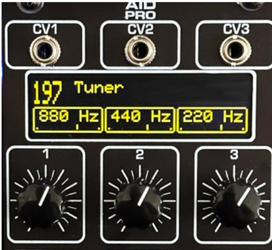
Oben im OLED-Display wird die aktuelle Speicherplatznummer und der Effektname angezeigt und darunter die Werte der drei Parameter (s. Abb. oben). Ein Strich symbolisiert zusätzlich zum angezeigten Wert den eingestellten Wert im Regelbereich. Die Drei Parameter lassen sich über die drei Regler darunter einstellen. Ganz unten kann der Anwender Ein- und Ausgangspegel anpassen, eines der 200 Effektprogramme anwählen (N°) und das Verhältnis Originalsignal zu Effekt (D/W) anpassen (s. Abb. unten).
