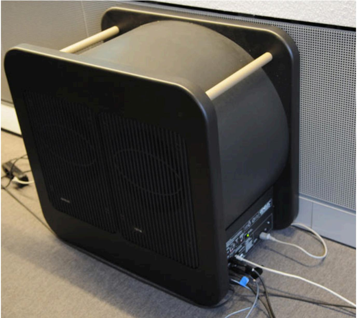
Auch die Subwoofer verfügen über interne DSPs sowie vier digitalen Eingängen - also acht Kanäle. Damit kann man also Systeme mit bis zu 7.1-Mehrkanalformat aufbauen. Auf analoge Eingänge hat man beim Subwoofer verzichtet.
