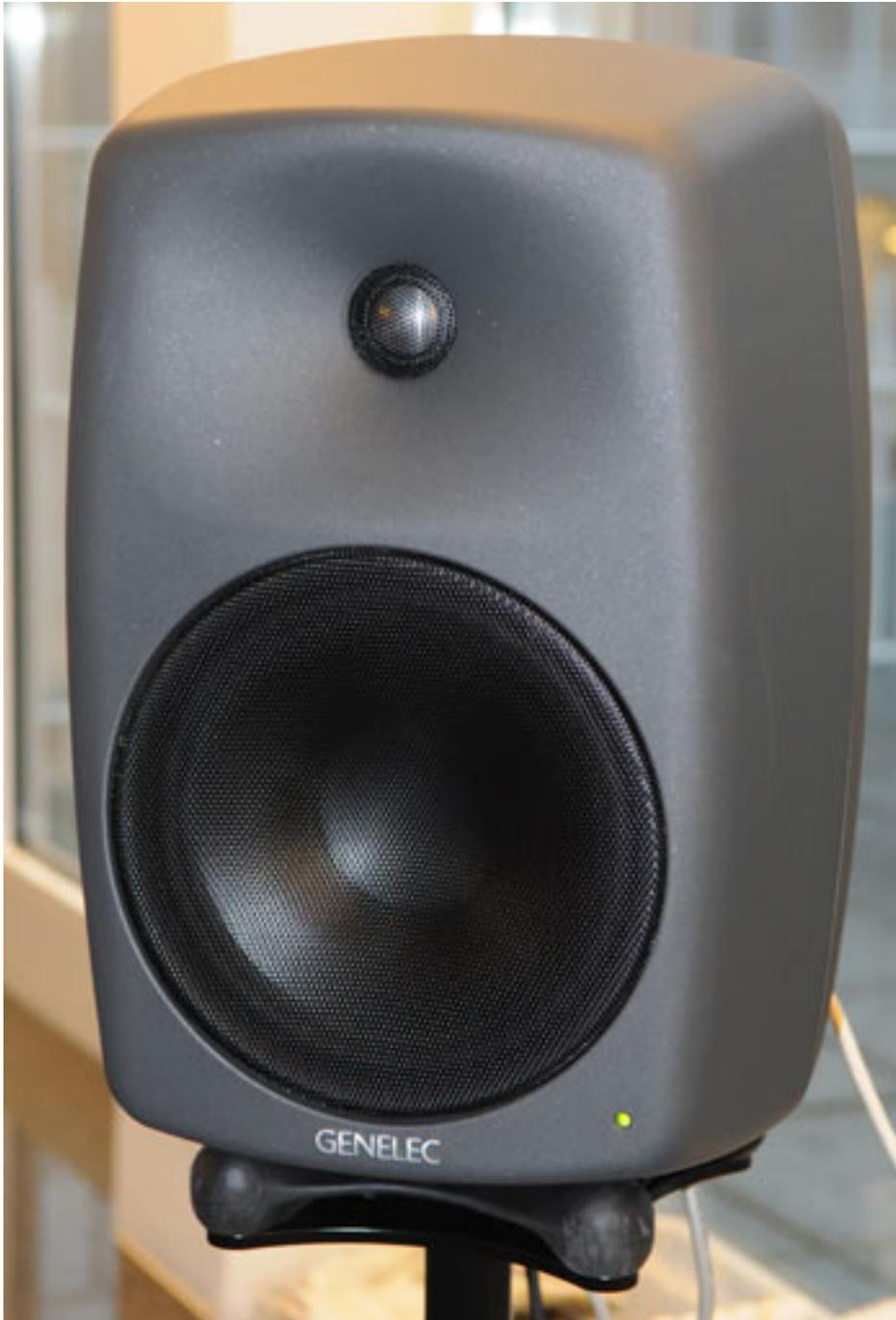
Das Gehäuse ist aus Aluminium und die 8250A ist wie die kleinere 8240A als Zweiwege-Bassreflexsystem aufgebaut. Als Treiber kommen hier ein 8"-Tieftöner sowie ein 1"-Treiber mit einer Metallhohtonkalotte zum Einsatz. Die maximale Leistung für den Tieftontreiber beträgt 150 und die für den Hochtöner beträgt 120 Watt.
