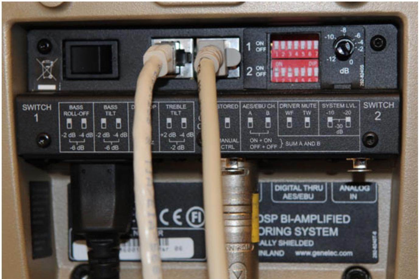
Die Anschlüsse sind vertieft angeordnet, so dass auch eine Wandmontage möglich ist. Neben dem AES-3-Eingang gibt es auch ein AES-3-Ausgang, mit dem man das Digital-Audio-Signal zur nächsten Box weiterleiten kann. Welcher Kanal von dem AES-3-Datenstrom benutzt wird (A oder B) lässt sich, wie viele andere Funktionen, über DIP-Schalter auf der Geräterückseite einstellen.
