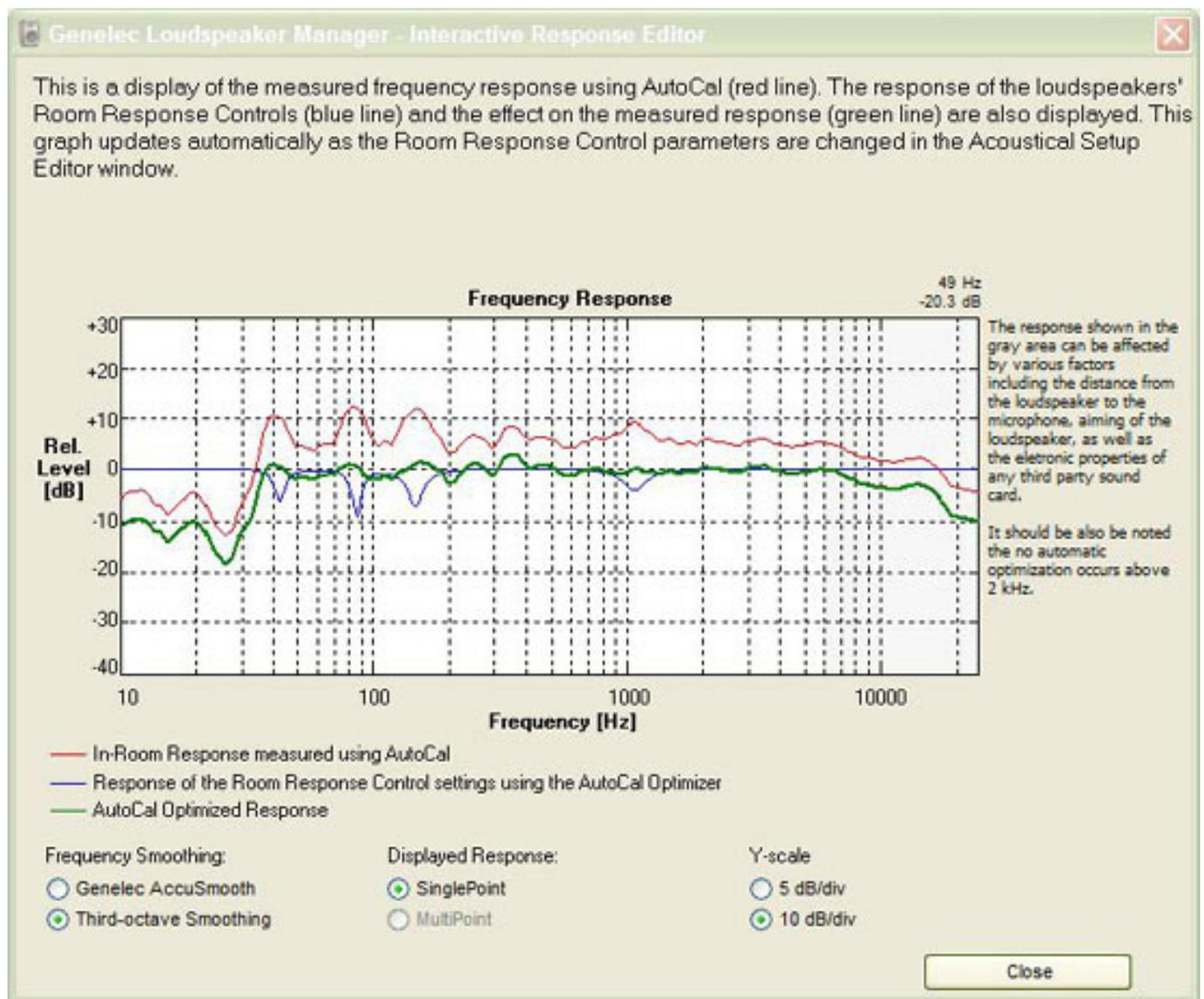
In dem Interactive Response Editor wird der gemessene Frequenzgang, die Korrekturkurve und das Ergebnis nach der Korrektur dargestellt.
