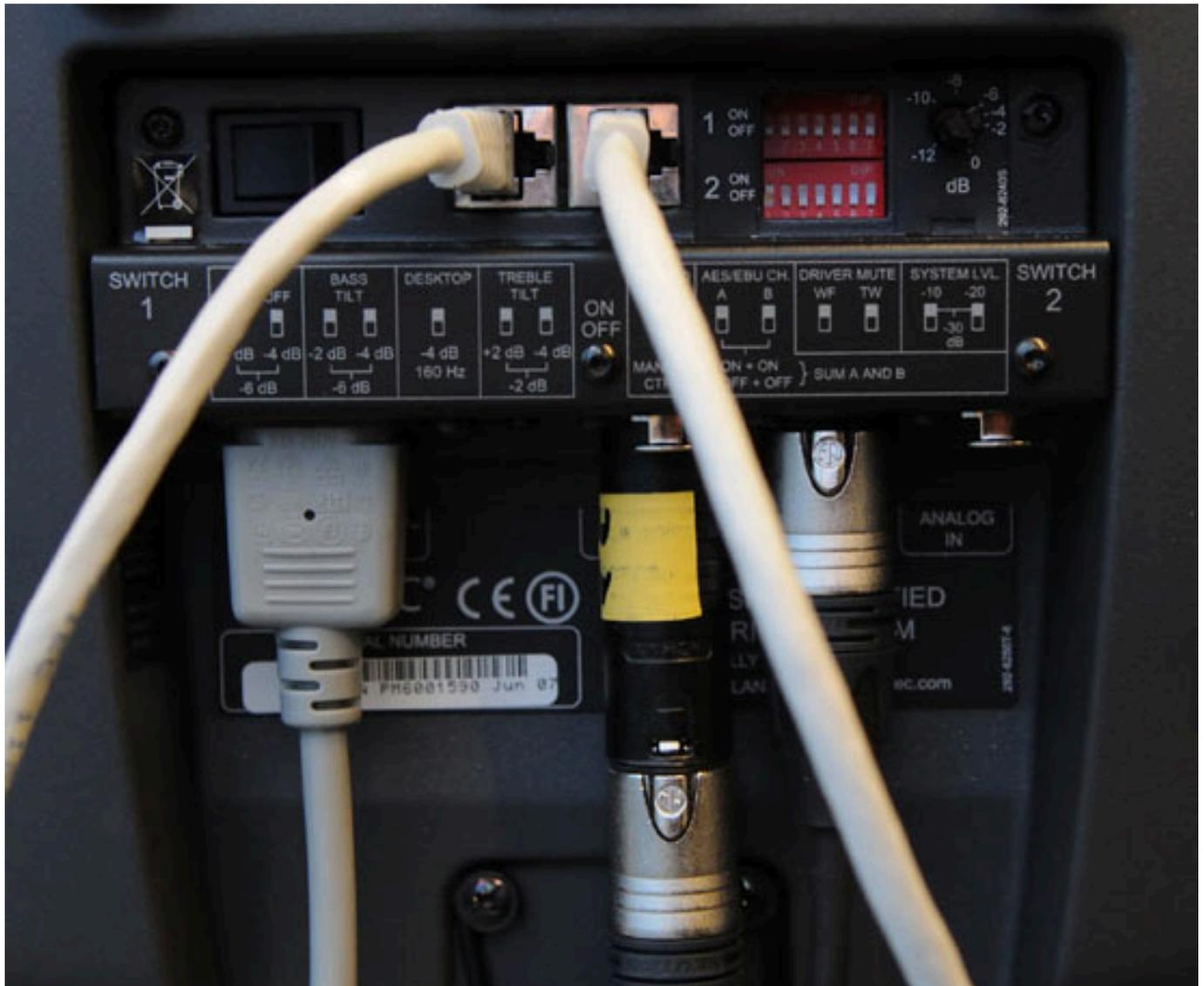
Die Anschlüsse sind vertieft angeordnet, so dass auch eine Wandmontage möglich ist. Neben dem AES-3-Eingang gibt es auch ein AES-3-Ausgang, mit dem man das Digital-Audio-Signal zur nächsten Box weiterleiten kann. Welcher Kanal von dem AES-3-Datenstrom benutzt wird (A oder B) lässt sich, wie viele andere Funktionen, über DIP-Schalter auf der Geräterückseite einstellen.
