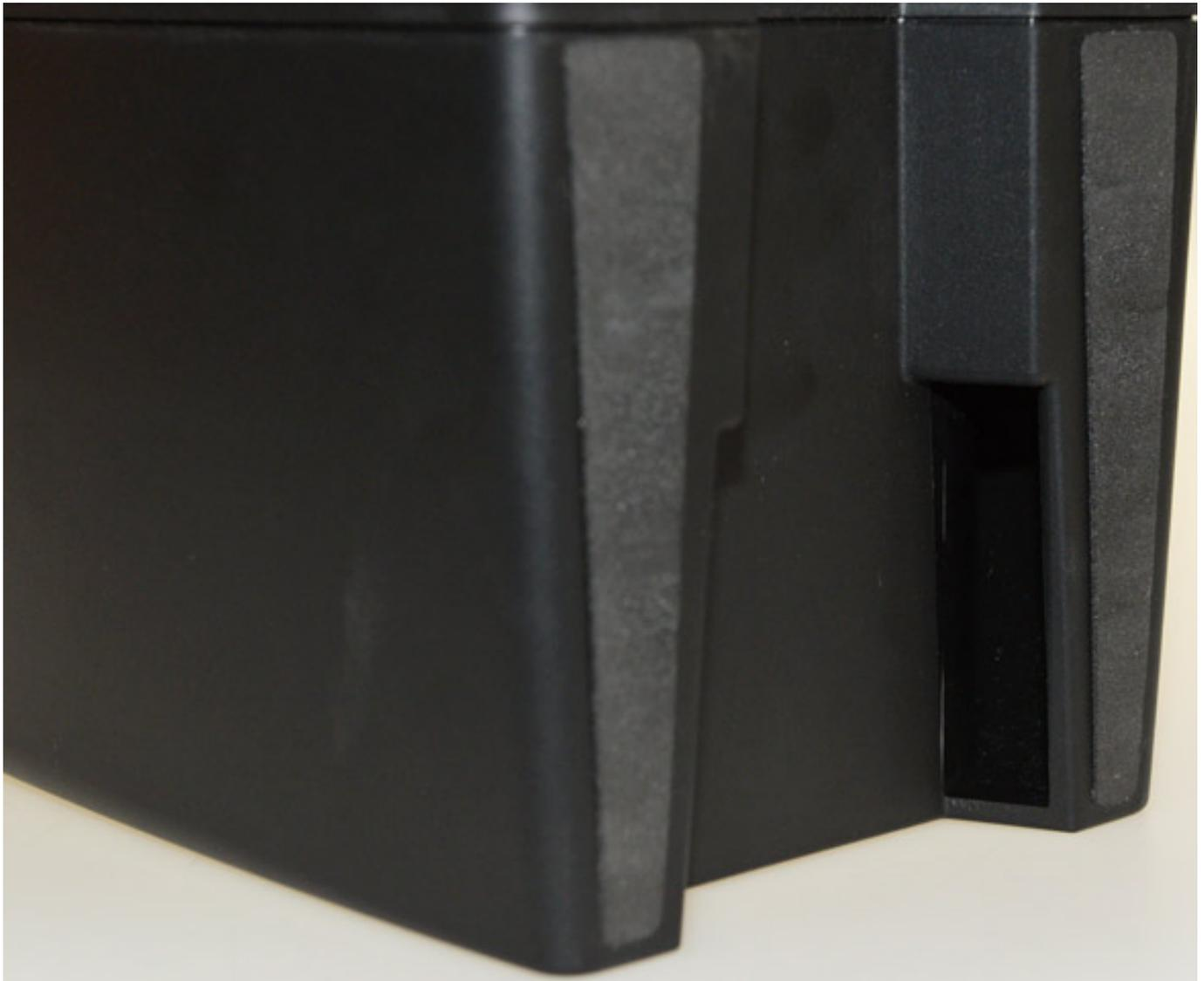
Diese Kanäle werden Laminar Integrated Ports (LIP) genannt und diese Technik ist von Genelec patentiert. Die Kanäle und deren Form sorgen dafür, dass hier keine Luftturbulenzen auftreten (siehe Grafik unten). Dieser Kanal lässt sich so nur dank dem Druckgussverfahren in die Gesamtkonstruktion integrieren.
