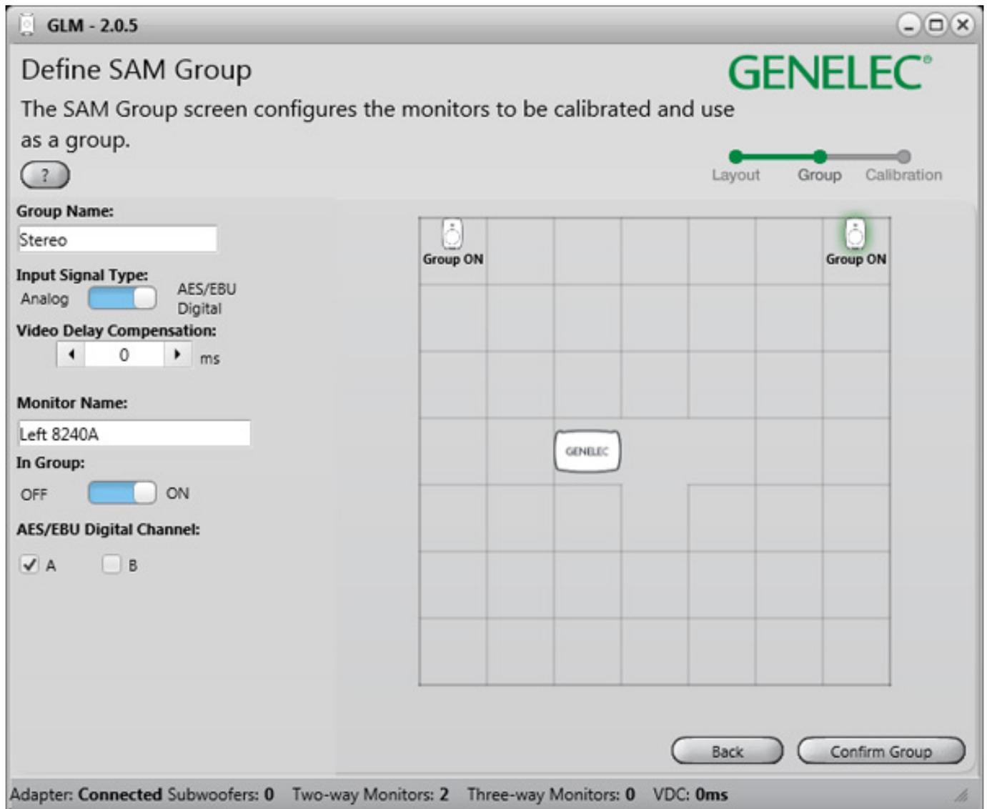
Als nächstes legt man eine Gruppe an. In unserem Fall eine Gruppe die wie "Stereo" genannt haben. Für jeden Monitor ist die entsprechende Signalquelle (AES/EBU oder analog) anzugeben und ggf. ein Delay für eine Bild/Tonsynchronisations-Kompensation.
