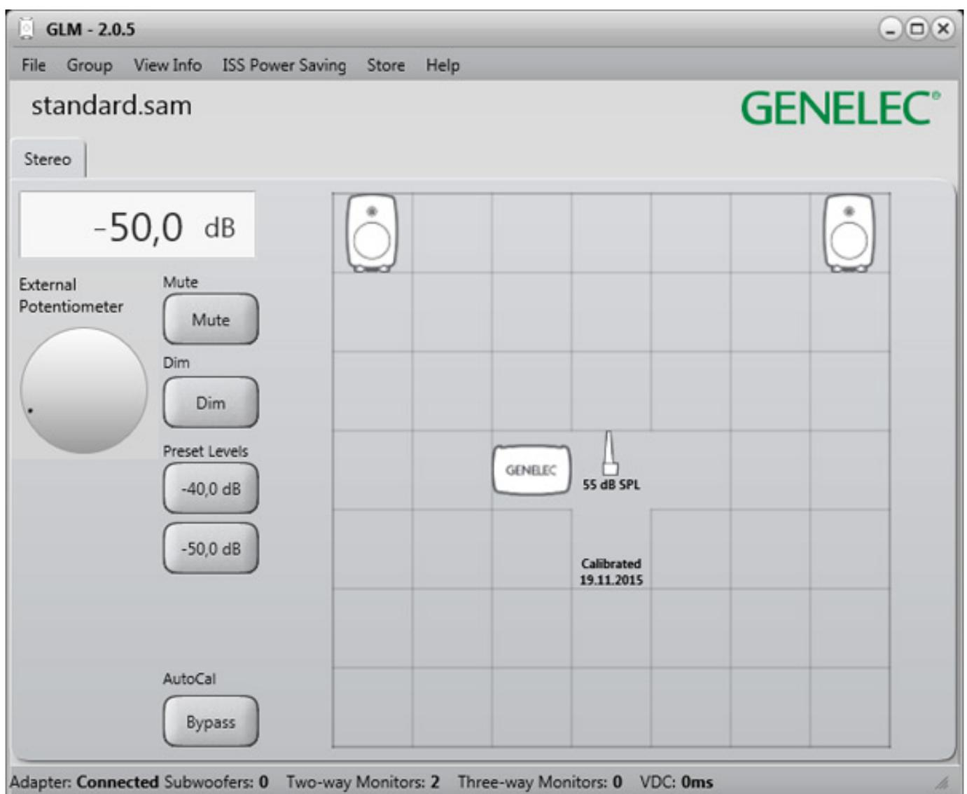
Über die GLM-Software lässt sich der Pegel einstellen und man kann auch über virtuelle Tasten auch -40 oder -50 dBFS Pegel direkt anwählen und es gibt eine Dim- und eine Mute-Funktion. Wenn kein Lautstärkedrehgeber an der GLM-Box angeschlossen ist wird der Lautstärkereger in dem Software-Dialog als Fader angezeigt, bei angeschlossenem Drehgeber als Drehknopf (s. Abb. oben).
