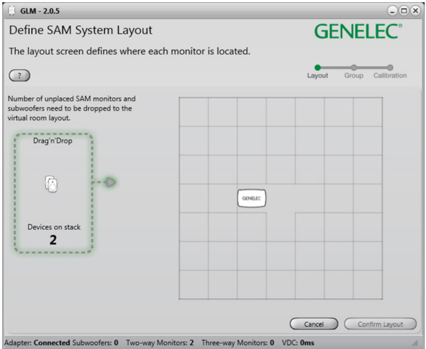
Kommen wir nun zum Einmessvorgang. Als erstes erscheint ein Fenster mit einer Arbeitsfläche und einem Bereich wo die detektierten Lautsprecher symbolisiert sind (s. Abb. oben). Es lassen sich auch Setups mit bis zu 30 Lautsprecher und bis zu fünf Subwoofer erstellen.
