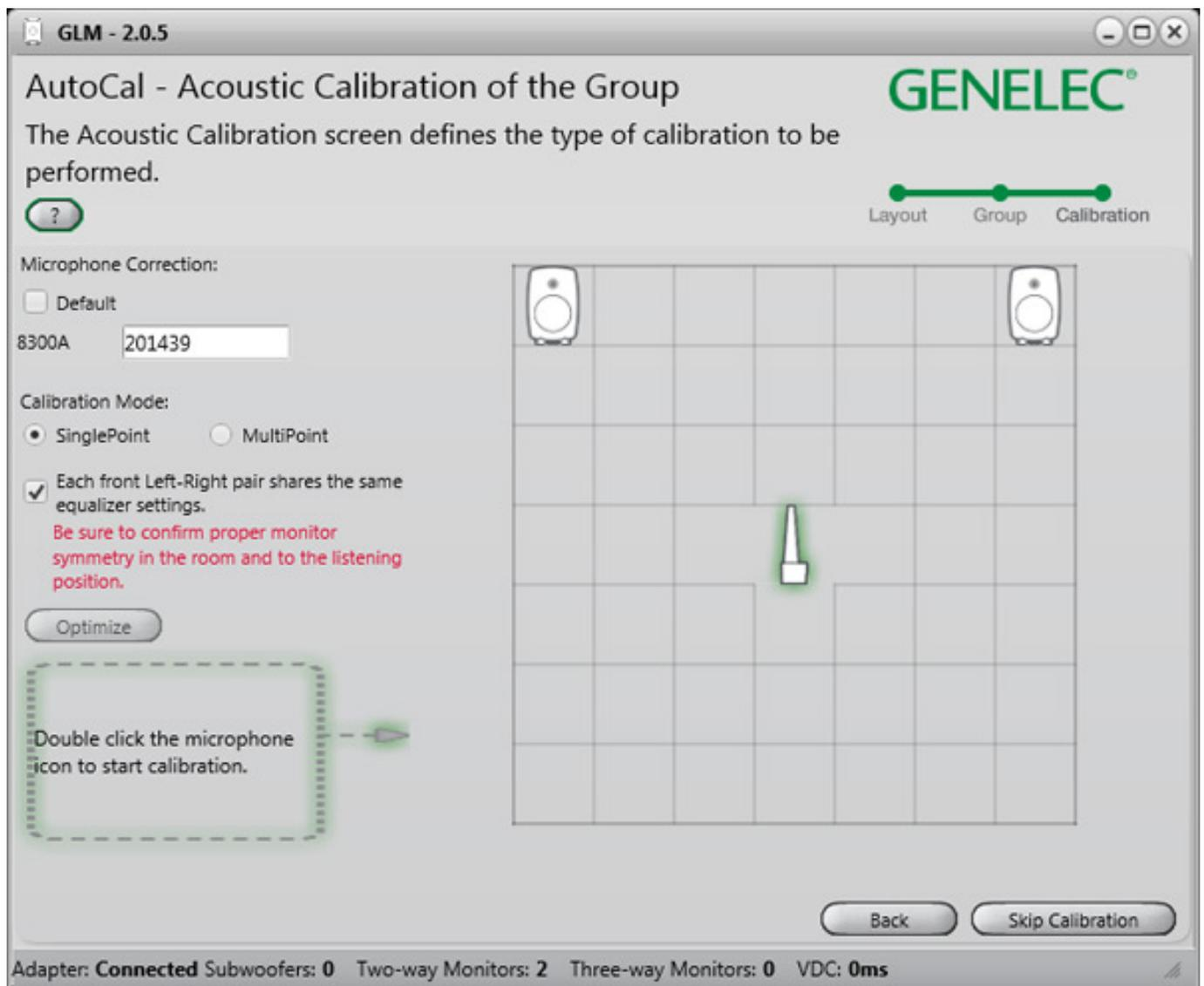
Nun gibt man die Seriennummer des Messmikrofons ein. Es kann eine SinglePoint-Messung an der zentralen Hörposition durchgeführt werden oder eine MultiPoint-Messung an einer zentralen Position plus drei Positionen herum. Weiter kann man eine Filterung mit identischen oder unterschiedlichen Parametern pro Lautsprecher vorsehen. Letzteres ist bei unsymmetrischen Aufstellorten, vorzuziehen.
