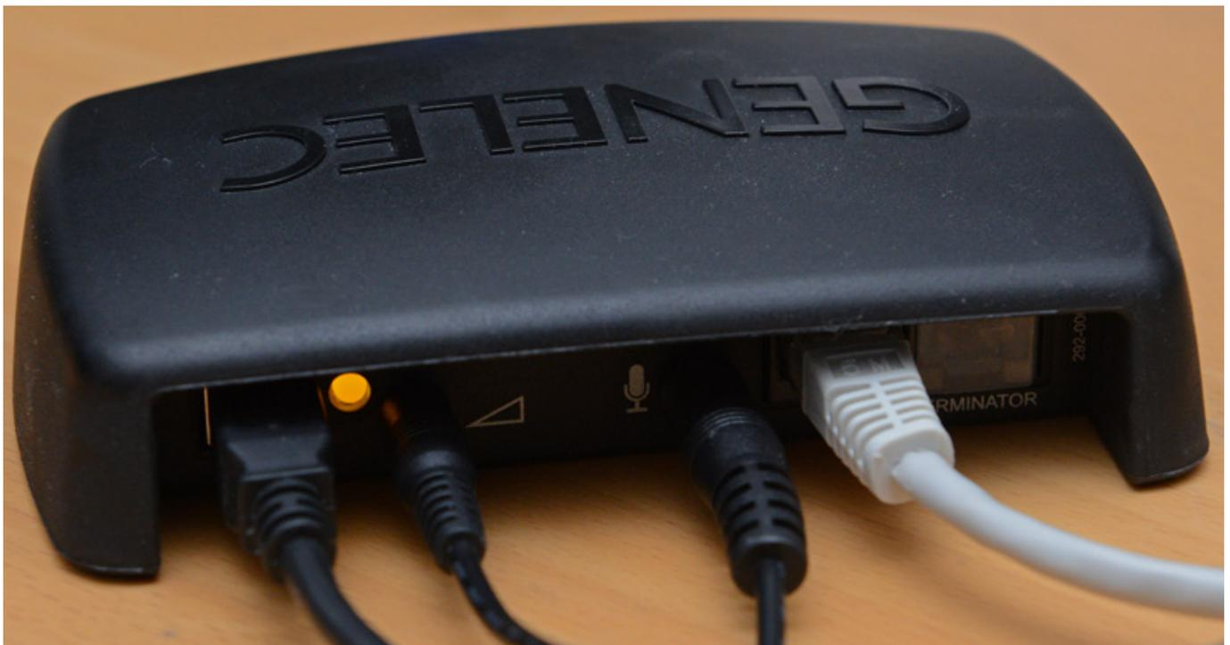
Die Anschlussbox ist als Tischgehäuse ausgeführt und hinten befinden sich Anschlüsse für USB, einen optionalen Lautstärkereger, dem Messmikrofon sowie einem Anschluss für ein CAT-5-Kabel für die Lautsprecherboxen, die in Serie beschaltet werden. Jeder Lautsprecher verfügt daher über einen GLM-Ein- und Ausgang.
