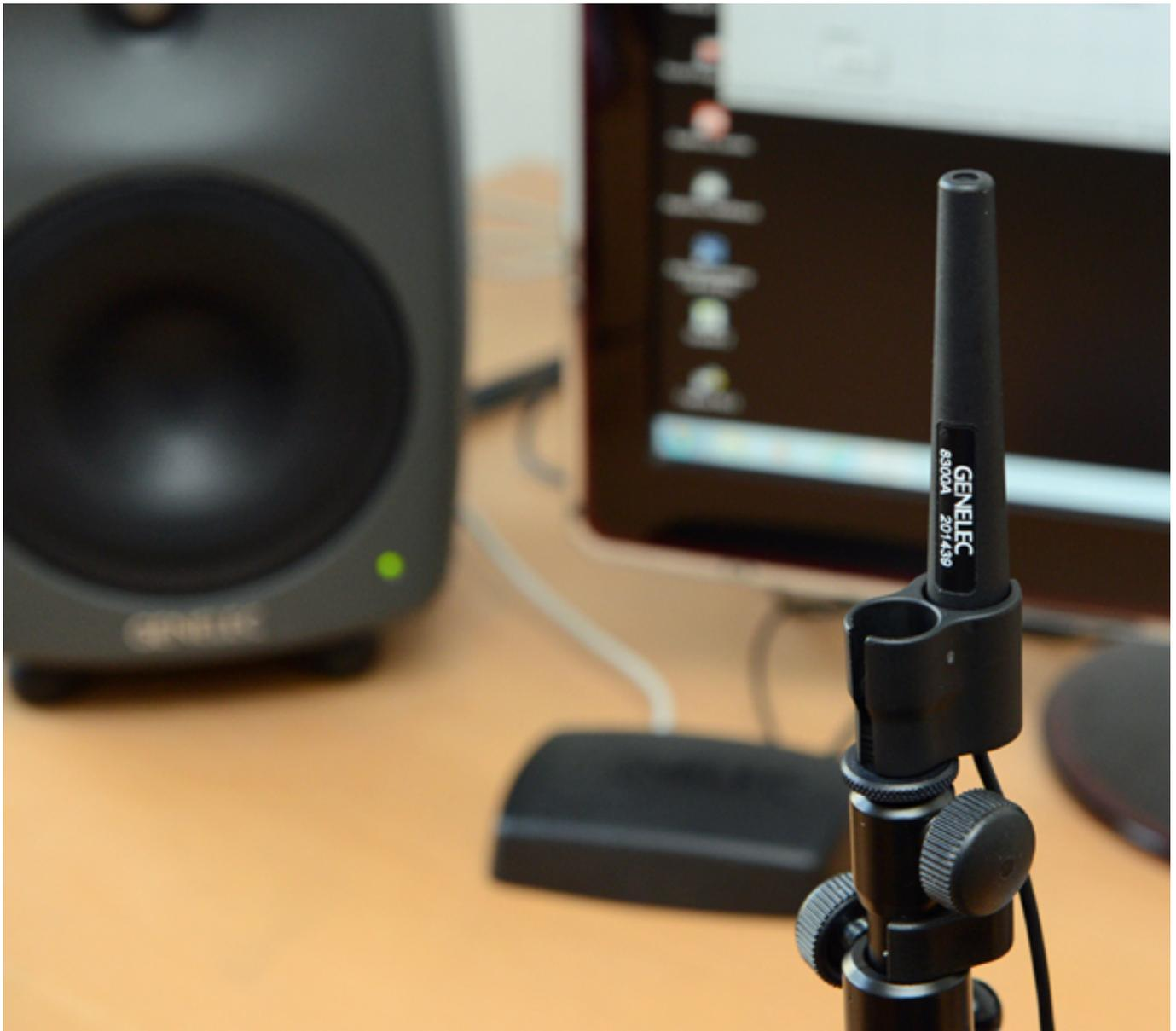
Das Messmikrofon wird mit einem Halter geliefert, denn man auf in Verbindung mit den üblichen Stativgewindegrößen einsetzen kann. Jedes Mikrofon besitzt eine Seriennummer und die spezifischen Daten eines jeden GLM-Mikrofons sind in der GLM-Software gespeichert und individuelle Toleranzen können so bei der Messung berücksichtigt, bzw. kompensiert werden.
