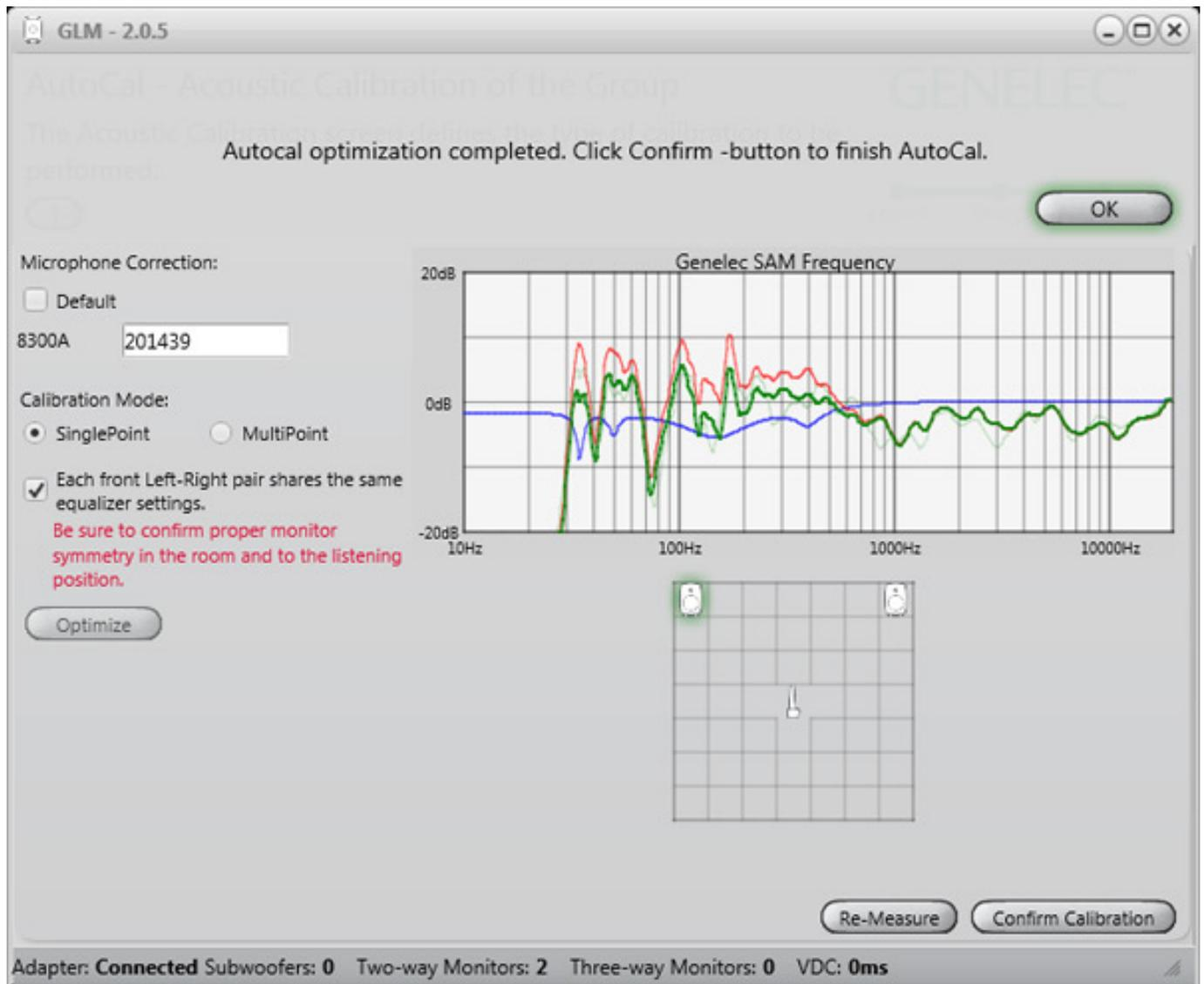
Durch einen Doppelklick auf das Messmikrofon gibt es ein Ton-Sweep auf der rechten und linken Seite und die Berechnung der Kompensations-EQ-Parameter beginnt. Diese ist schon nach ein paar Sekunden abgeschlossen und das Ergebnis steht bereit.
