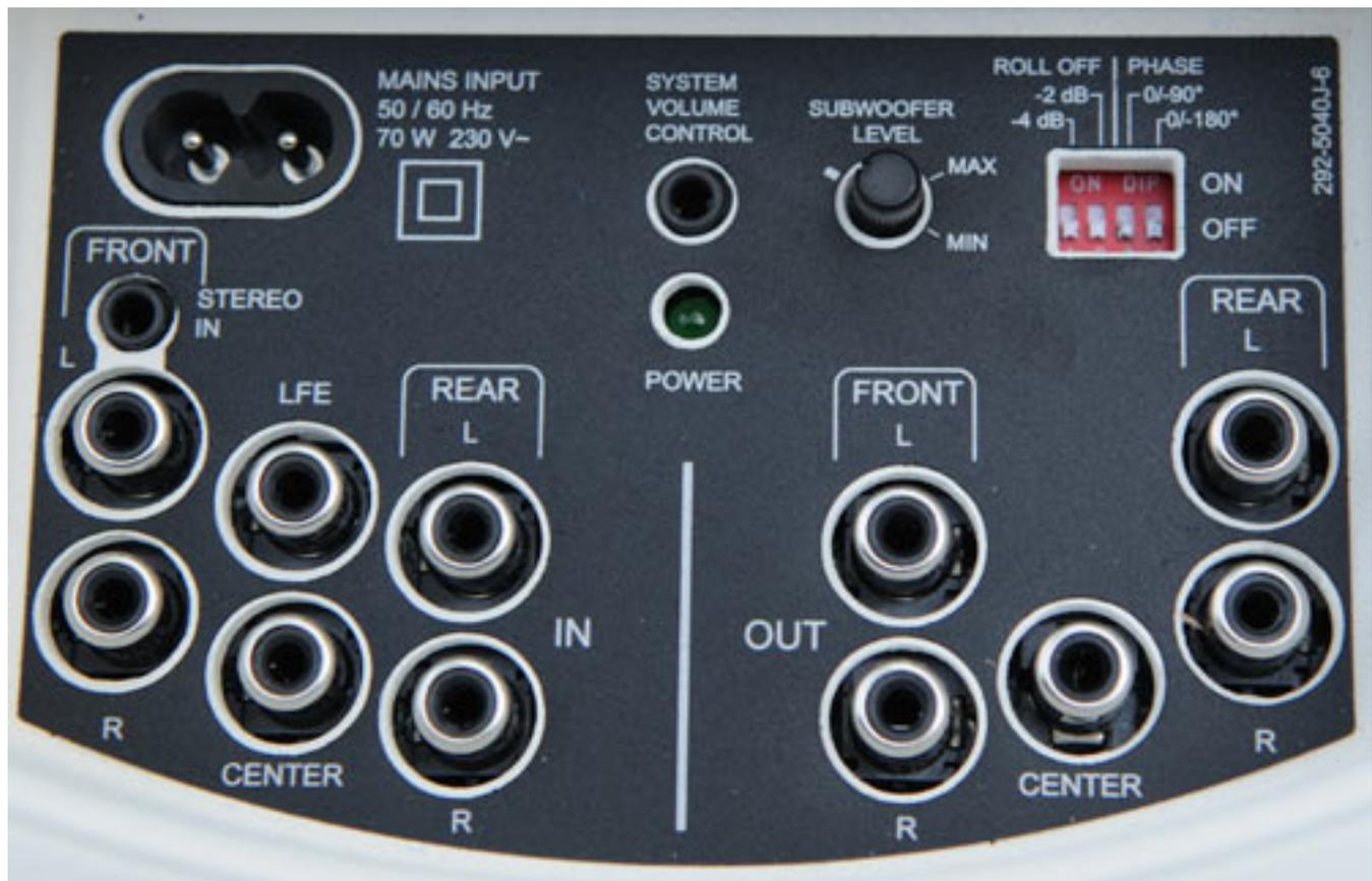
Der Subwoofer-Pegel lässt sich über ein Poti getrennt einstellen (s. Abb. oben). Über je zwei DIP-Schalter kann der Anwender weiter die Phasenlage (0, 90 und 180 Grad) sowie Roll Off (0, -2 und -4 dB) anpassen.
