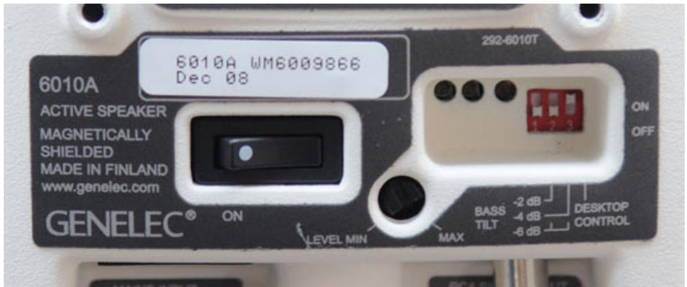
Neben dem Netzschalter ist ein Trimpoti für die Anpassung des Eingangspiegels sowie zwei DIP-Schalter für die Anpassung des Übertragungsverlaufs im Bassbereich von -2, -4 oder -6 dB. Wenn die 6010A zusammen mit dem 5040A betrieben werden, lässt sich die Lautstärke über ein schweren Desktop-Regler zentral beeinflussen. Für diesen Betriebsfall ist ggf. ein DIP-Schalter an der 6010A zu aktivieren.
