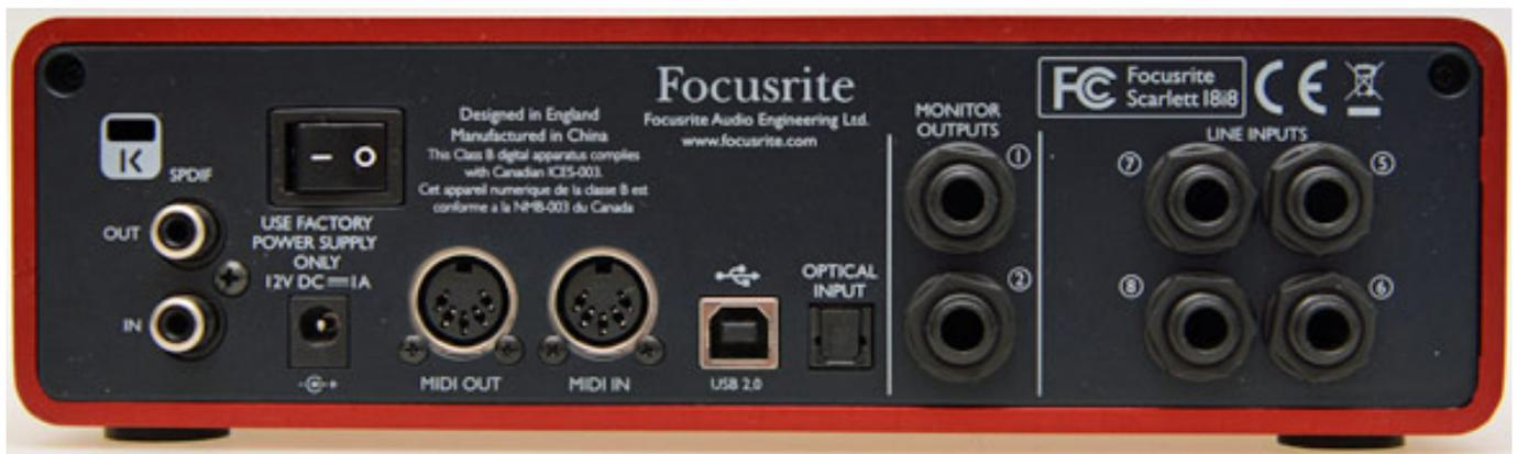
Die Spannungsversorgung beim 18i8 erfolgt über ein Steckernetzteil und im Gegensatz zu den kleinen USB-gespeisten Interfaces hat man dem 18i8 auch ein Ein/Ausschalter spendiert. Auch hier ist eine Kensington-Sicherungsmöglichkeit gegeben und eine MIDI-Schnittstelle (In/Out) ist ebenfalls noch vorhanden.
