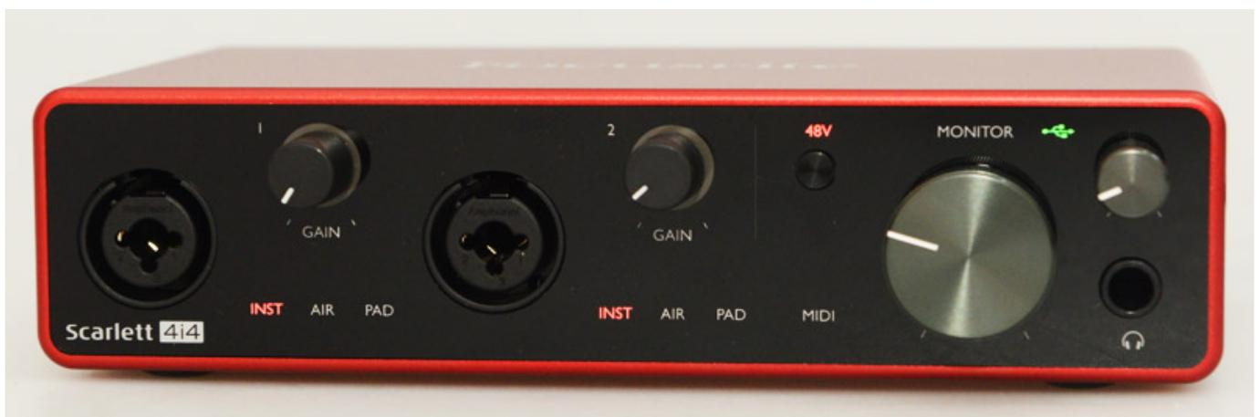
Alle Bedienelemente befinden sich auf der Frontplatte wie Gain-Regler, der große Regler für den Monitor-Pegel und ganz rechts der Regler für den Kopfhörerpegel.
