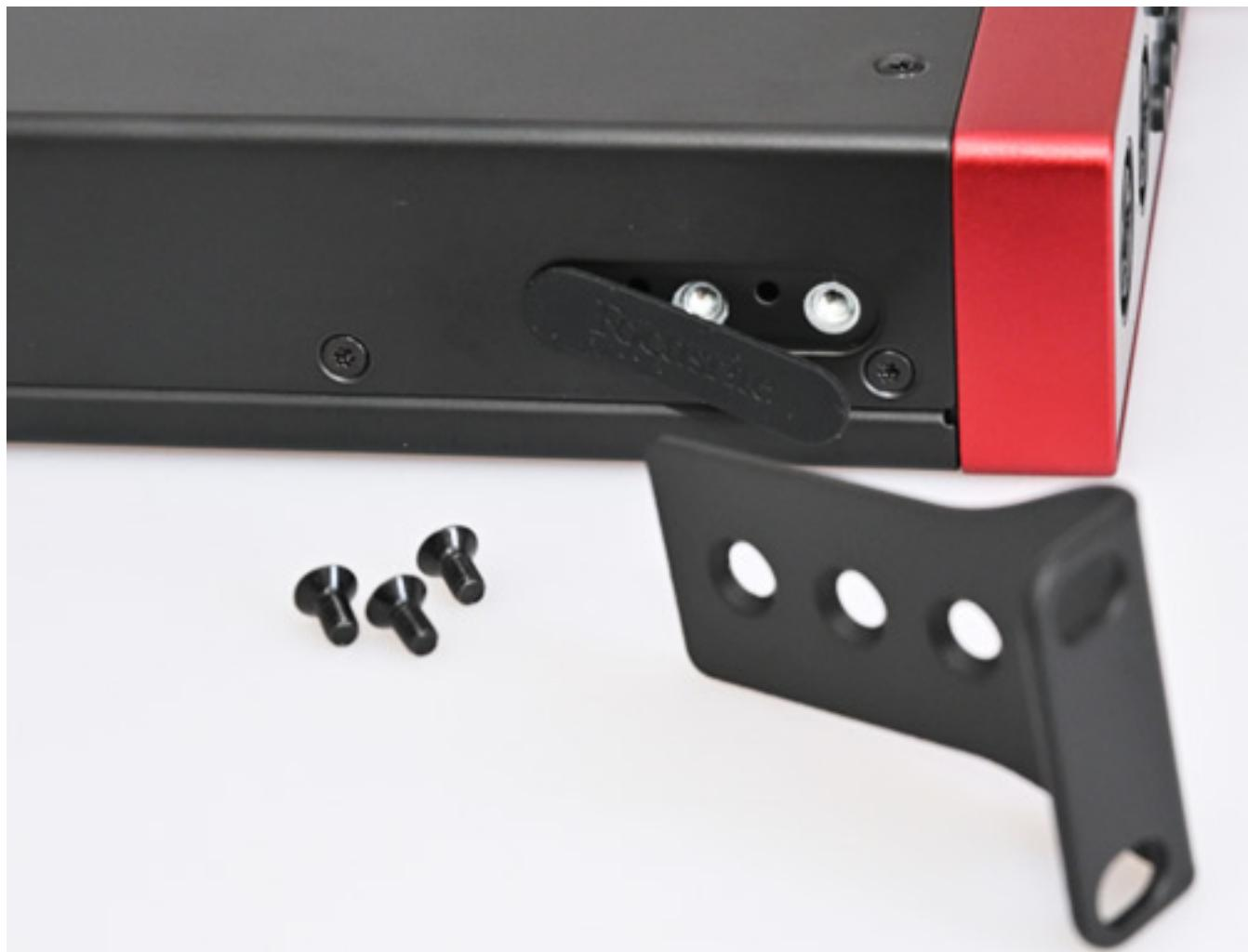
Das mit Rack-Winkeln montierbare 19-Zoll-Gerät wiegt 3,3 kg. Die Bauhöhe beträgt 1 HE und einer Tiefe von 260 mm. Die Gewinde zur Befestigung der Metallwinkel verstecken sich hinter einem gummierten Sichtschutz für eine Desktop-Nutzung.
