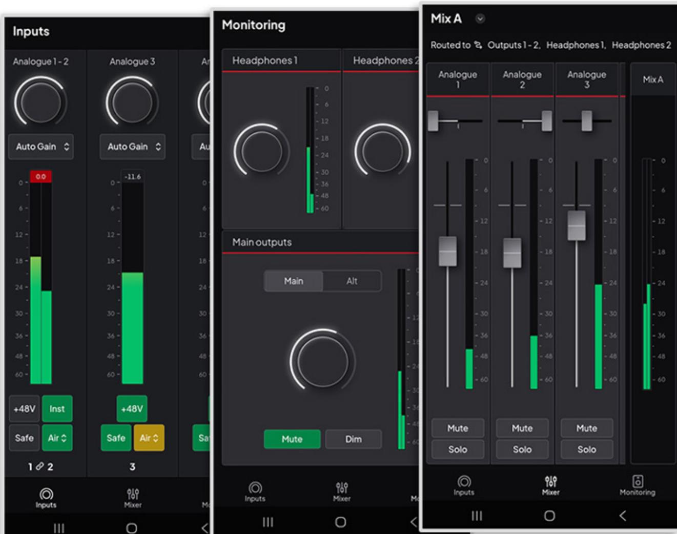
Als sehr praktisch erwies sich die Fernsteuerung von Parametern mit Hilfe der App. Nach dem Herunterladen im App-Store erfolgte die Verbindung mit QR-Code schnell und reibungslos. Steuerbar sind Kanal-Ein und -Ausgänge sowie Pegel für Kopfhörer und Monitorausgang.
