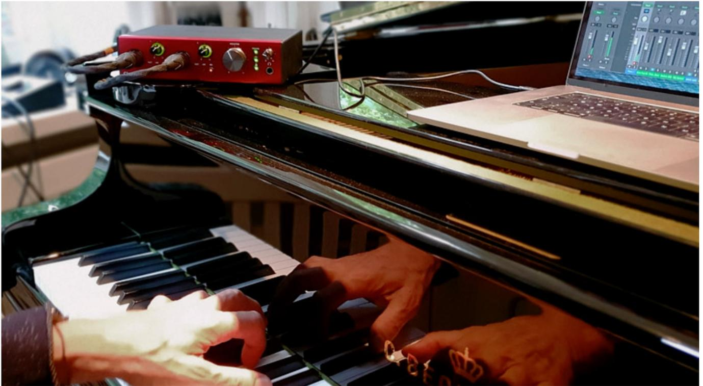
Als praktisch erwies sich die Fähigkeit des Clarett+ 2Pre, ohne zusätzliche Stromkabel am Notebook betrieben werden zu können. Laut Focusrite funktioniert dies mit Systemen, die 15 Watt pro USB-C Port bereitstellen. Gleiches gilt übrigens für das interne Netzteil des Clarett+ 8Pre, dass im Gegensatz zu Mitbewerbern mit externem Netzteil keinen zusätzlichen Stauraum im Rack beansprucht.
