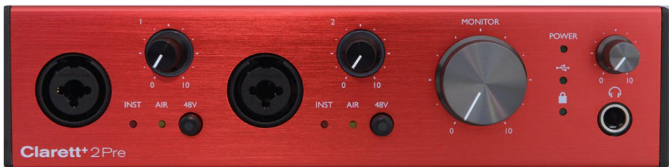
Das Clarett+ 2Pre verfügt wie sein Vorgänger Clarett USB 2Pre über zehn Ein- und vier Ausgänge inklusive MIDI-I/O sowie ADAT-Eingang und zwei unabhängig regelbare Kopfhörerausgänge, wobei beide analogen Mikrofonvorverstärker-Eingänge in Form von Combo-XLR-Buchsen frontseitig angebracht sind.
