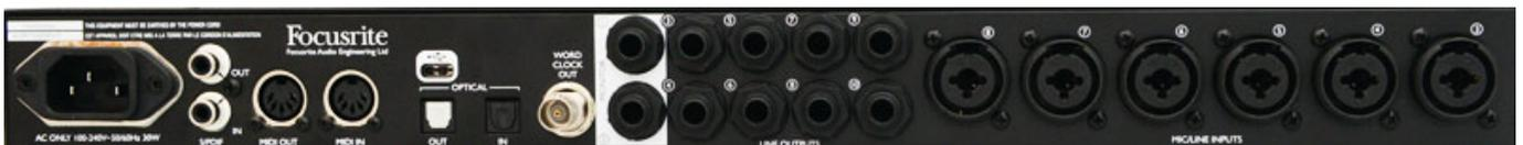
Links außen auf der Geräterückseite ist der Kaltgerätestecker des Universalnetzteils für 100 und 240 Volt bei 50 oder 60 Hz untergebracht. Rechts daneben befinden sich die S/PDIF-Ein-/Ausgänge in Form von Cinch-Buchsen. Via Focusrite Control lässt sich das Audiosignal-Routing anpassen. Es folgen zwei 5-Pin-Anschlüsse für
