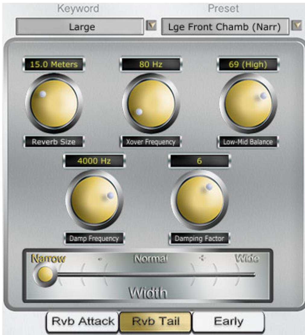
Beim Reverb Tail (s. oben) hat der Anwender Zugriff auf die Raumgröße, wobei hier eine Kantenlänge in Metern angegeben wird. Weitere Parameter sind für Frequenzichtung des Hallausklangs sowie mit dem Parameter Width ein Parameter mit dem die grundsätzliche Länge des Tails eingestellt wird.
