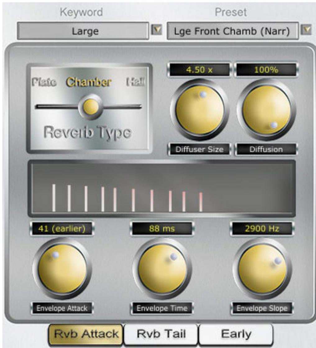
Über drei Reiter lassen sich die Parameter für die Reverb Attack, Reverb Tail und die Early Reflexions einstellen. Der Dialog für die Attack (siehe oben) beinhaltet auch den Reverb-Typ: Plate, Chamber oder Hall. Die Parameter selbst sind an sich selbsterklärend. Mit Diffuser Size und Diffusion kann man die Eigenschaften des Wandmaterial im Raum verändern und mit den Envelope-Parametern den Verlauf der Attack-Hüllkurve.
