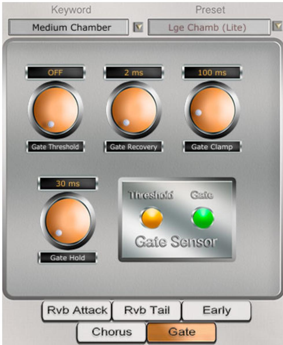
Der Gate-Dialog bietet vier Regler für den Schwellwert (Thresholds), Rückstellgeschwindigkeit (Recovery), Öffnungszeit des Gates (Hold) nach Unterschreiten der eingestellten Schwelle und die Schließzeit nach der Hold-Phase (Clamp). Also sehr umfangreiche Möglichkeiten. Zur optischen Kontrolle gibt es einen Indikator für das Erreichen des Schwellwertes sowie eine wenn das Gate geöffnet ist.
