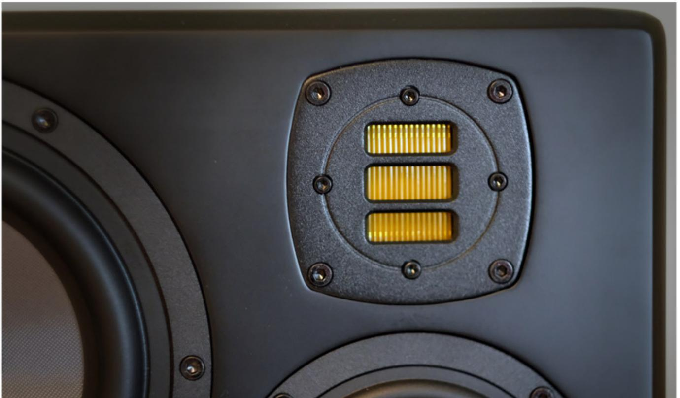
Für die Wiedergabe des Hochtonbereichs oberhalb von 2,8 kHz kommt ein Air Motion Transformer (AMT) des Typs RS3 zum Einsatz, welcher durch einen eigenen 50 Watt starken Class-D Verstärker angetrieben wird.
