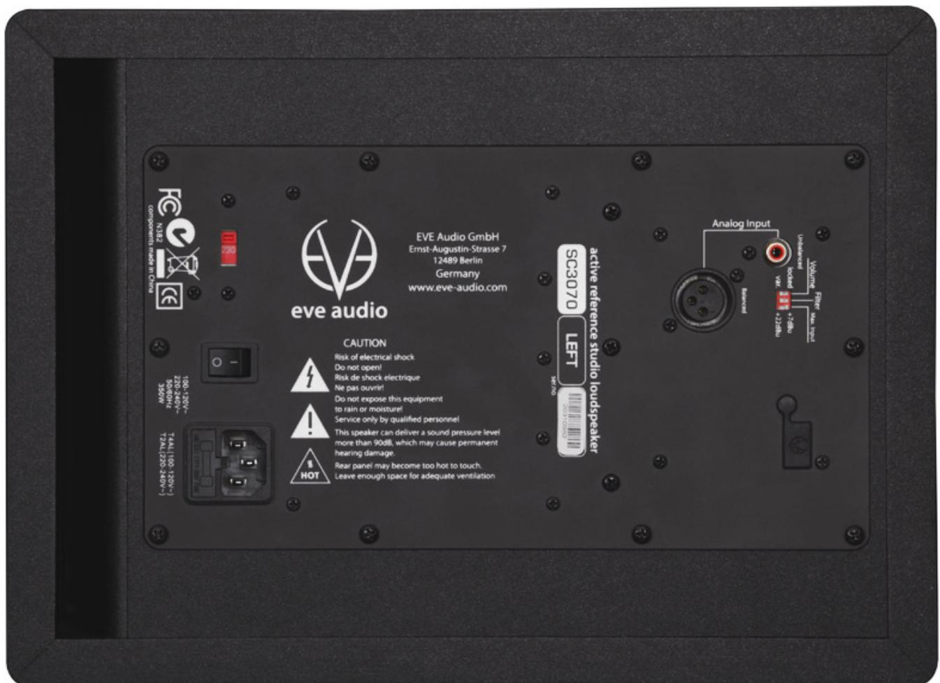
Der rückseitige Anschluss der Audiosignale erfolgt wahlweise über einen symmetrischen XLR-Eingang oder unsymmetrisch über einen herkömmlichen Cinch-Port inklusive Level-Lock, Filter-Lock und Eingangslevel-Wahl (+7 dBu / +22 dBu) per DIP-Switch.
