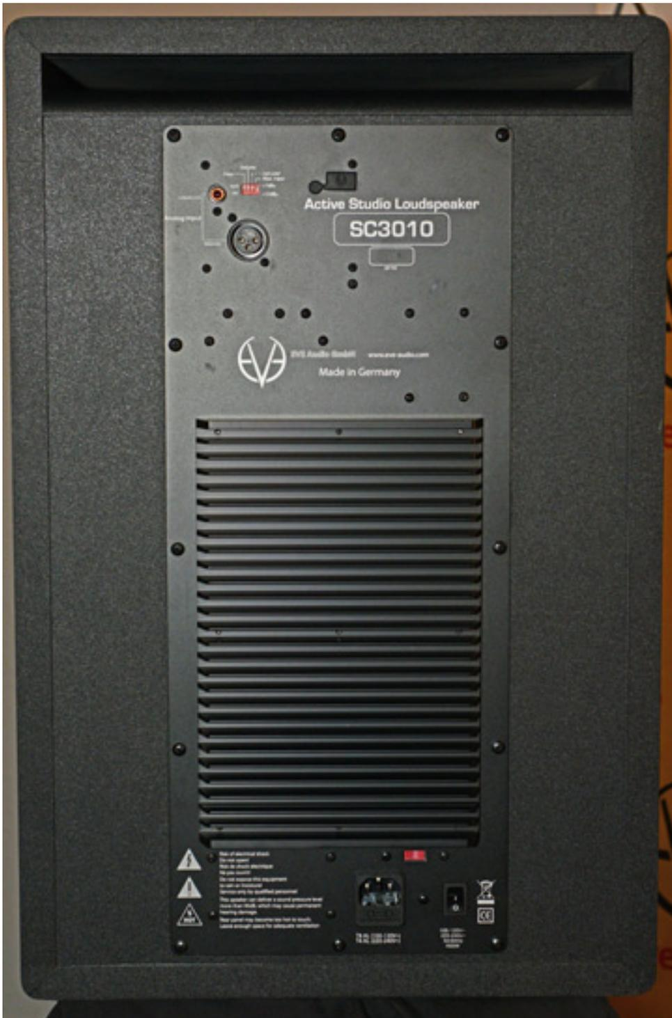
Die beiden analogen Eingänge haben eine Impedanz von 10 Kiloohm. Als Eingang steht entweder eine Cinch- (unsymmetrisch) oder eine 3-polige XLR-Buchse (elektronisch symmetriert) zur Verfügung. Der maximale Eingangspegel lässt sich zwischen +7 und +22 dBu umschalten, was den üblichen nominalen Pegeln -10 dBV, bzw. +4 dBu mit entsprechendem Headroom entspricht.
