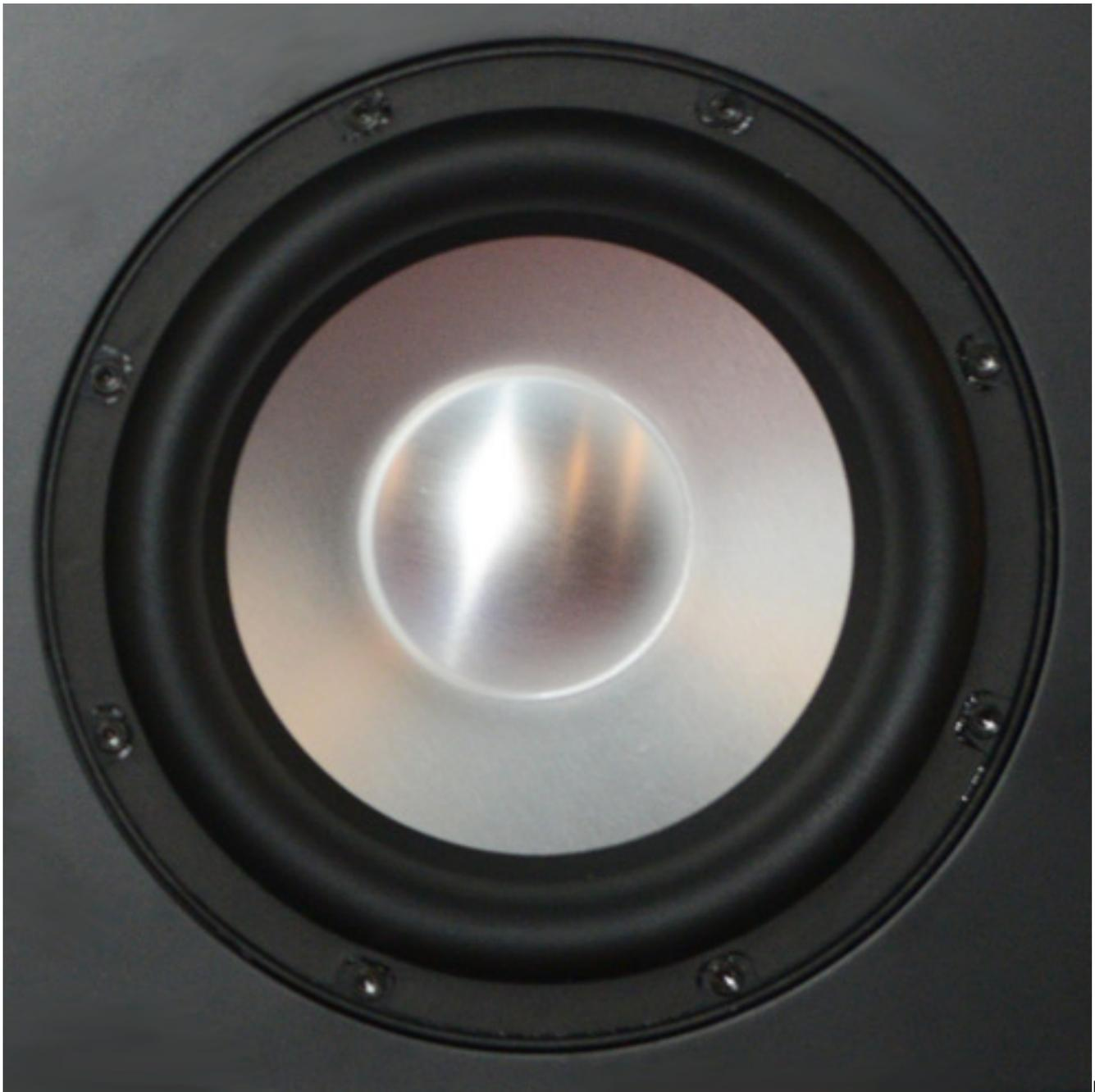
Beim Basstreiber gab es im Sommer 2024 ein Update. Früher kam eine Honeycomb-Membran zum Einsatz die beidseitig mit Glasfaser beschichtet war. Nun wird eine mehrschichtige Aluminium-Membrane verwendet, die mit Kunststoff beschichtet ist, um auftretende Resonanzen tiefer abzustimmen.
