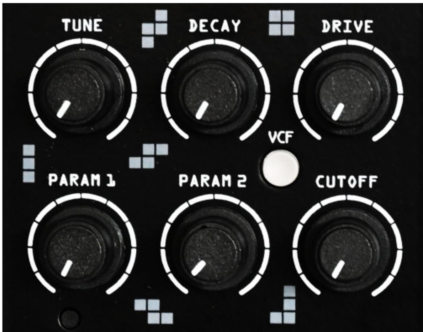
Darunter befinden sich sechs Regler für die Tonhöhe, die Abfallzeit, den Pegel bzw. Drive, Filterfrequenz sowie zwei Parameter die sich je nach gewähltem Algorithmus entsprechend in der Zuordnung ändern. Bei dem Algorithmen A1 bis A3 ist dies zum
