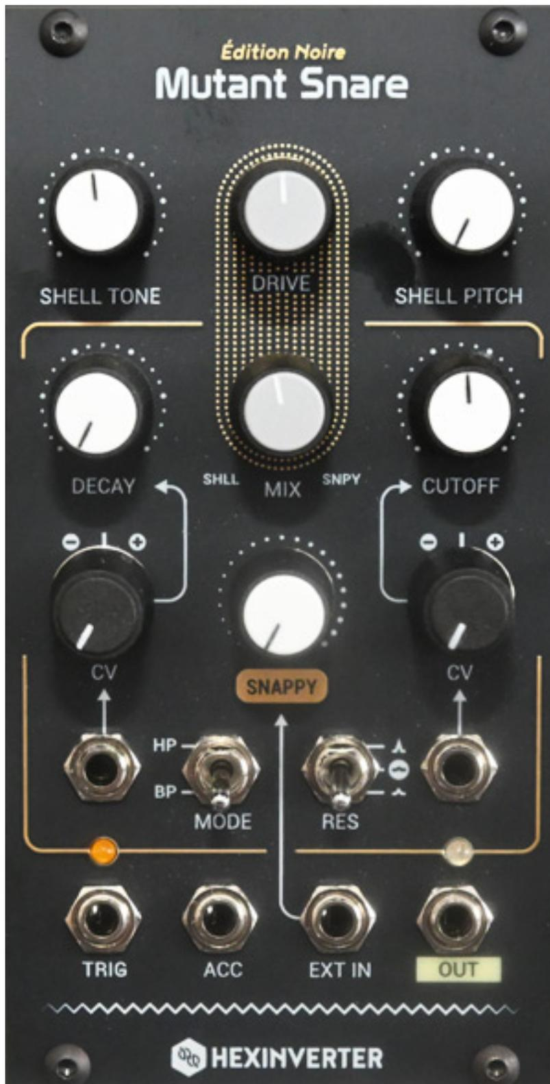
Die "Mutant Snare" orientiert sich wieder konzeptionell an der TR-808. Der Snare-Klang wird durch zwei Sinusoszillatoren (Shell-Komponente) erzeugt, wobei sich einer in der Tonhöhe verstimmen lässt, und einem Rauschgenerator (Snappy-Komponente). Statt dem internen Rauschgenerator lässt sich auch ein externes
