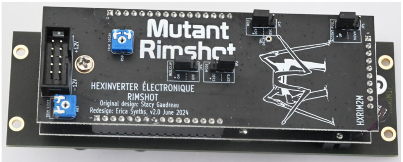
Auf der Rückseite des Moduls Mutant Rimshot befinden sich vier Steckbrücken, womit der Nutzer diverse Vorkonfigurationen durchführen kann. Dazu später mehr.
