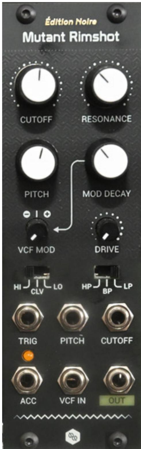
Bis auf das schmalere 8 TE breite Modul "Mutant Rimshot" sind alle Module 13 TE breit. Das Konzept des Moduls "Mutant Rimshot" ist wieder von der TR-909 inspiriert und basiert auf drei Oszillatoren die über einen Impuls und ein angeregtes Bridged-T-Netzwerk gebildet werden sowie ein nachgeschaltetes State-Variable-Filter (umschaltbar Tiefpass, Bandpass und Hochpass) zur Klangformung. Über die Buchse
