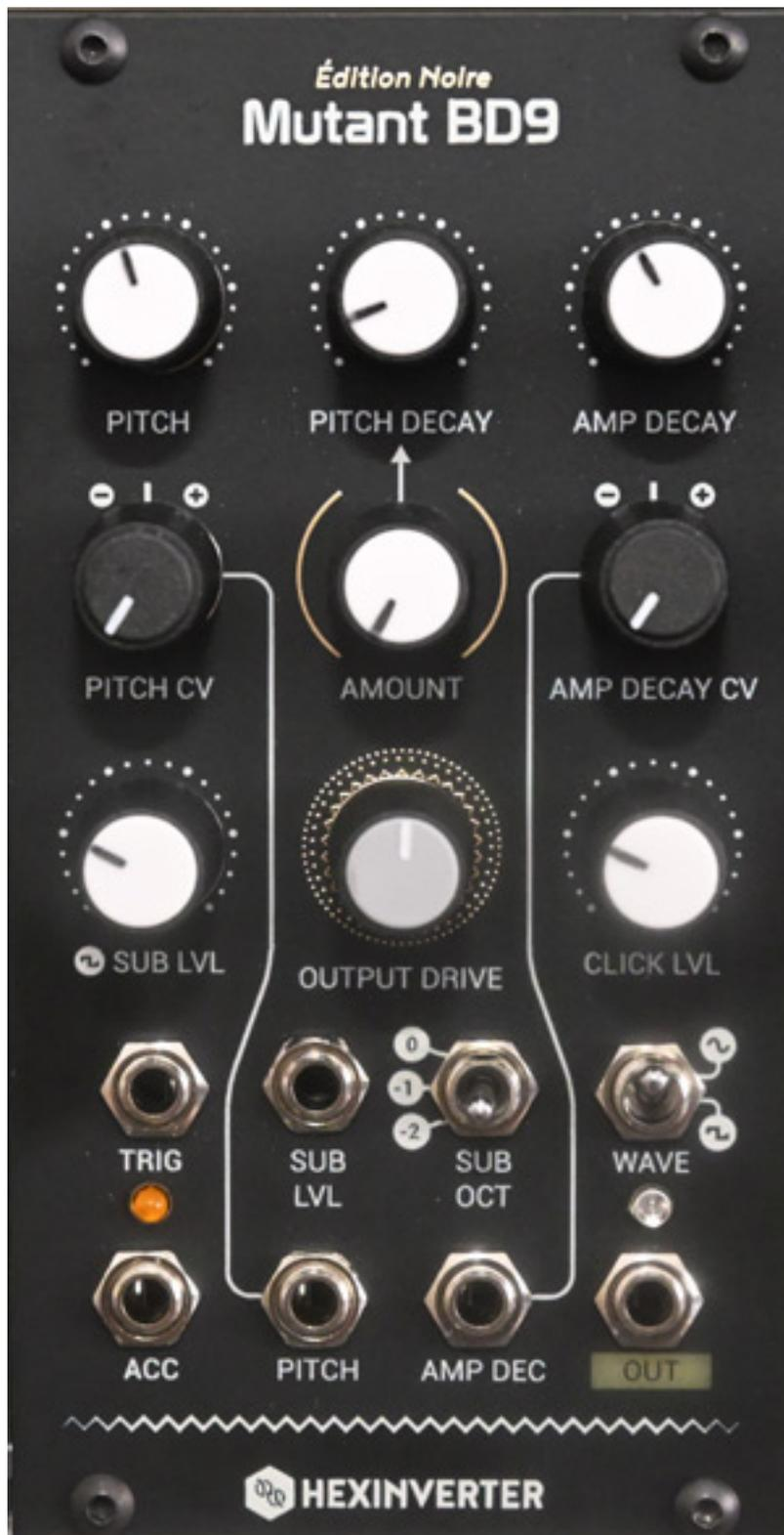
Die "Mutant BD9" Bassdrum ist eine Alternative zu der zuvor vorgestellten "Mutand Bassdrum". Sie orientiert sich an der Bassdrum der TR-909 mit der typischen Sinuswellenform, lässt sich aber auch über den Schalter WAVE auf eine Rechteckwellenform als Signalquelle umschalten. Die Tonhöhe kann im Bereich von 30 bis zu 240 Hz eingestellt werden. Anders als in der Mutand Bassdrum lässt sich
