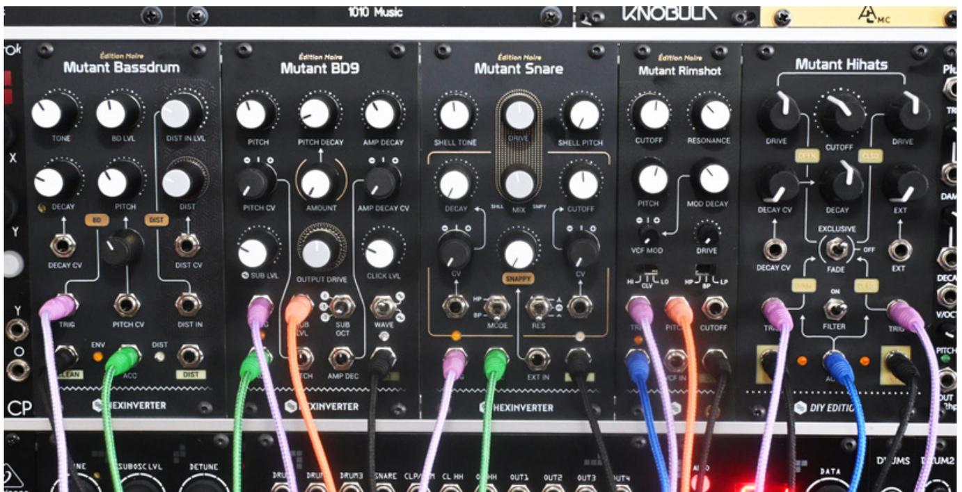
Der Betriebsstrom der Module ist sehr gering. So konnten wir den höchsten Strom bei der Mutant Snare mit 67 mA (+12 V) sowie 62 mA (-12 V) messen. Bei der Mutant Bassdrum waren es sogar lediglich 20 mA (+12 V) und 17 mA (-12 V).
