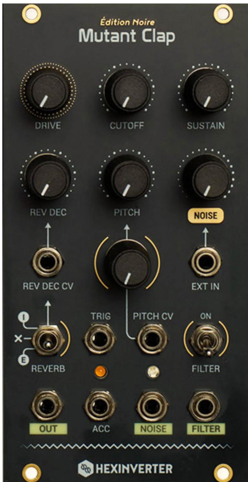
Das Modul "Mutant Claps" hatten wir nicht als Testgerät vorliegen, wollen aber trotzdem noch kurz darauf eingehen. Mutant Claps ist von der TR-909 inspiriert. Einstellen lässt sich die Tonhöhe über PITCH, Filterfrequenz des Bandpass über CUTOFF, Abklingzeit über SUSTAIN sowie Pegel und Verzerrung über DRIVE. Neben Trigger und Akzenteingang sowie Audioausgang OUT lässt sich die Tonhöhe über
