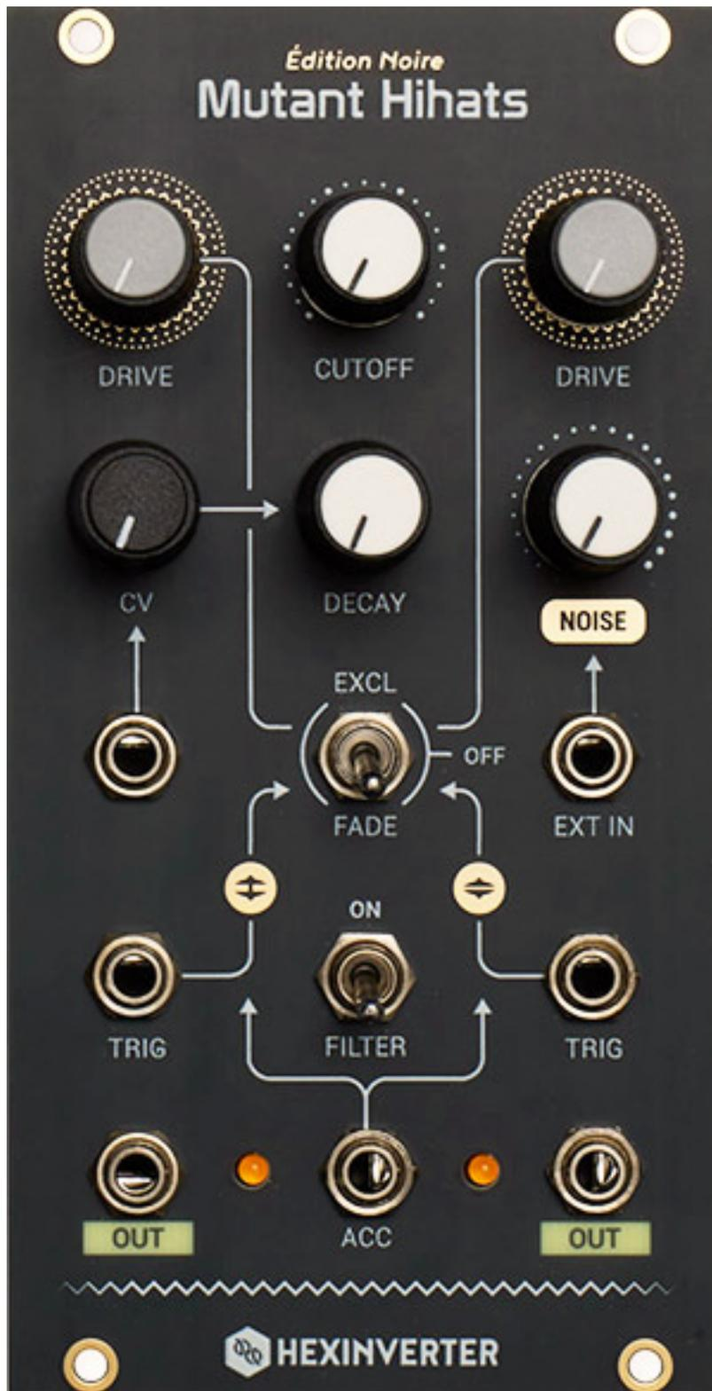
Das Modul "Mutant Hi-Hats" ist in einigen Punkten wieder von der TR-808 inspiriert worden. Statt der Transistoren-basierenden Schaltung der TR-808 werden hier aber modernere Low Noise Opamps bzw. OTAs eingesetzt. Wir haben im Test die Version von Hexinverter und nicht von Erica Synths getestet, da das Modul schon vorhanden war. Vom Klang her gibt es überhaupt keine Unterschiede. Das Modul
