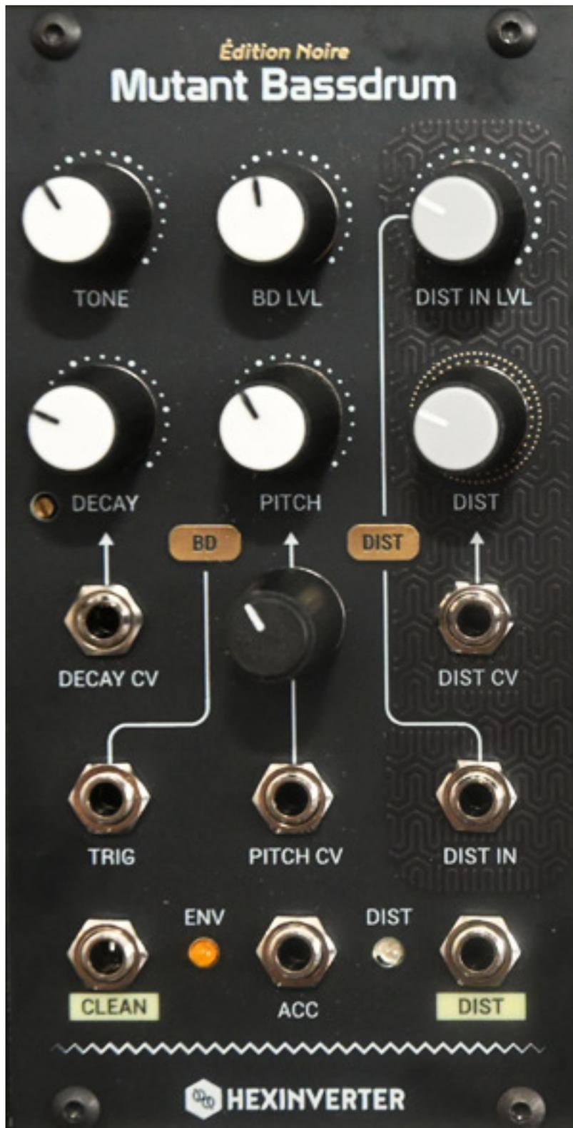
Die "Mutant Bassdrum" basiert auf der Schaltungsidee der TR-808. Ein Puls mit einer Länge von einer Millisekunde wird in ein T-Netzwerk geschickt, bestehend aus Widerständen und einem Kondensator und erzeugt eine in der Amplitude abfallende Sinusschwingung. Bemerkenswert ist bei der Originalschaltung, dass bei einem
