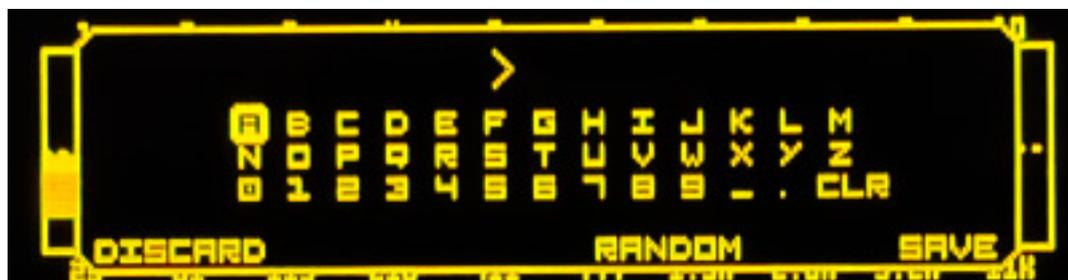
Über das Menü LOAD kann man Presets wieder laden und durch Drücken der Shift-Taste ein Submenü aufrufen, wo man dann Presets umbenennen, in der Reihenfolge verschieben oder löschen kann. Bis zu 128 Presets lassen sich speichern.
