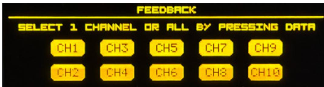
Interessant ist, dass man bestimmen kann welche Filter für die Resonanz-Rückkopplung herangezogen werden. Dies lässt sich über das Feedback-Untermenü global festlegen und zwar entweder alle, keines oder eines der zehn Filterbänder.
