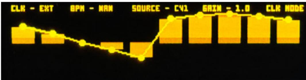
Interessant ist auch der Clock-Modulation-Menü. Hier lässt sich eine Clock-Quelle festlegen (intern/extern), die Geschwindigkeit in BPM bei interner Clock, die Modulations-Eingangswerte (CV1 oder alle) und einen Modulationsgrad. Bei einem eingehenden oder internem Clock-Impuls wird der Eingangswert als Sample & Hold gespeichert und dem aktuellen Filter zugewiesen. Mit jedem Clock-Impuls wird die betreffende Filternummer weiterzählen.
