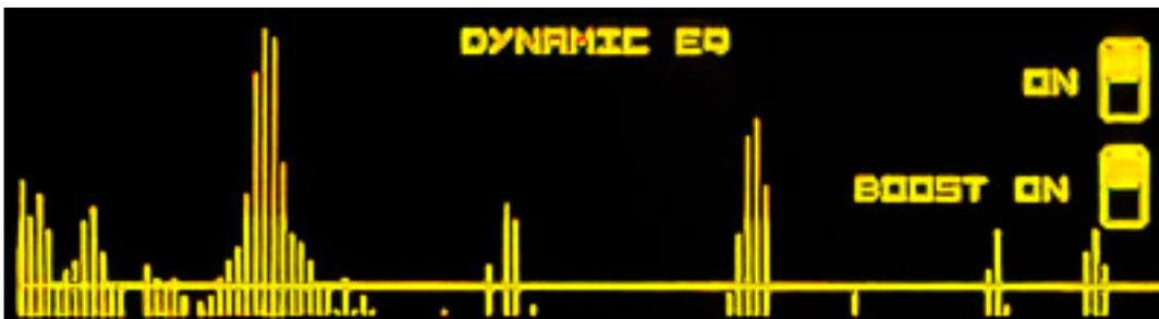
Es gibt auch noch den Dynamic Equalizer Mode, bei dem man Frequenzanteile mindern oder verstärken kann und zwar in Abhängigkeit eines eingestellten Schwellwertes. Der Modus lässt sich komplett deaktivieren und mit BOOST ON verstärkt man die Komponenten die unterhalb des Schwellwertes liegen. Um verstärkte Frequenzkomponenten zu sehen, haben wir für die Abbildung den
