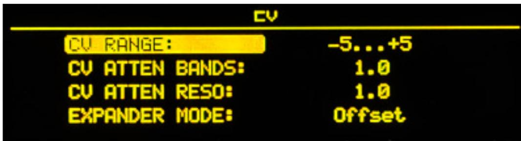
Unter CV kann der Anwender den Spannungsbereich für die Steuerspannung verändern. Hier stehen vier Möglichkeiten zur Auswahl und zwar:
