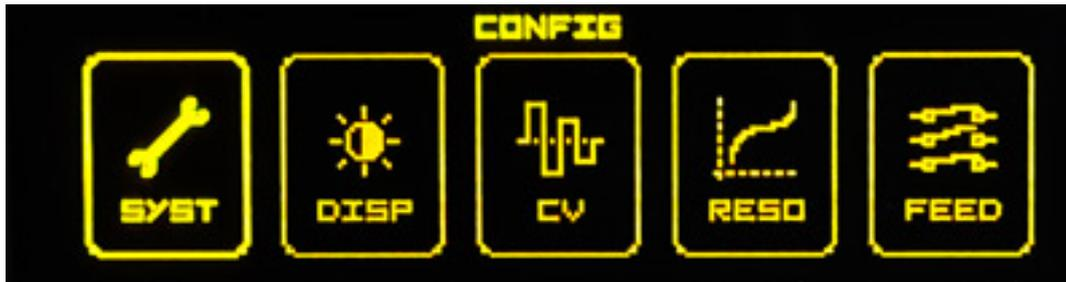
Kommen wir als erstes zum Konfigurationsmenü mit seinen fünf Menüpunkten (s. Abb. oben) für die Einstellung von globalen Modulparametern.
