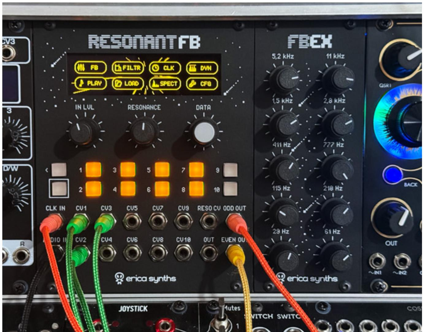
Wir hatten ein Modul mit Firmware 1.2 und hatten die Firmware auf die Version 1.3 aktualisiert. Das Aktualisieren erfolgt über das Einspielen einer Audiodatei, die über die Erica Synths Web-Site bereitgestellt wird. Am besten funktioniert dies, wenn
