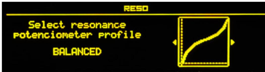
Über RESQ lässt sich die Resonanz-Reglerkurve anpassen. Neben der Standardeinstellung BALANCED (s. Abb. oben), lassen sich verschiedene lineare (linear nur obere, nur untere oder kompletter Regelbereich) und logarithmische Kurven (normal und invertiert) auswählen.
