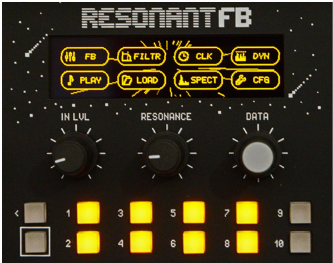
Die Bedienung erfolgt über zwölf Tasten mit LED-Indikatoren, einem Regler für die Anpassung des Eingangspiegels und der Filterresonanz aller Bänder und einem Druck-/Drehgeber für die Menüanwahl und Parametereingabe. Es ist ein monochromes OLED-Display mit einer Größe von 70 x 18 mm verbaut.
