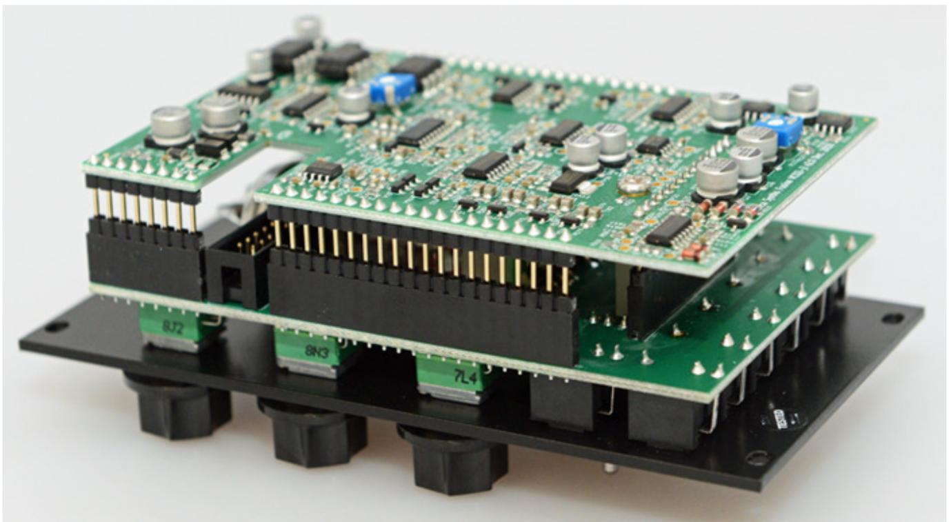
Das Modul besteht aus zwei Platinen im "Sandwich-Verbund" wobei eine im Wesentlichen die Bedienelemente und die andere die eigentliche Oszillator-Elektronik beinhaltet (s. Foto. oben). Zwischen beiden Platinen befindet sich eine kleine Platine mit dem Sockel für die Röhre (s. Abb. unten).
