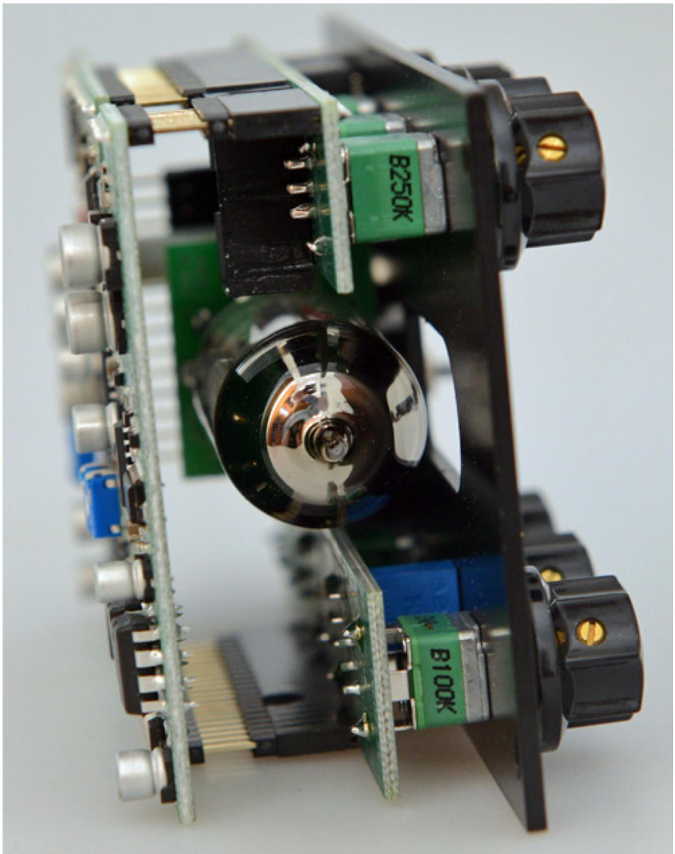
Der VCO selbst basiert auf einem AS3340 Chip, dem modernen Äquivalent des Curtis
