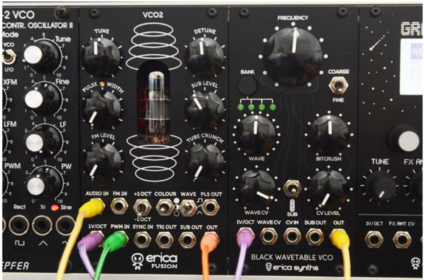
Wir haben bei dem Fusion VCO2 einen Strom von 229 mA bei +12 Volt und 60 mA bei -12 Volt im Mittel, bzw. 315 und 63 mA in der Spitze gemessen. Die Röhre wird im Dauerbetrieb handwarm aber ist durch die Aussparung in der Front ausreichend gekühlt.
