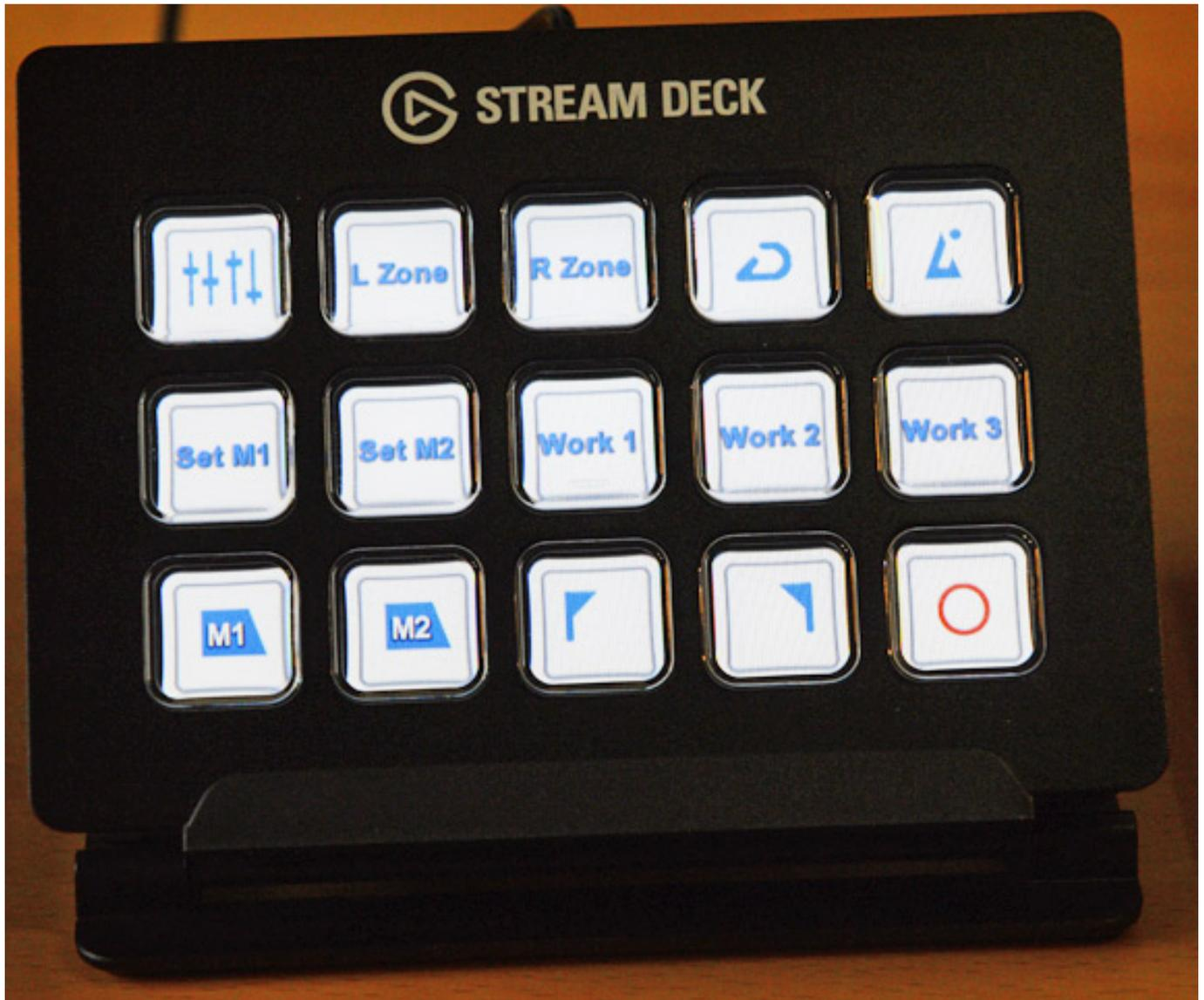
Die Tasten sind auch bei hellem Tageslicht gut ablesbar und für so kleine Tasten ist die Auflösung von 72 x 72 Pixel völlig ausreichend. Wenn man zwischen den Applikationen wechselt, dann wechselt auch die Tastenbelegung entsprechend den Profilen. Bei sehr vielen Programmwechseln hatten wir manchmal das Problem, dass ein Programmwechsel nicht das richtige Profil anspricht. In der Regel wird man die Tastatur aber sowieso nur für ein Profil verwenden.
