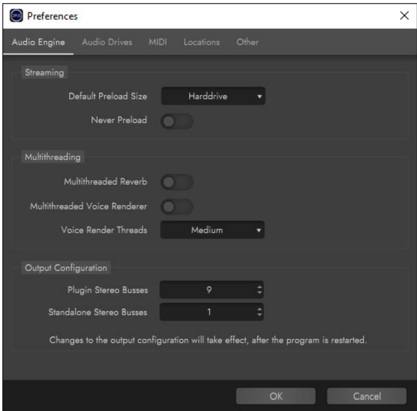
Das Sample-Ladeverhalten lässt sich in der Konfiguration zwischen Harddisk und SATA SSD sowie PCIe SSD umschalten. Mehr dazu im Abschnitt Praxis. Auch Einstellungen zum Multithreading und zur Busanzahl (s. Abb. oben) sind möglich.
