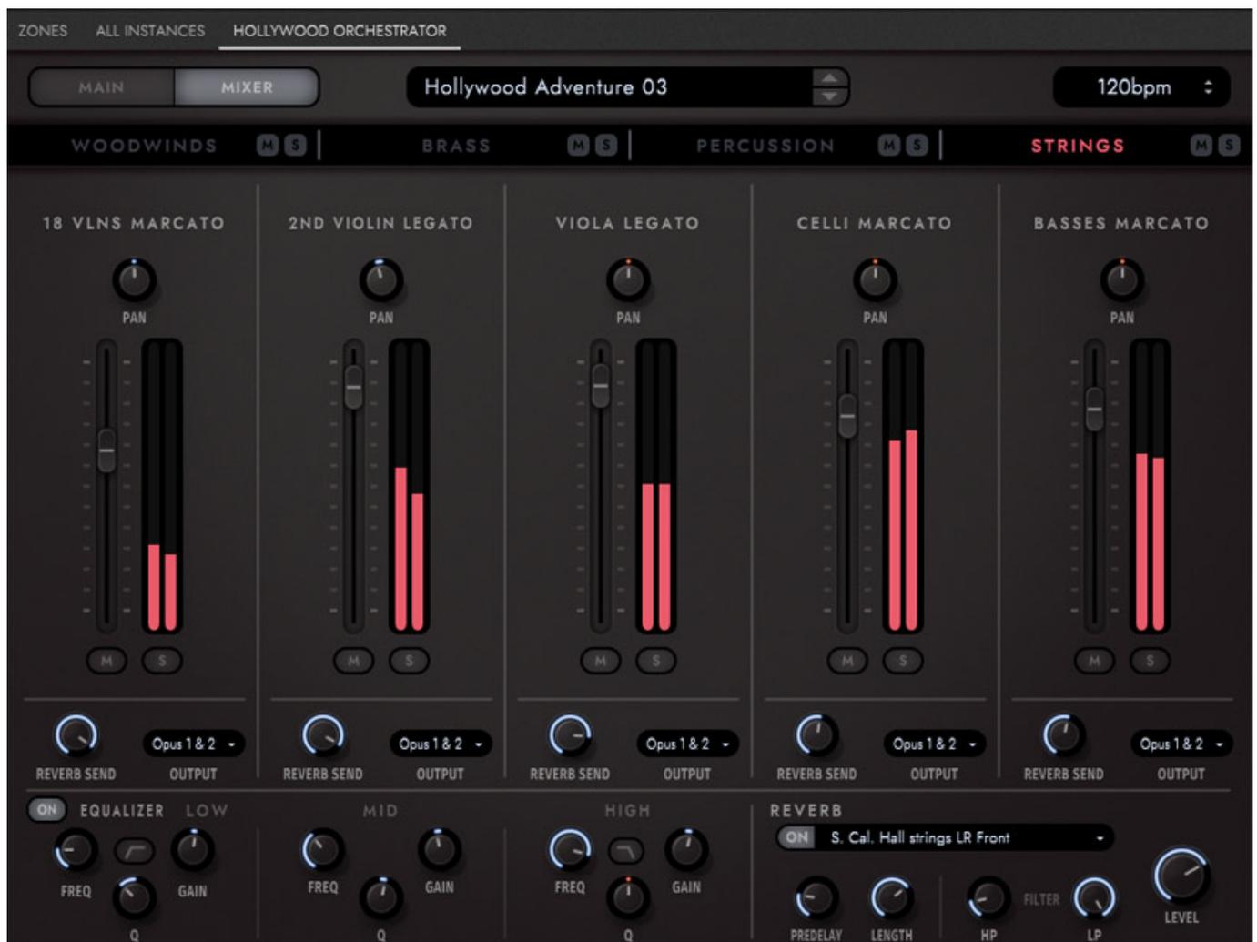
Auch hier gibt es eine Mixer-Ansicht mit einer etwas einfacherer gestalteten Effektsektion, bestehend aus einem dreiband-Master-EQ sowie einem Hall welches sich über ein Reverb-Send-Parameter individuell pro Kanal anpassen lässt (s. Abb. oben).
