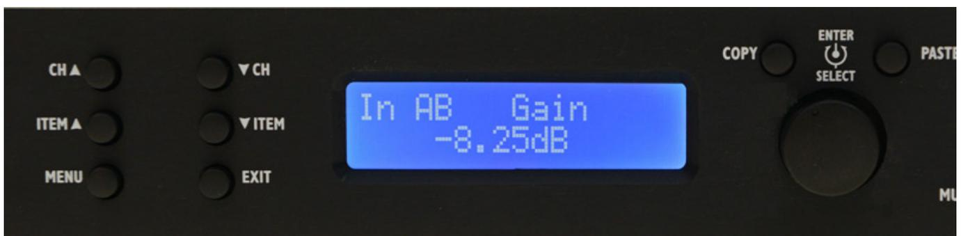
Die Bedienung an der Gerätefront erfolgt über Plus-Minus-Tasten für Kanal (CH) und Parameter (ITEM) sowie noch ein Taster für das Aufrufen des Menüs sowie ein Exit-Taster zum Verlassen der aktuellen Menüebene. An dem Druck/Drehgeber sind noch Copy/Paste-Tasten zum Übernehmen von Parametern zu finden. Durch Drücken auf den Drehgeber erfolgt die Eingabebestätigung und nach Drücken der Enter-Taste
