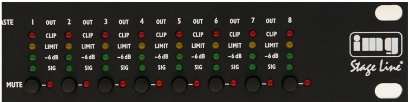
Auf der rechten Geräteseite befinden sich die Pegelindikatoren für die Ausgänge (s. Abb. oben) und des Weiteren pro Kanal noch ein Mute-Druckschalter mit LED als Aktivitätsindikator.
