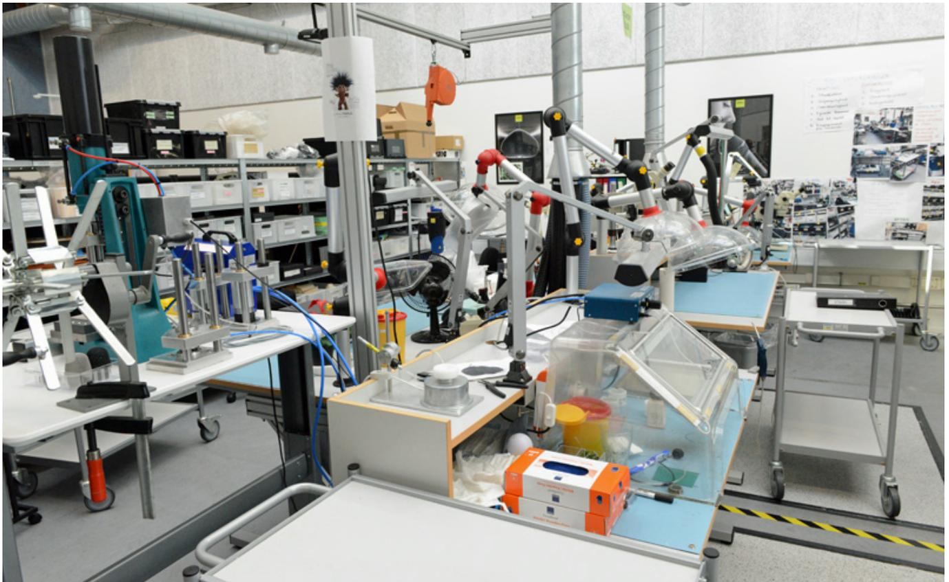
DPA hat sich ja auf die Herstellung von Miniaturmikrofonen spezialisiert. Dies erfordert natürlich auch spezielle Fertigungsmethoden. Der Anteil von Handarbeit ist hier relativ hoch. Die Bestückung der elektronischen Bauelemente kann zum Teil nur unter Zuhilfenahme von optischen Geräten wie Lupen oder Mikroskopen montiert werden.
