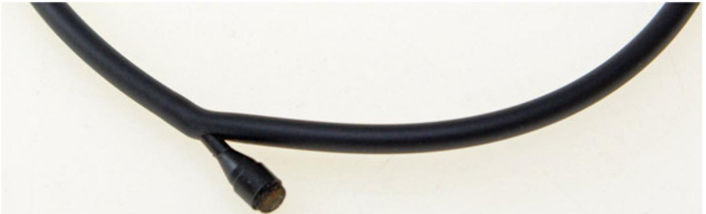
Die d:screet Mikrofone gibt es ja sowohl mit Kugel-, als auch mit Nierenrichtcharakteristik. Letzteres macht bei einem am Hals getragenen Mikrofon keinen Sinn. Daher kommt eine Kapsel mit Druckempfänger zum Einsatz, die eine Kugelrichtcharakteristik bietet, nämlich die d:screet 4061. Diese Kapsel zeichnet sich durch einen extremen maximalen Schalldruck von 144 dB und großen Dynamikumfang von 97 dB aus.
