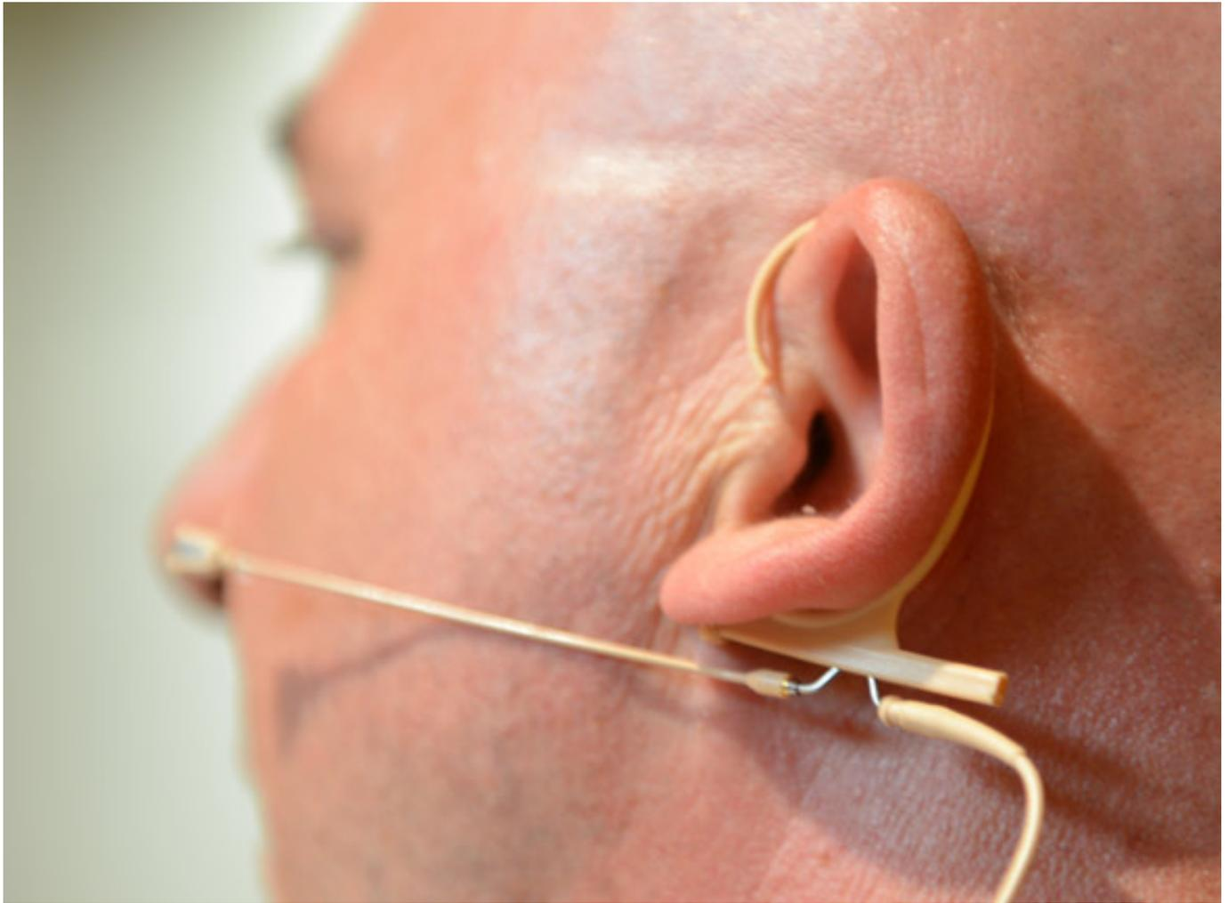
Die obere Plastikwindung wird dann um das Ohr herum gelegt. Hört sich kompliziert an aber wenn man es einmal gesehen hat ist es total simpel und nicht nur das: die Befestigung am Ohr ist überraschend stabil und fixiert und das auch bei dem Einohrmodell. Das Plastikteil auf dem Kabelendstück lässt sich übrigens auch um ca. 40 mm verschieben und so kann den Mikrofonabstand also nach vorne oder hinten angepasst werden.
