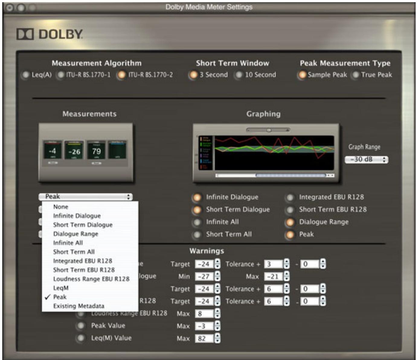
Im oberen Teil wird der Messalgorithmus, die Short-Term-Zeitfenstergröße sowie der Peak-Sample-Messtyp ausgewählt. Es gibt vier Fenster für die numerische Messwertdarstellung, deren Typ mittels eines Pull-Down-Menüs ausgewählt werden kann. Daneben befinden sich die Einstellungen für die grafische Darstellung. Im unteren Teil des Fensters kann der Benutzer verschiedene Warn-Parameter einstellen.
