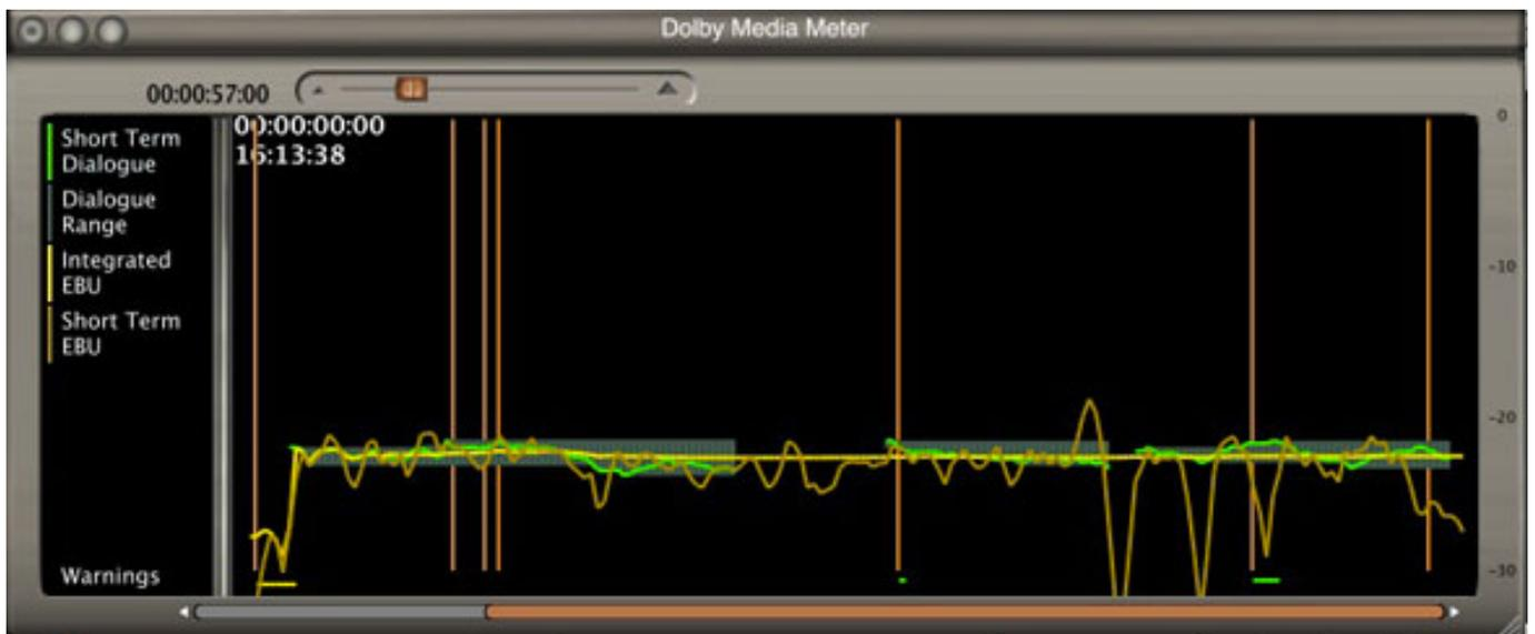
Die Besonderheit des Dolby Media Meter 2 ist die Integration des Dolby Dialogue Intelligence -Verfahrens aus dem Dolby DP 600. Diese Technologie detektiert Sprache innerhalb eines Audio-Tracks und stellt den Lautheitsverlauf dar. Wie man an obigem Beispiel sehen kann, wird der Dialog erkannt, die Dialoglautheit sowie
