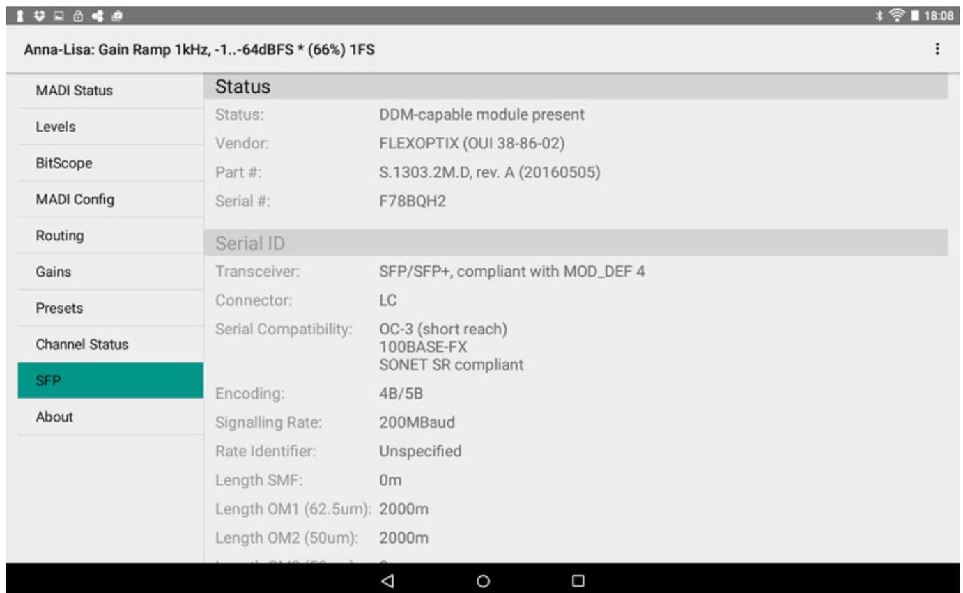
Über "SFP" kann man den Status der optischen Schnittstelle, bzw. des SFP-Moduls aufrufen (s. Abb. oben)
