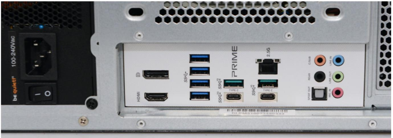
Die Anschlüsse des Motherboards bieten noch ein 2,5-G-Ethernet-Port, sowie sechs USB-A-Ports (USB 3.2 Gen 1 und blau gekennzeichnet mit 5 bzw. grün mit 10 MBit/s) mit unterschiedlicher Geschwindigkeit und noch zwei USB-C-Anschlüsse (USB 3.2 Gen 1 mit 10, bzw. 20 MBit/s). Insgesamt hinten also 13 USB-Ports am gesamten Rechner.
