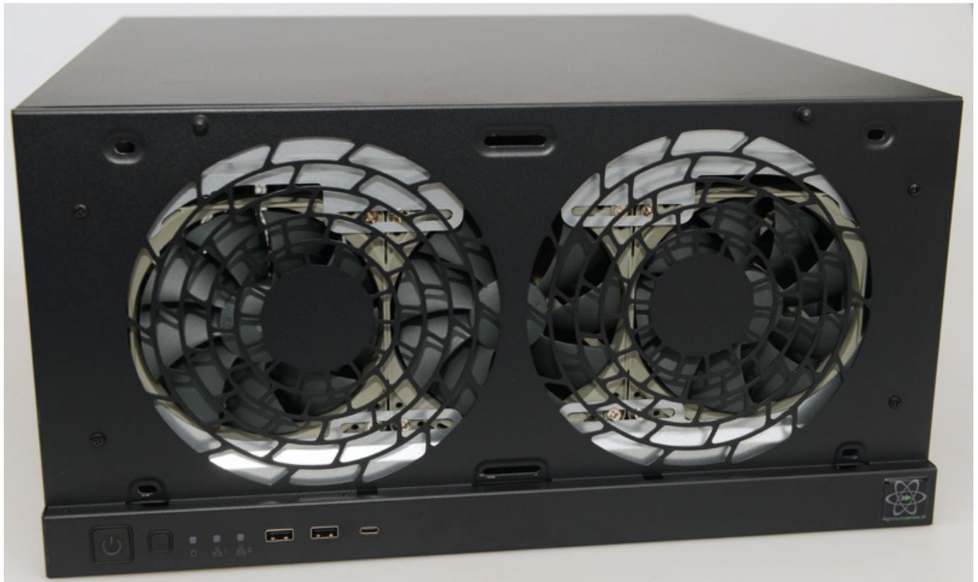
Das Frontgitter ist abnehmbar und man sieht dann die vorderen drei 120 mm REDUX-Lüfter. Ein weiterer Lüfter befindet sich auf der Rückseite des Gehäuses.
