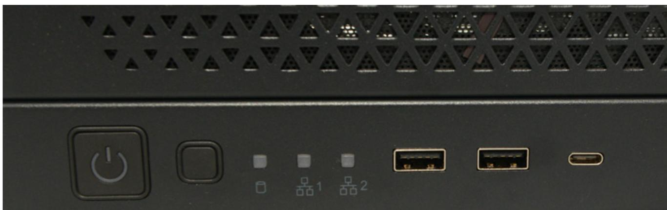
Bedienungselemente auf der Frontplatte sind nur wenige zu finden. Neben dem Ein/Aus-Taster noch ein Reset-Taster sowie Statusanzeigen für Laufwerksaktivitäten und Netzwerke. Daneben sind noch zwei USB-A- (USB 3.0 mit 5 GBit/s) und ein USB-C-Anschlüsse (USB 3, 5 GBit/s) auf der Frontplatte vorhanden.
