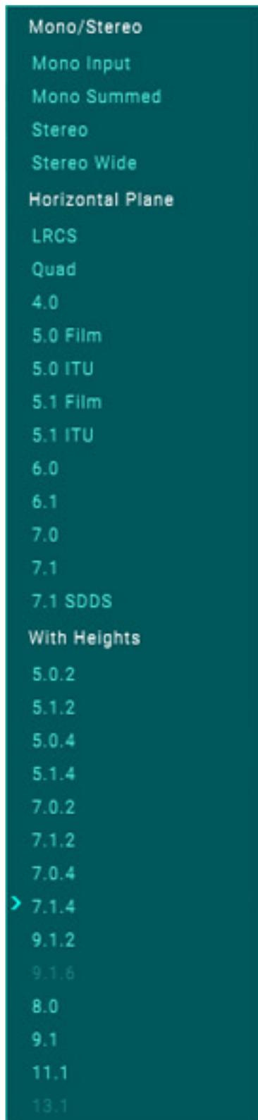
Es lassen unter SPEAKER SETUP insgesamt 30 verschiedene Audioformater als Eingangsformat anwählen. Über der Auswahl ist ein kleiner Bereich in dem das Plug-In auf BYPASS geschaltet werden und der Eingangspegel lässt sich hier auch anpassen.
