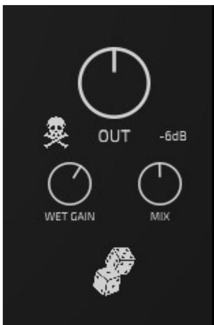
Auf der rechten Seite befindet sich der Ausgangspegel-Regler sowie Regler für den Effektpegel und das Pegelverhältnis Original/Effekt. Über das Würfel Icon kann man zufällige Einstellungen herbeiführen, falls es an temporärer Kreativität mangelt und der Totenkopf ist der Panik-Taster um die DSP-Engine zurückzusetzen.
