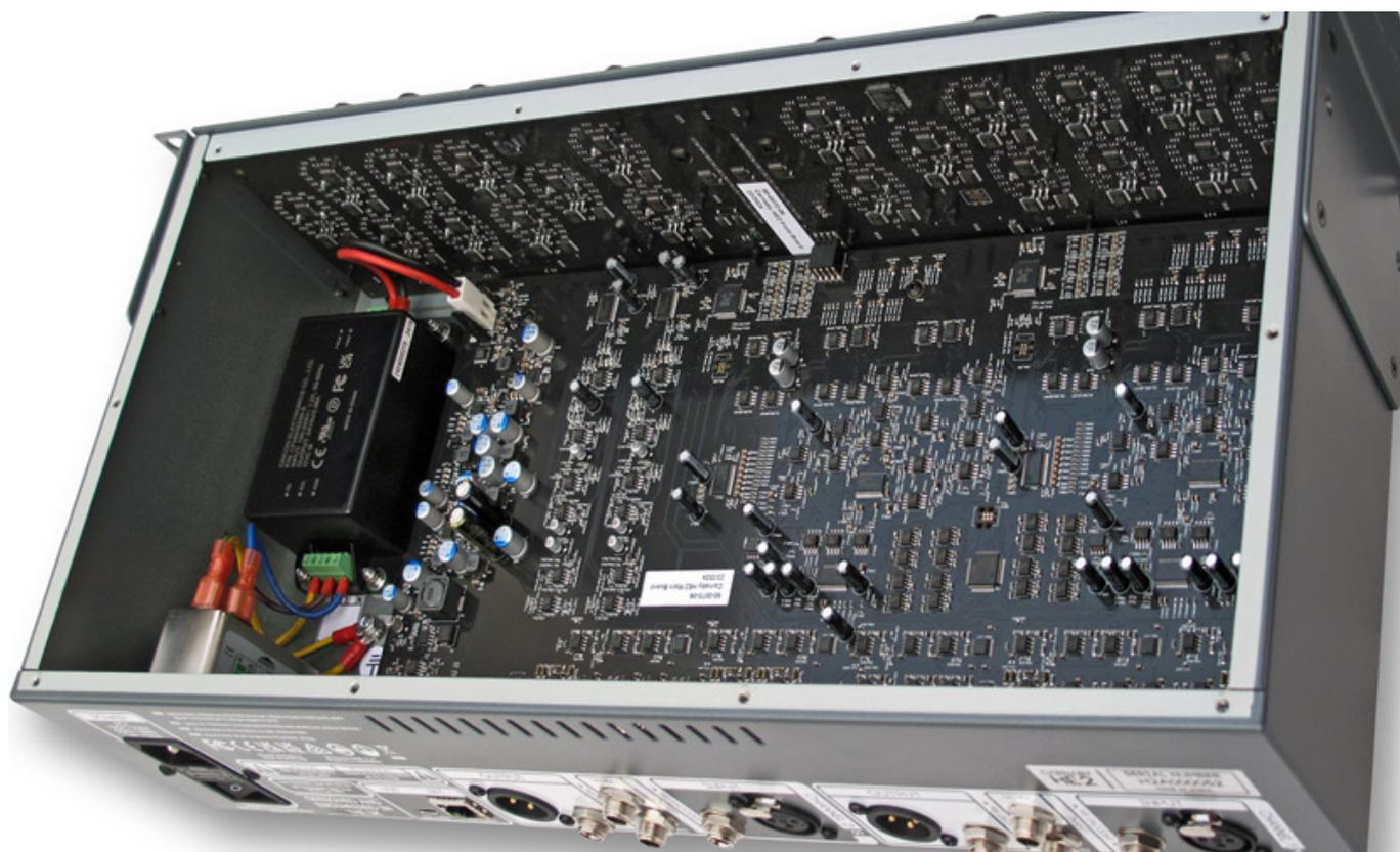
Wer vermutet, im Carnaby HE2 befänden sich einfach nur zwei Boards des 500er Moduls plus etwas Peripherie, hat weit gefehlt: Der HE2 besitzt rundum neu konstruierte Boards mit reichlich hochwertiger Elektronik. Laut Hersteller ermöglicht diese Lösung eine bessere Audioperformance und eine einfachere Integration der digitalen Steuerung. Zudem verringern sich die Herstellungskosten bei Verwendung einer Einzelplatine.
