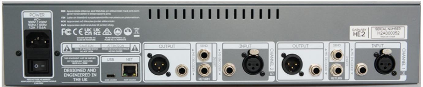
Vervollständigt wird die Ausstattung durch XLR In/Outs, Stereo-Klinken für den Insert-Weg sowie ein internes Netzteil mit Schalter und zusätzlichem An/Aus-Taster.
