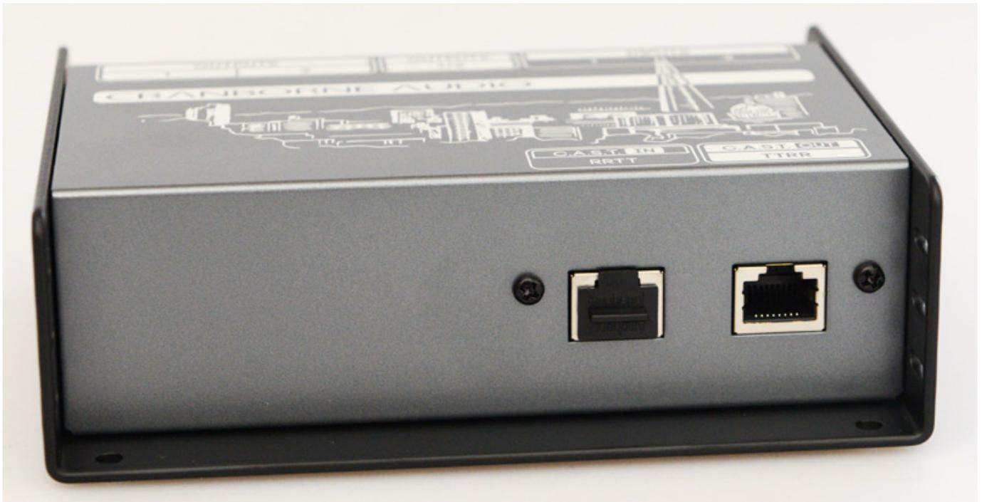
Ein N22-Interface (s. Abb. oben und unten) verfügt über zwei C.A.S.T. RJ-45 Ports sowie zwei symmetrische analoge XLR-Ein- und jeweils zwei XLR- und 6,3-mm-Klinkenbuchsen-Ausgänge. Es gibt übrigens noch das Modell N22H, welches über einen integrierten Kopfhörerverstärker verfügt. Über einen Umschalter lässt sich wählen ob man den C.A.S.T.-Bus oder den analogen 1/2 Eingang abhören möchte. Auch eine Umschaltung Kono/Stereo ist hier vorgesehen.
