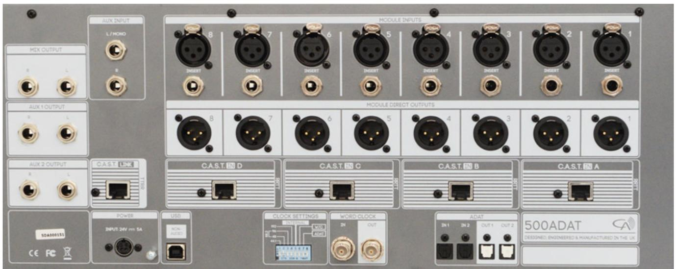
Darüber hinaus gibt es noch vier RJ-45-Buchsen für die Nutzung der C.A.S.T. Interface-Module von Cranborne Audio. C.A.S.T. ist ein Audio-Snake-System basierend auf CAT-5-Kabelverbindungen. Es lassen sich so vier N22-Module anschließen um Audio über C.A.S.T. anzubinden. Es liegen immer ein Kanalpaare auf den C.A.S.T.-Buchsen (A ... D) des 500ADAT auf.
