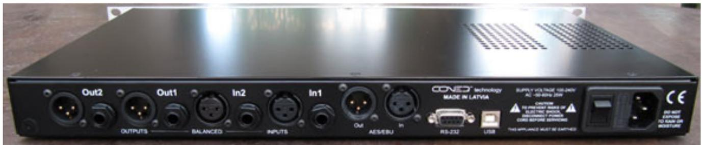
Nun zu den Audio-Anschlüssen, die sowohl als XLR- als auch als 6,3-mm-Klinkenbuchsen ausgeführt sind. Zwei Ein- und Ausgänge stehen zur Verfügung und zwar analog wie auch digital via AES/EBU (XLR-Buchsen). Eine USB- und einen RS-232-Verbindung sorgen für die Kommunikation mit Software.
