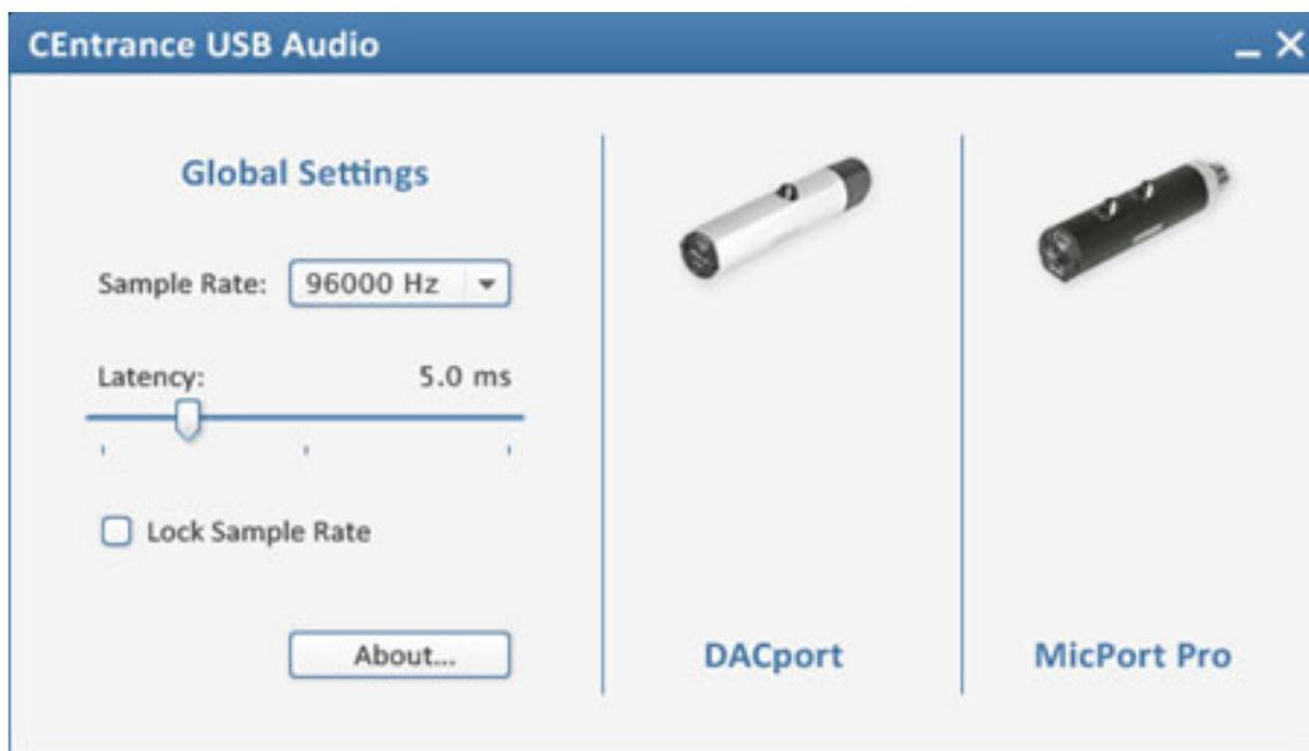
Ein wesentlicher Punkt ist, dass mit den Devices eine Audio-Wortbreite von 16 oder 24 Bit und Abtastraten von bis zu 96 kHz unterstützt werden. Die Latenzzeit lässt sich im Control-Fenster einstellen (siehe oben). Auf der Web-Site von Centrance gibt es auch noch eine Software zur Ermittlung und Optimierung der Latenz. Ein weiterer interessanter Punkt ist, dass mit zwei Devices auch wirklicher
