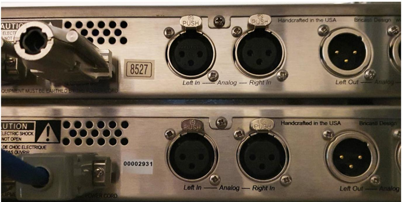
Links außen befindet sich ein dreipoliger IEC-Netzstecker für das interne Netzteil mit aktiver Luftkühlung, dass 120 bis 240 Volt mit 50 oder 60 Hz verarbeiten kann und daher weltweit on Tour wie im Studio die korrekte Stromversorgung sicherstellt. Der
