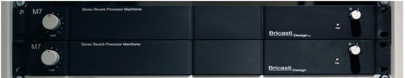
Das 1-HE-Gehäuse besteht mit der aus gefrästen Aluminium Frontplatte aus rostfreiem Edelstahl, dass sich mit einem Gewicht von ca. 4,0 kg und einer Tiefe von ca. 28 cm im Rack bemerkbar macht. Zwei Bedienelemente sind frontseitig mittels Aluminium-Drehreglern angebracht: Input-Gain-Regler links, Drehschalter mit roter Power-LED zum Ein- und Ausschalten rechts. Alle Anschlüsse sind rückseitig sauber ausgeführt und fest mit der Rückseite des Effektgerätes verschraubt.
