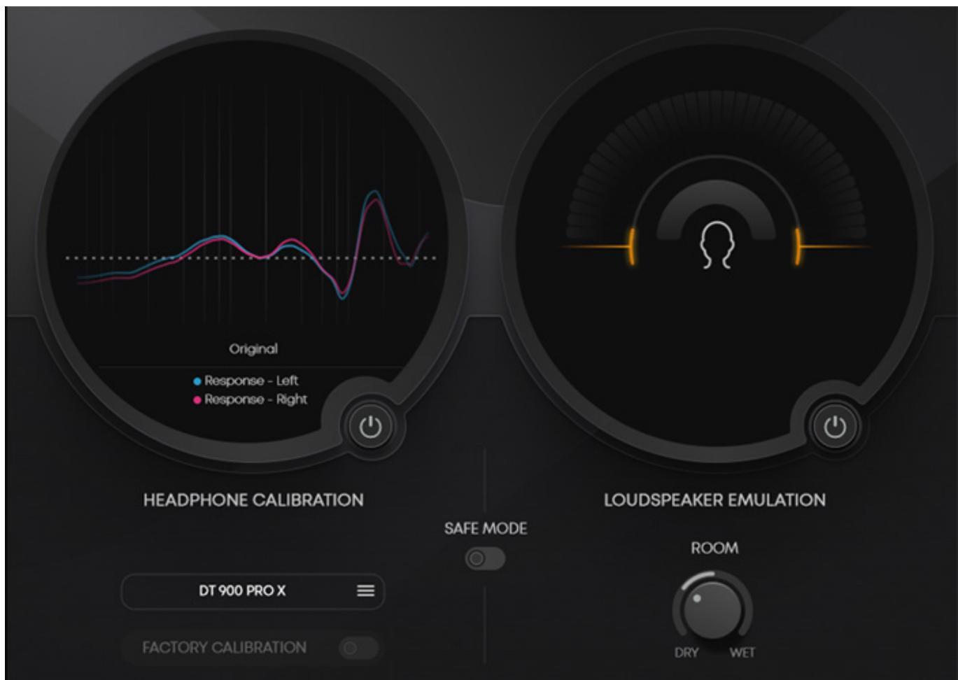
Schauen wir uns die einzelnen Möglichkeiten der Kalibrierung per Plug-In einmal an. Wenn die Kalibrierungsfunktionen ausgeschaltet sind, wird das Übertragungsverhalten angezeigt und bei den Kopfhörern deren Profil bei der Herstellung hinterlegt sind, auch individuell für den linken und rechten Kanal. Bei den anderen Kopfhörern, ohne hinterlegtem Profil, wird eine gemittelte Kurve genutzt.
