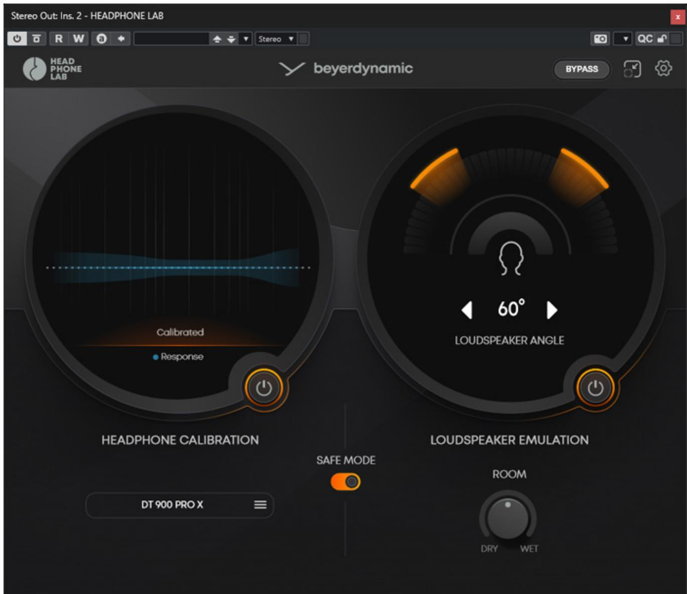
Im Januar 2026 stellte beyerdynamic auf der NAMM mit HEADPHONE LAB ein Plug-In für seine Kopfhörer vor, dass kostenlos von der beyerdynamic Web-Site heruntergeladen werden kann. Das Plug-In dient der Kalibrierung des Übertragungsbereichs und bietet eine Lautsprecher-/Studio-Simulation.
