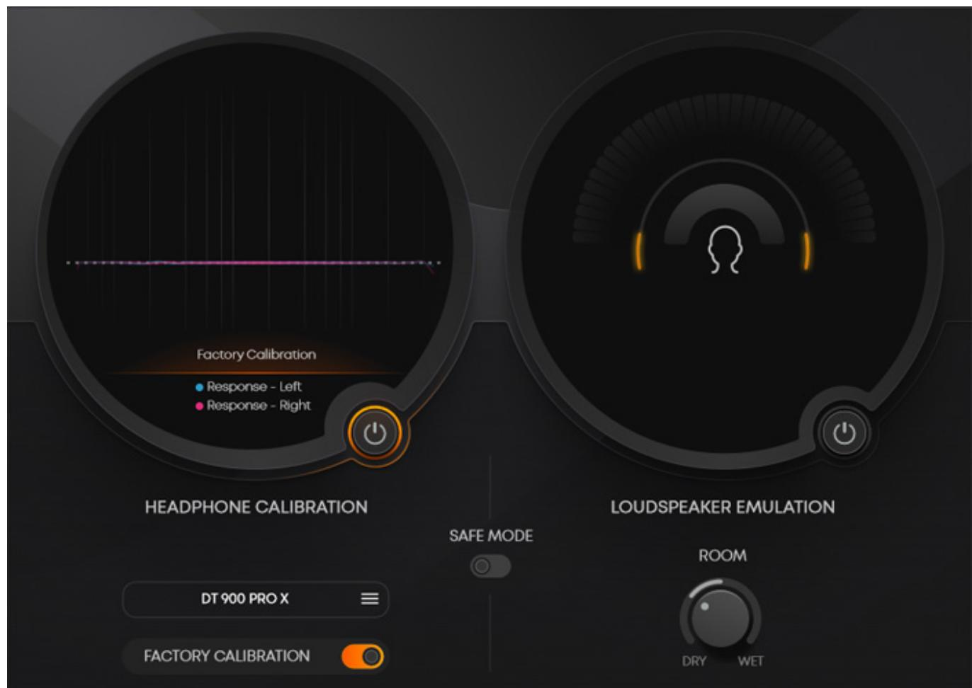
Über die zuschaltbare Funktion FACTORY CALIBRATION werden dann auch die individuellen Unterschiede einzelner Kopfhörer auf eine Zielkurve hin korrigiert.
