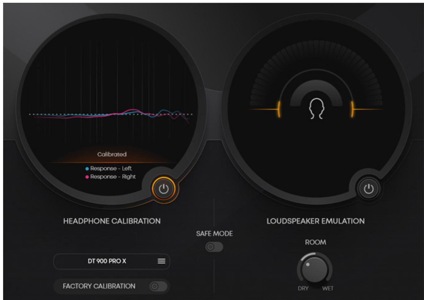
Schaltet man die Kopfhörerkalibrierung ein so wird der grundlegende Frequenzgang für das ausgewählte Modell korrigiert (s. Abb. oben).
