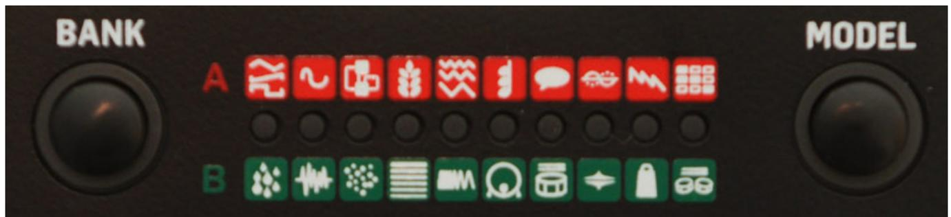
Nun einmal zu den einzelnen Modellen in den beiden Bänken A und B. Die LEDs zeigen das angewählte Modell und die Farbe der LED (rot/grün) die Bank an. Die Modelle sind etwas anders angeordnet als bei Plaits, da ja vier neue Synthesemodelle hinzugekommen sind.
