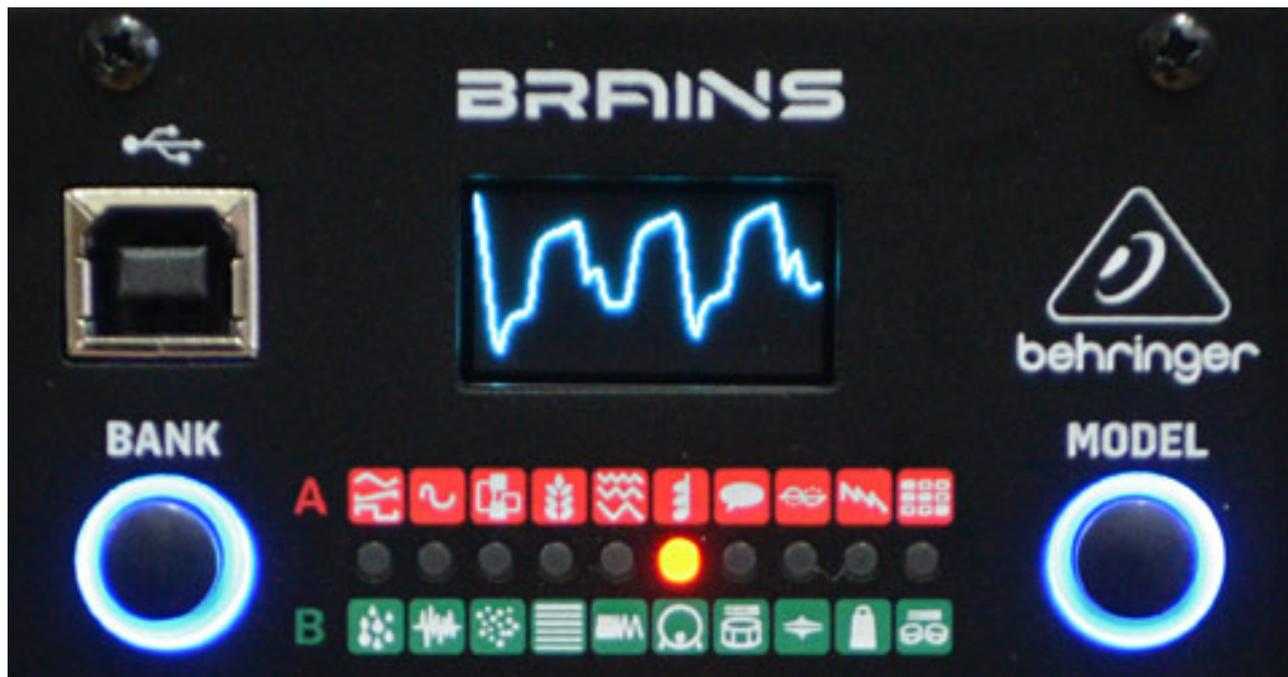
Die Bedienung bei der Auswahl der Bänke und Synthese-Modelle ist sehr ähnlich dem Plaits, nur dass die Anordnung der Tasten und LEDs in der horizontalen Ebene ausgerichtet ist, damit oben noch Platz für den USB-Port und dem OLED-Display ist (s. Abb. oben).
