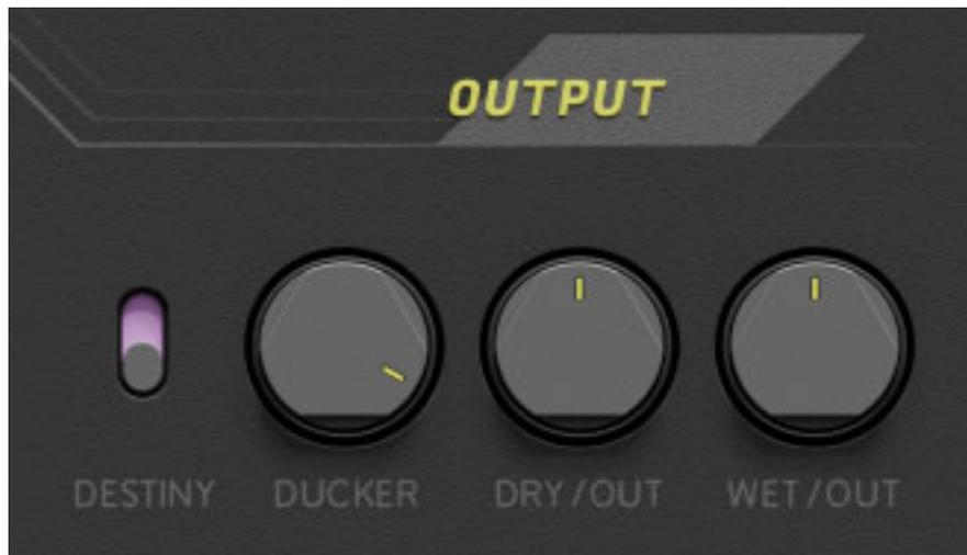
Zu guter Letzt gibt es die Sektion OUTPUT. Mit dem DESTINY-Schalter, der bei Aktivierung für ein natürlicheren, weniger technischen Sound sorgen soll. Es gibt keinen Dry/Wet-Regler sondern Dry- und Wet-Pegel lassen sich getrennt einstellen. Mit dem Ducker kann man das Originalsignal mehr fokussieren, da beim Vorhandensein eines Signals am Eingang das Echosignal unterdrückt wird. Mit dem Regler kann man einstellen, wie stark dies erfolgen soll.
