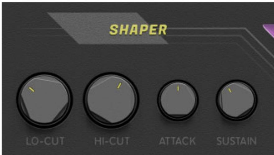
Über die Sektion SHAPER kann man den Übertragungsbereich des Echoeffektes über einen Tiefpass (HI-CUT) und Hochpass (LO-CUT) einschränken. Dazu gibt es einen Transienten-Prozessor mit Kompressorfunktion, dessen zeitliches Verhalten sich über ATTACK und SUSTAIN einstellen lässt. Sustain ergibt bei sehr hohen Werten eine am Ende eine deutliche Rauschfahne. Daher muss man mit dem Wert etwas vorsichtig umgehen.
