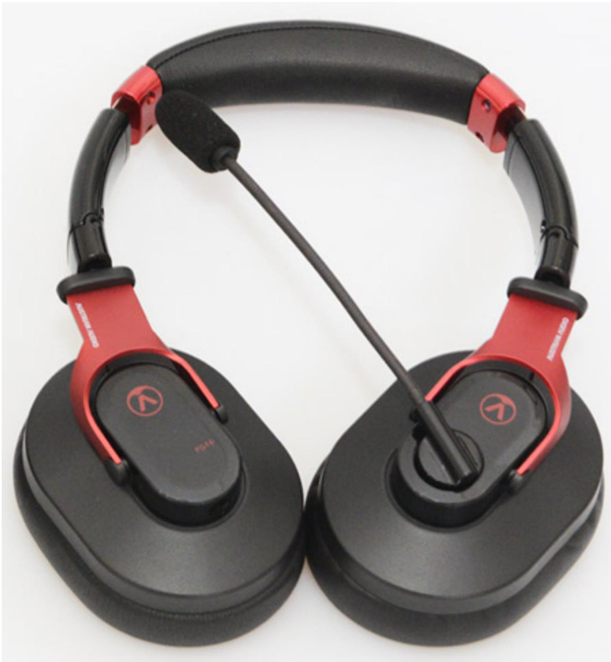
Praktisch ist auch, dass sich die Hörer so falten lassen, dass man sie auf einem Tisch ablegen (s. Abb. oben) oder dass sie für den Transport zusammenfaltet kann (s. Abb. unten). Auch das ist ein Merkmal aller Kopfhörer von Austrian Audio.
