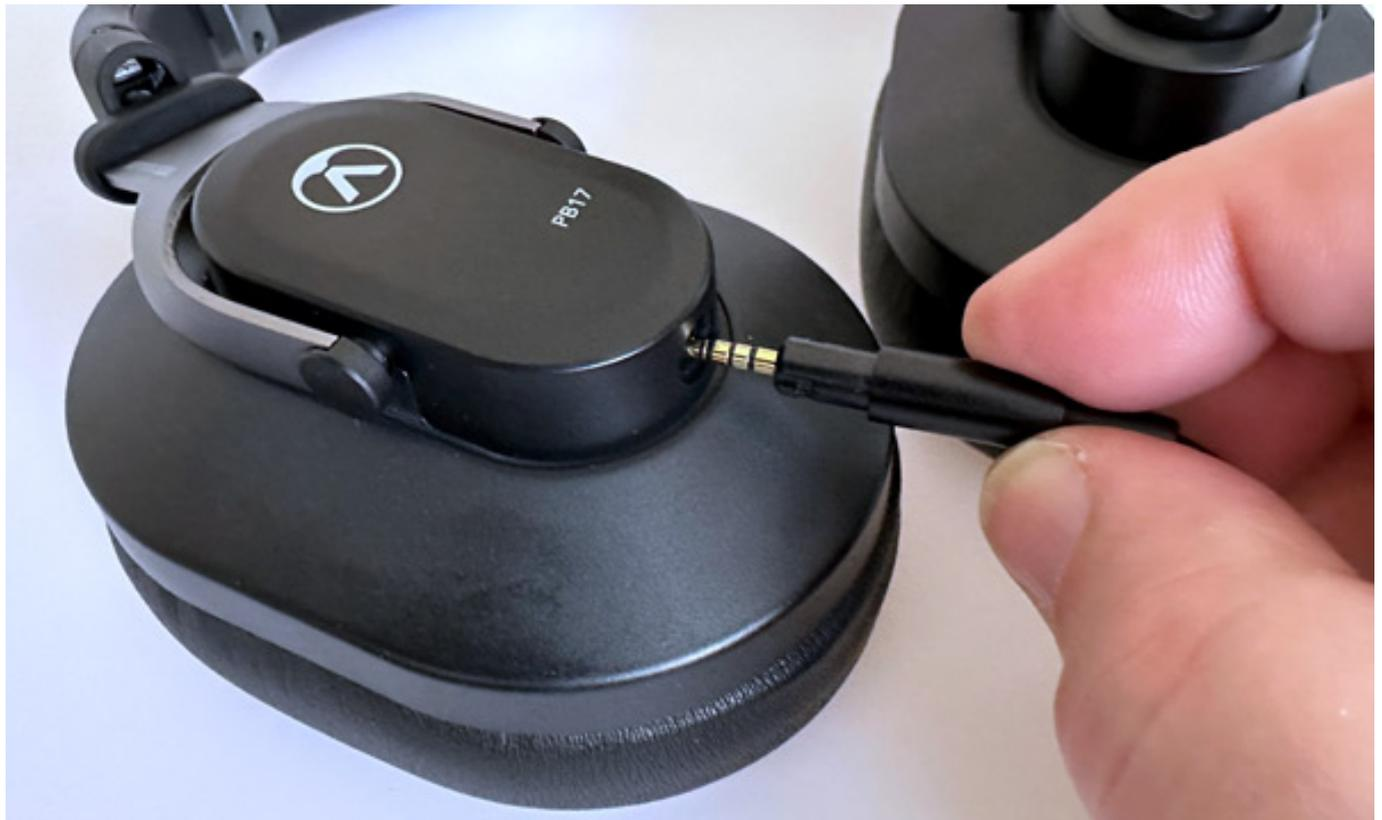
Angeschlossen wird der Kopfhörer auf einer Seite mittels einem vierpoligem 2,5-mm-TRRS-Stecker, der sich durch Drehen arretieren lässt.
