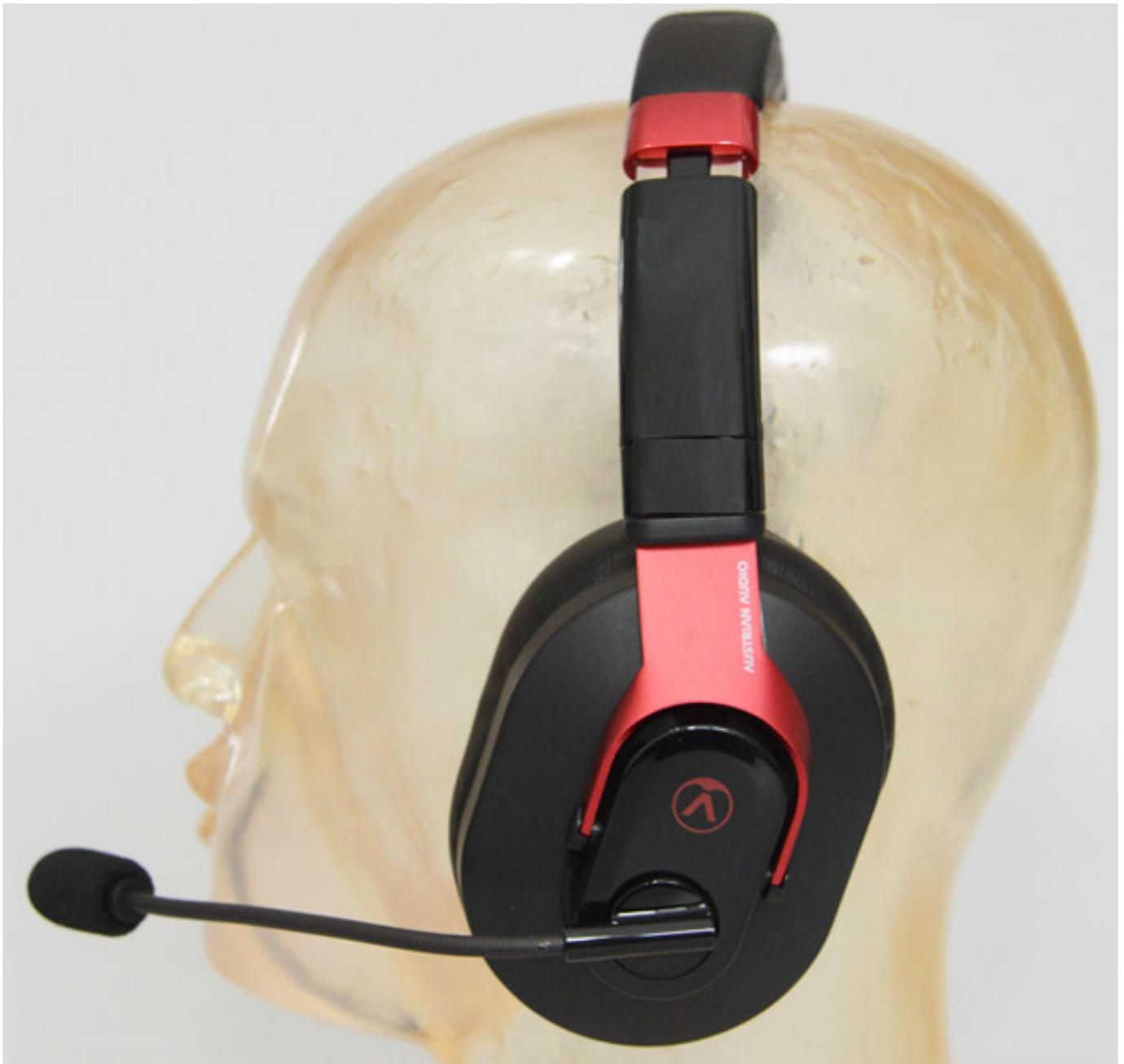
Der Ausleger dient zudem auch als Mute-Schalter. Ist er heruntergeklappt, wie in dem Foto hier oben, dann ist das Mikrofon aktiv, klappt man es hoch dann ist das Mikrofon gemutet,
