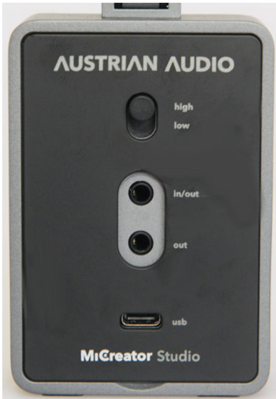
Auf der Rückseite befindet sich der USB-C-Anschluss für den Computer oder mobile Device. Das MiCreator Studio ist USB Audio Class 1.0/2.0 compliant und daher muss auch kein Treiber auf dem Aufzeichnungsgerät installiert werden. Die maximale Wortbreite des Interfaces beträgt 24 Bit bei einer maximalen Abtastrate von 48 kHz.
