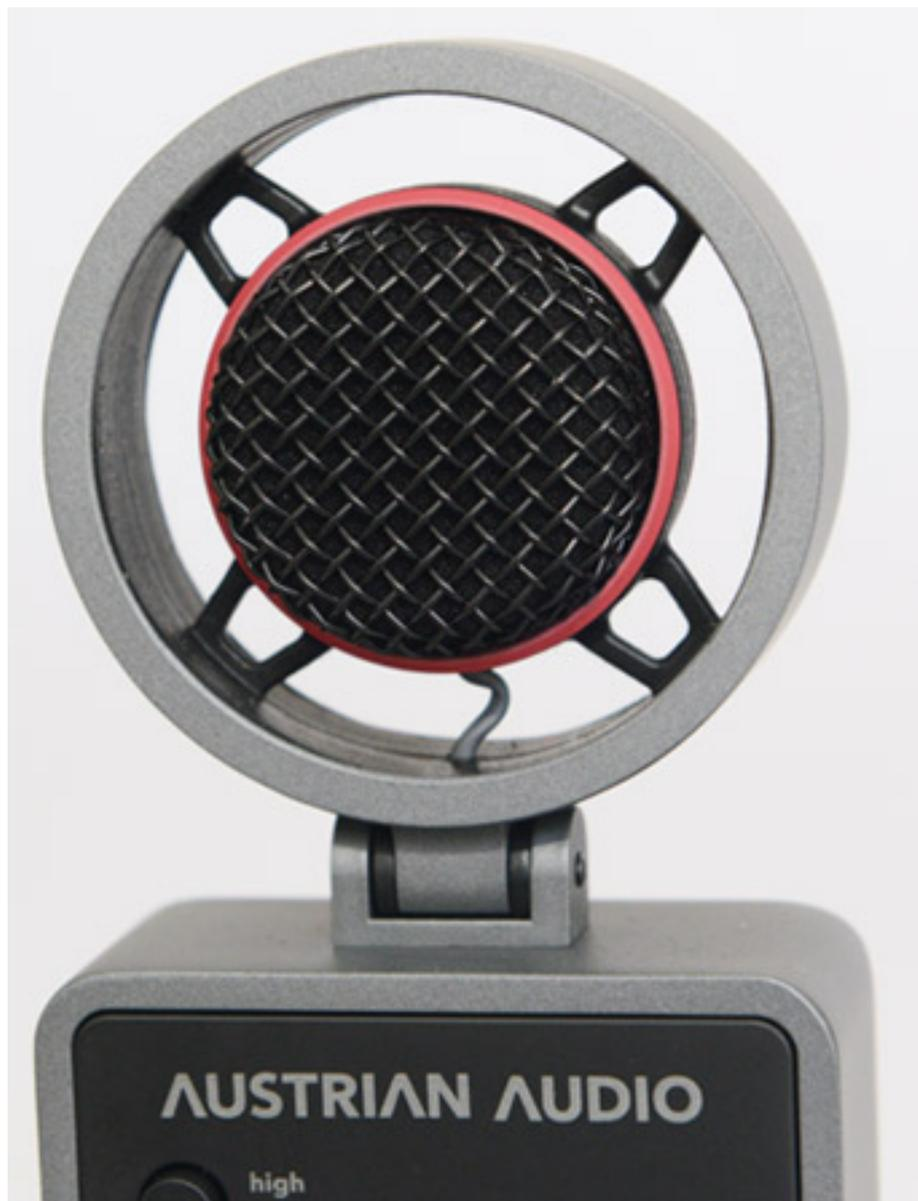
Die Mikrofonkapsel ist eine Neukonstruktion. Es handelt sich um eine Elektret-Kondensatorkapsel mit einem Kapseldurchmesser von 16 mm, Nieren-Richtcharakteristik und einem Übertragungsbereich von 20 Hz bis 20 kHz. Die Kapsel ist elastisch gelagert, wie man das von hochwertigen Studiomikrofonen her kennt und im Kapselgehäuse in Schaumstoff gebettet, um Popgeräusche zu mindern.
