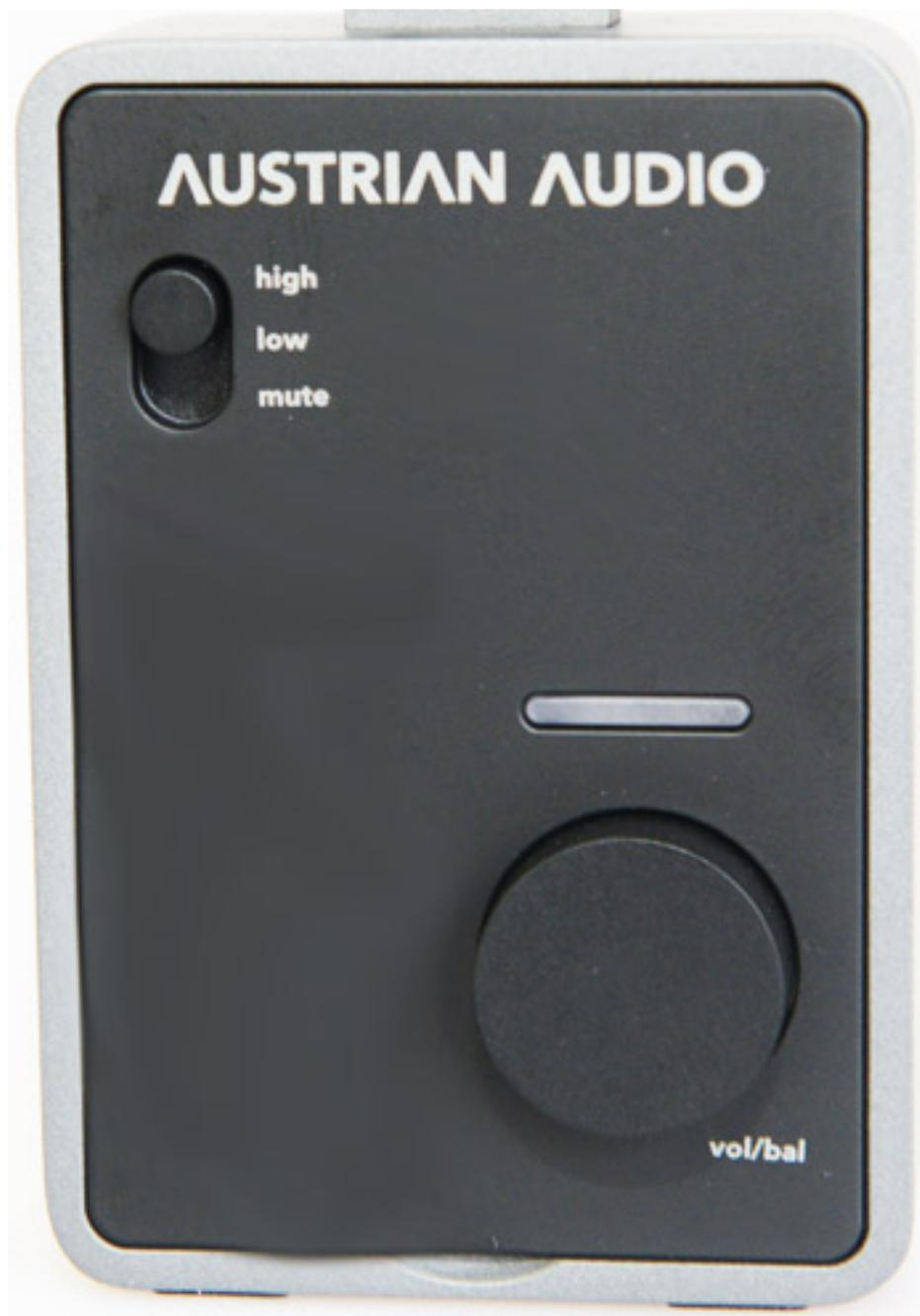
Auf der Vorderseite ist ein LED-Bargraf, ein Schalter für die Eingangsempfindlichkeit (0 dB, bzw. 20 dB Verstärkung) bzw. zum Stummschalten und ein Druck-/Drehgeber für die Monitorpegel und der Monitoring-Balance zwischen MiCreator-Studio-Mikrofon und der externen Quelle. Das Monitoring ist ein Direkt-Monitoring und somit Latenzfrei. Der maximal zulässige Schalldruck bei Low Gain beträgt 130 dB SPL. Die Empfindlichkeit beträgt -35 dBFS/Pa bzw. -15 dBFS/Pa.
