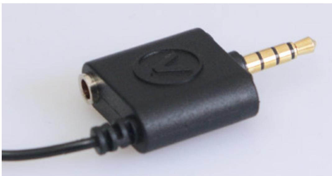
Das Anschlusskabel ist zwei Meter lang. An dem Stecker des Lavalier-Mikrofons ist eine Klinkenbuchse für den Anschluss eines Kopfhörers integriert. Mitgeliefert wird auch noch ein Textil-Transportbeutel.
