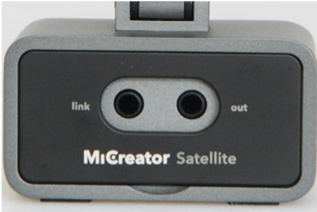
Auf der Rückseite befindet sich der Link-Anschluss für die Verbindung zum MiCreator Studio sowie der Anschluss für einen zweiten Kopfhörer (3,5 mm Klinkenbuchsen).
